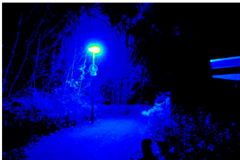
Leuchtdichteauswertung ( \text{cd}/\text{m}^2 ). Logarithmisch skaliertes Falschfarbenbild.
