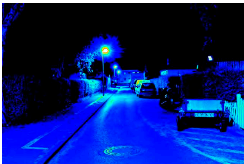
Leuchtdichteauswertung ( \text{cd}/\text{m}^2 ). Logarithmisch skaliertes Falschfarbenbild.
