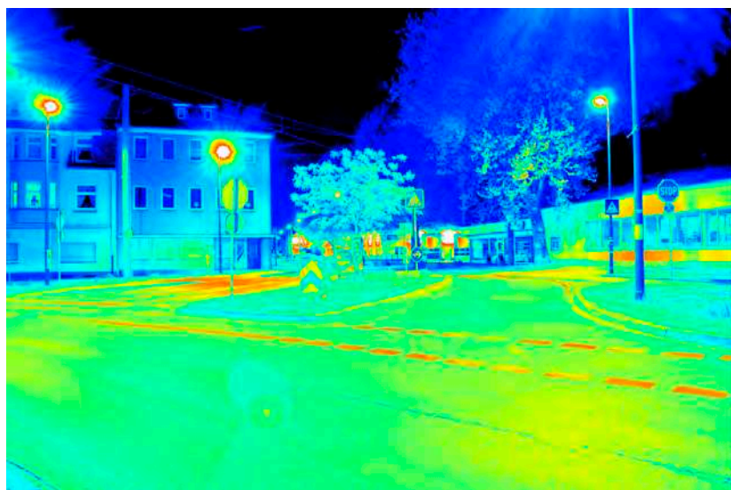
Leuchtdichteauswertung ( \text{cd}/\text{m}^2 ). Logarithmisch skaliertes Falschfarbenbild.
