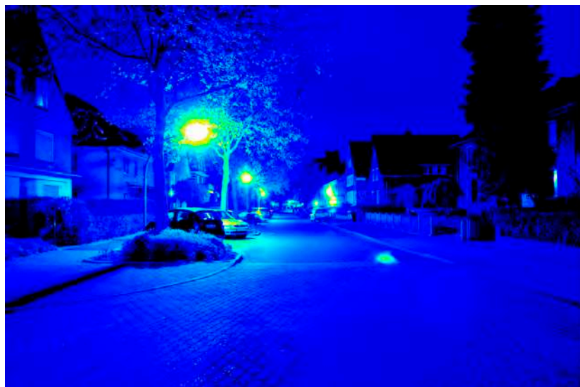
Leuchtdichteauswertung ( \text{cd}/\text{m}^2 ). Logarithmisch skaliertes Falschfarbenbild.
