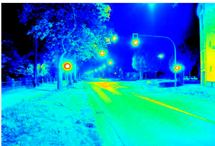
Leuchtdichteauswertung ( \text{cd}/\text{m}^2 ). Logarithmisch skaliertes Falschfarbenbild.
