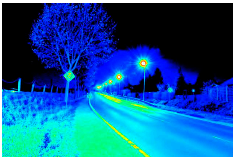
Leuchtdichteauswertung ( \text{cd/m}^2 ). Logarithmisch skaliertes Falschfarbenbild.
