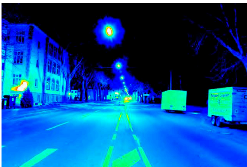
Leuchtdichteauswertung ( \text{cd}/\text{m}^2 ). Logarithmisch skaliertes Falschfarbenbild.
