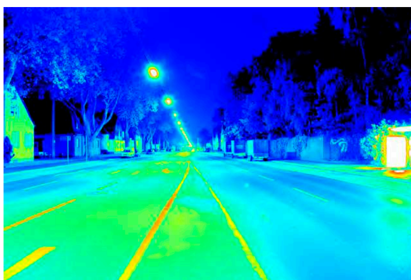
Leuchtdichteauswertung ( \text{cd}/\text{m}^2 ). Logarithmisch skaliertes Falschfarbenbild.
