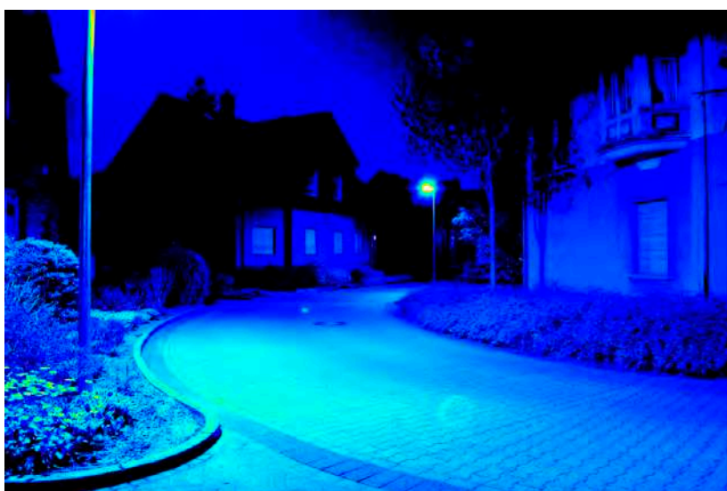
Leuchtdichteauswertung ( \text{cd}/\text{m}^2 ). Logarithmisch skaliertes Falschfarbenbild.
