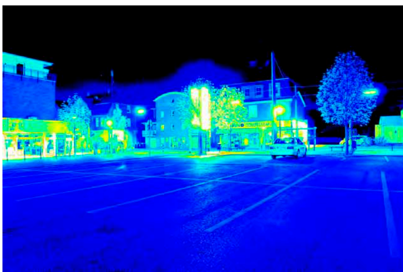
Leuchtdichteauswertung (cd/m 2 ). Logarithmisch skaliertes Falschfarbenbild.
