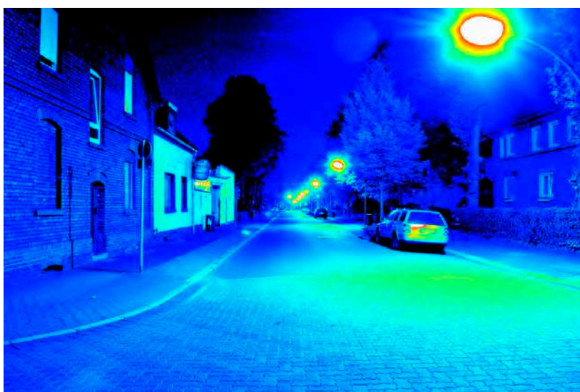
Leuchtdichteauswertung ( \text{cd}/\text{m}^2 ). Logarithmisch skaliertes Falschfarbenbild.
