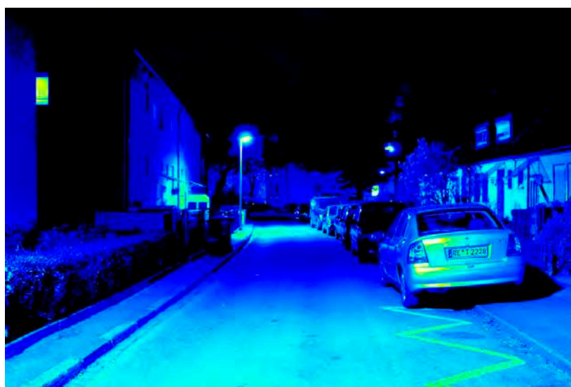
Leuchtdichteauswertung ( \text{cd/m}^2 ). Logarithmisch skaliertes Falschfarbenbild.
