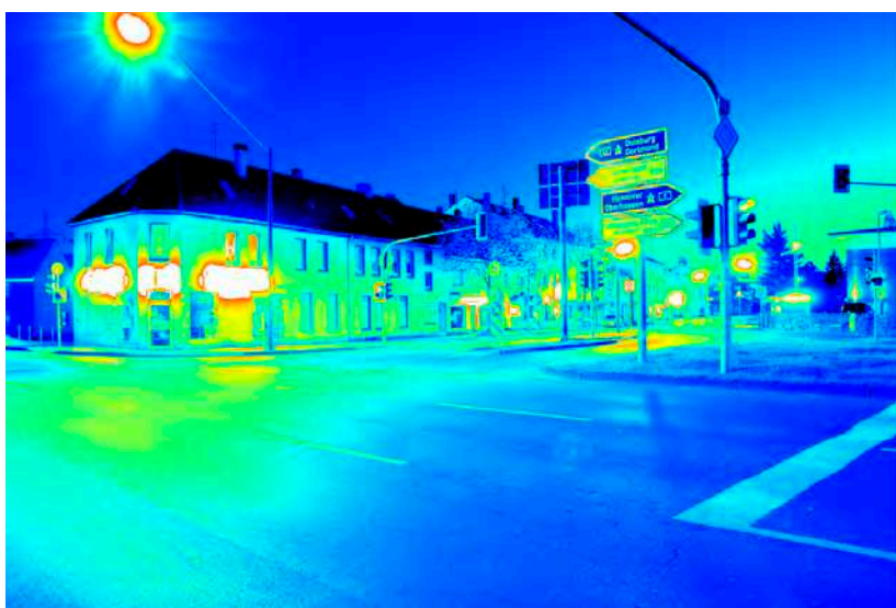
Leuchtdichteauswertung ( \text{cd}/\text{m}^2 ). Logarithmisch skaliertes Falschfarbenbild.
