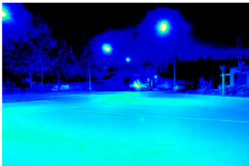
Leuchtdichteauswertung (cd/m 2 ). Logarithmisch skaliertes Falschfarbenbild.
