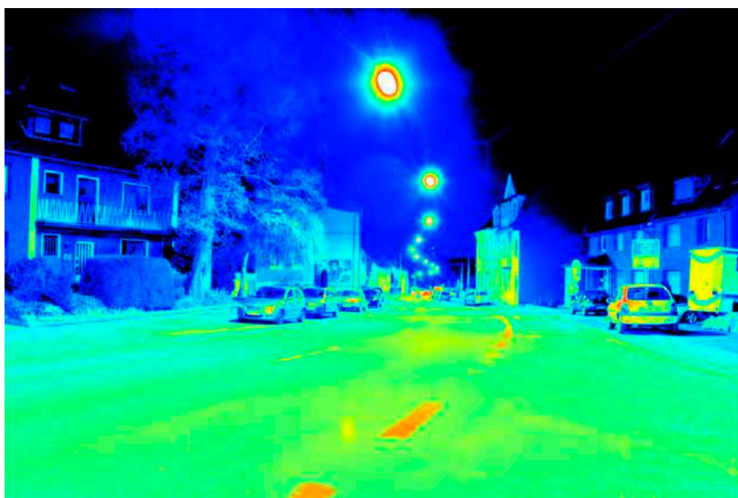
Leuchtdichteauswertung ( \text{cd/m}^2 ). Logarithmisch skaliertes Falschfarbenbild.
