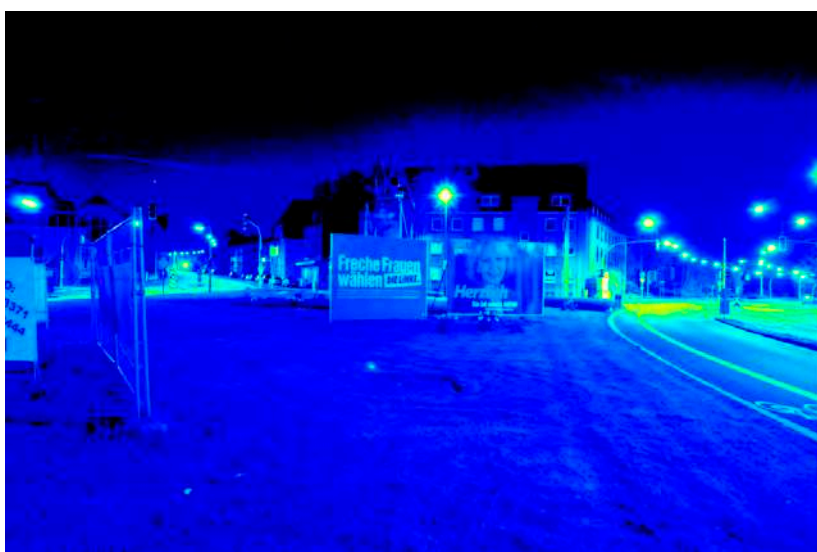
Leuchtdichteauswertung ( \text{cd/m}^2 ). Logarithmisch skaliertes Falschfarbenbild.
