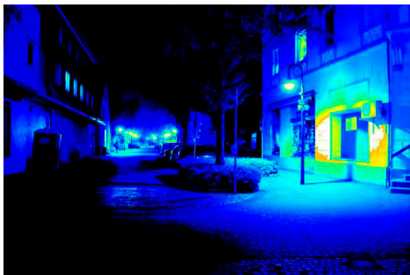
Leuchtdichteauswertung ( \text{cd}/\text{m}^2 ). Logarithmisch skaliertes Falschfarbenbild.
