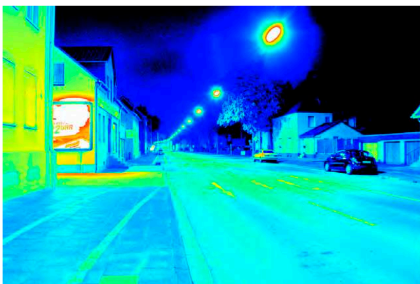
Leuchtdichteauswertung ( \text{cd}/\text{m}^2 ). Logarithmisch skaliertes Falschfarbenbild.
