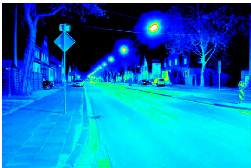
Leuchtdichteauswertung ( \text{cd}/\text{m}^2 ). Logarithmisch skaliertes Falschfarbenbild.
