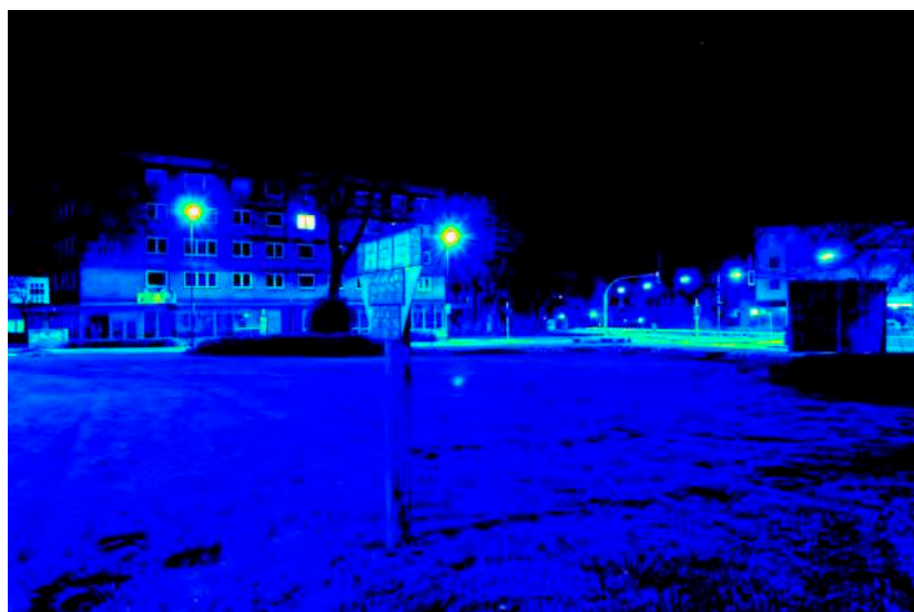
Leuchtdichteauswertung ( \text{cd}/\text{m}^2 ). Logarithmisch skaliertes Falschfarbenbild.
