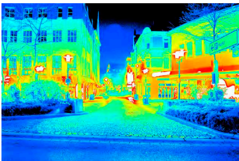
Leuchtdichteauswertung ( \text{cd}/\text{m}^2 ). Logarithmisch skaliertes Falschfarbenbild.
