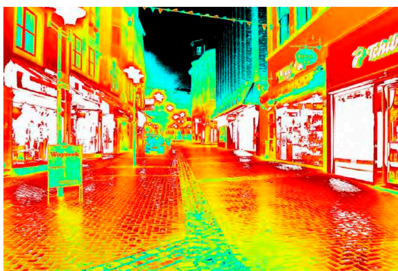
Leuchtdichteauswertung ( \text{cd}/\text{m}^2 ). Logarithmisch skaliertes Falschfarbenbild.
