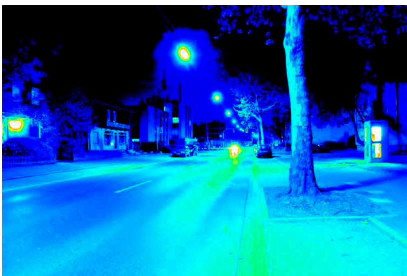
Leuchtdichteauswertung ( \text{cd}/\text{m}^2 ). Logarithmisch skaliertes Falschfarbenbild.
