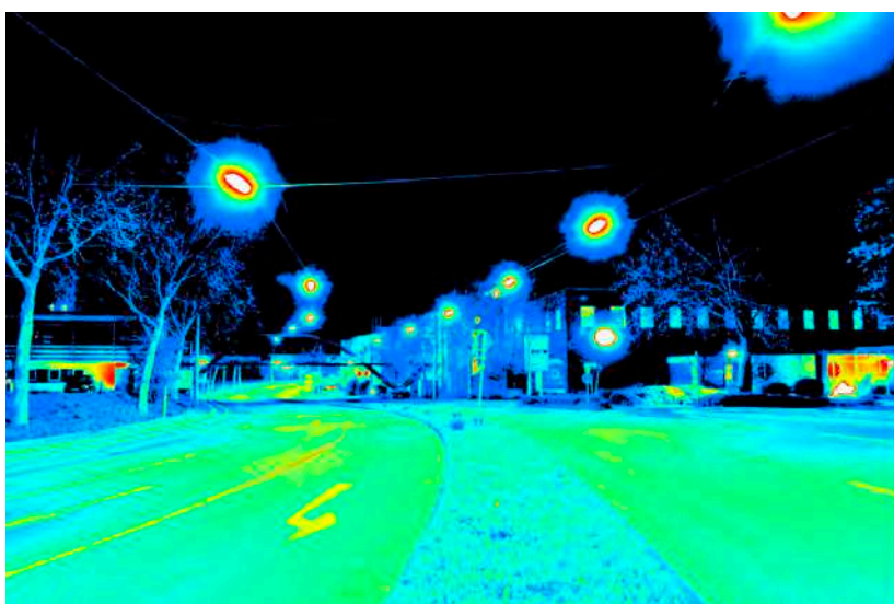
Leuchtdichteauswertung ( \text{cd}/\text{m}^2 ). Logarithmisch skaliertes Falschfarbenbild.
