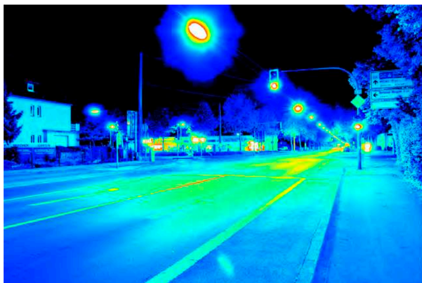
Leuchtdichteauswertung ( \text{cd/m}^2 ). Logarithmisch skaliertes Falschfarbenbild.
