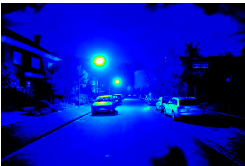
Leuchtdichteauswertung (cd/m 2 ). Logarithmisch skaliertes Falschfarbenbild.
