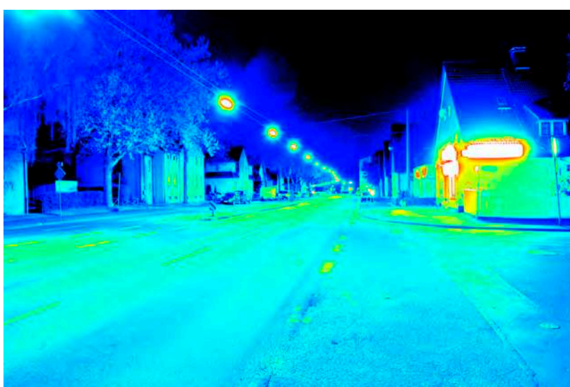
Leuchtdichteauswertung ( \text{cd}/\text{m}^2 ). Logarithmisch skaliertes Falschfarbenbild.
