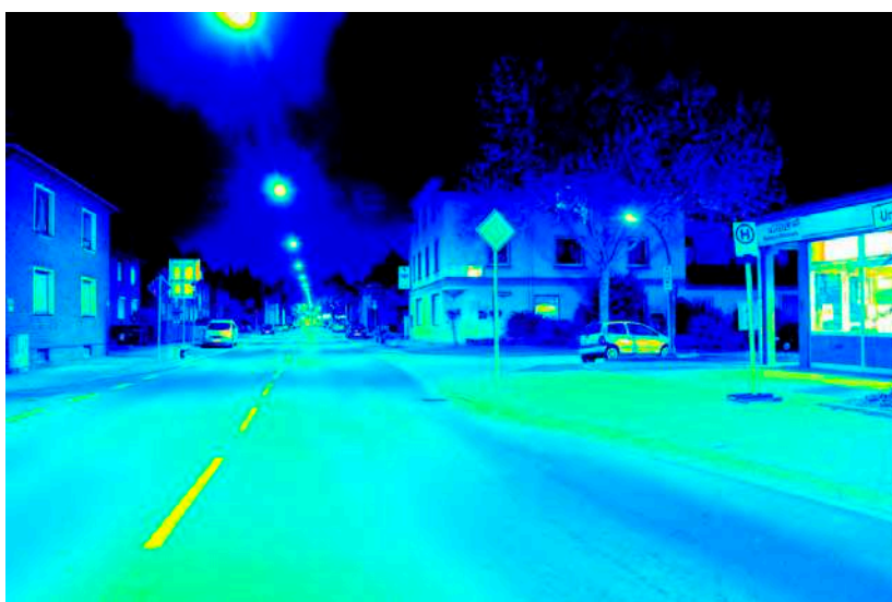
Leuchtdichteauswertung ( \text{cd}/\text{m}^2 ). Logarithmisch skaliertes Falschfarbenbild.
