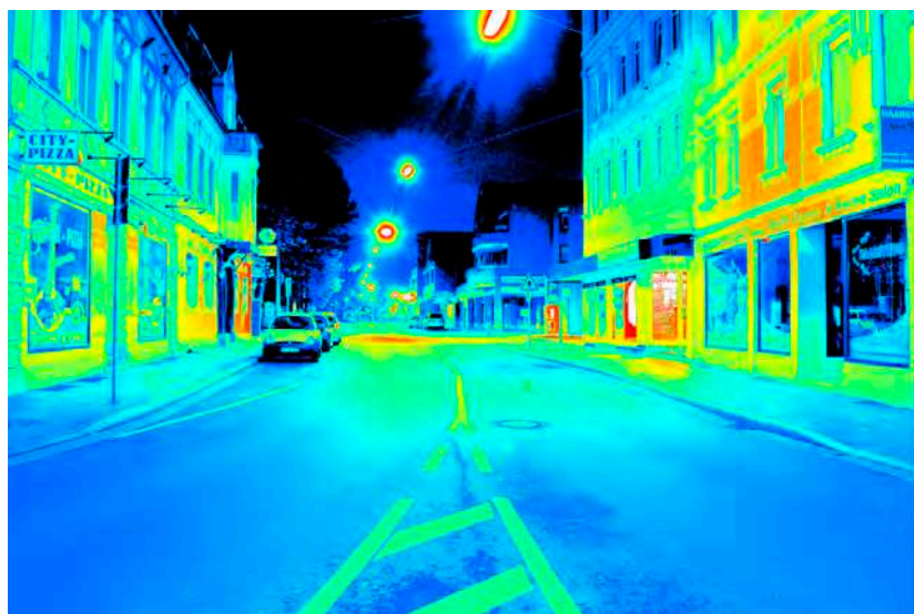
Leuchtdichteauswertung ( \text{cd/m}^2 ). Logarithmisch skaliertes Falschfarbenbild.
