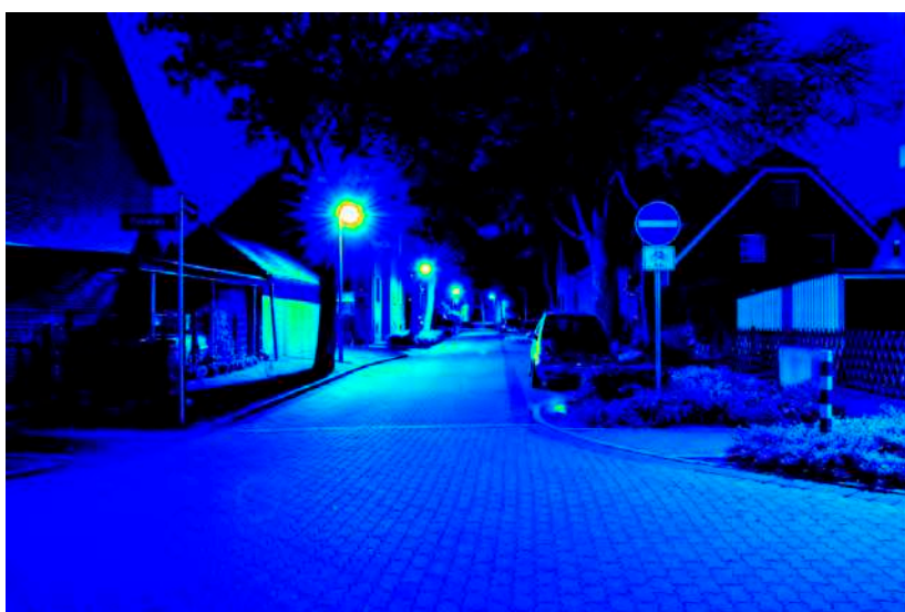
Leuchtdichteauswertung ( \text{cd}/\text{m}^2 ). Logarithmisch skaliertes Falschfarbenbild.
