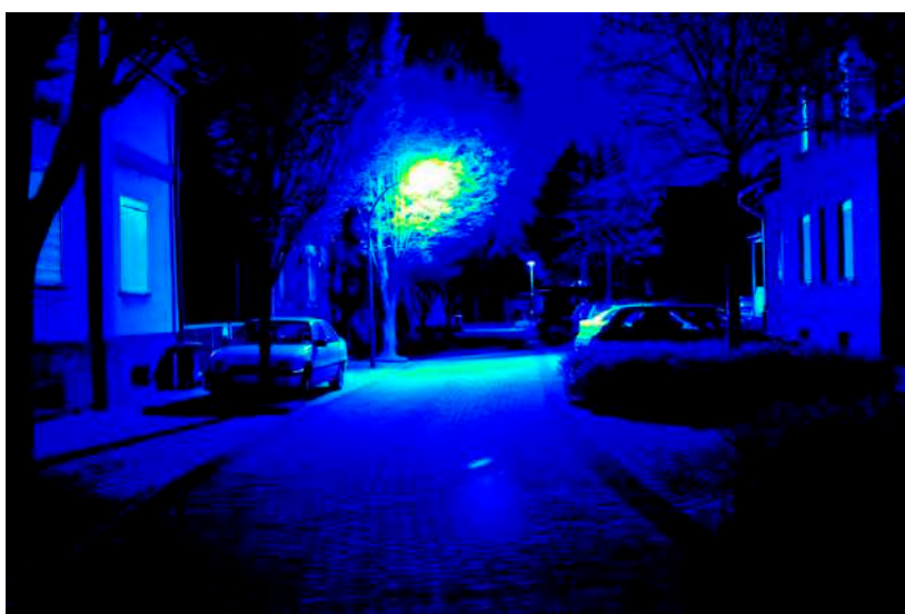
Leuchtdichteauswertung (cd/m 2 ). Logarithmisch skaliertes Falschfarbenbild.
