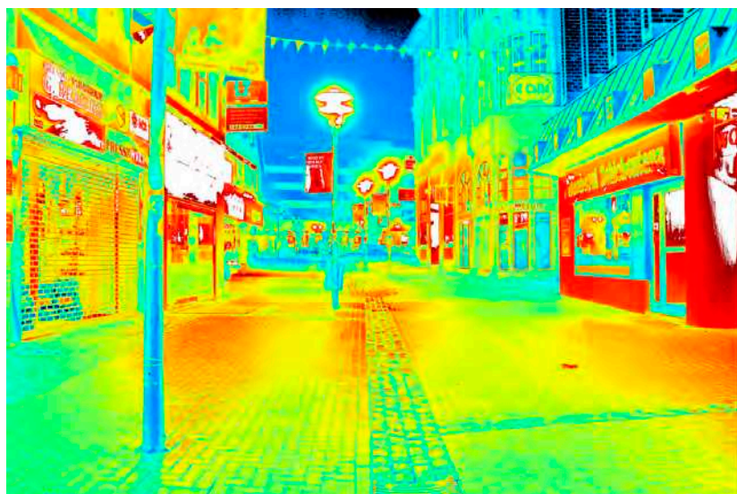
Leuchtdichteauswertung ( \text{cd}/\text{m}^2 ). Logarithmisch skaliertes Falschfarbenbild.
