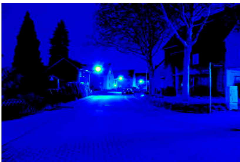
Leuchtdichteauswertung ( \text{cd}/\text{m}^2 ). Logarithmisch skaliertes Falschfarbenbild.
