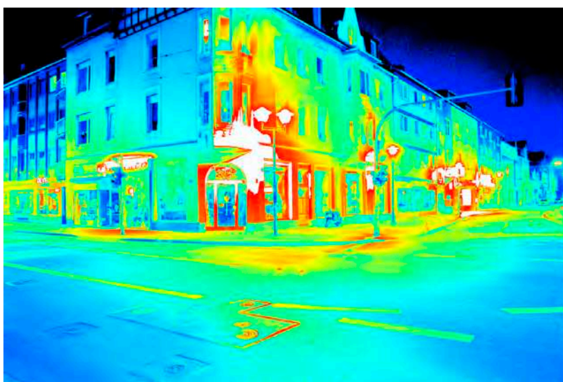
Leuchtdichteauswertung ( \text{cd}/\text{m}^2 ). Logarithmisch skaliertes Falschfarbenbild.
