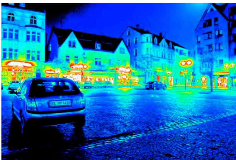
Leuchtdichteauswertung ( \text{cd}/\text{m}^2 ). Logarithmisch skaliertes Falschfarbenbild.
