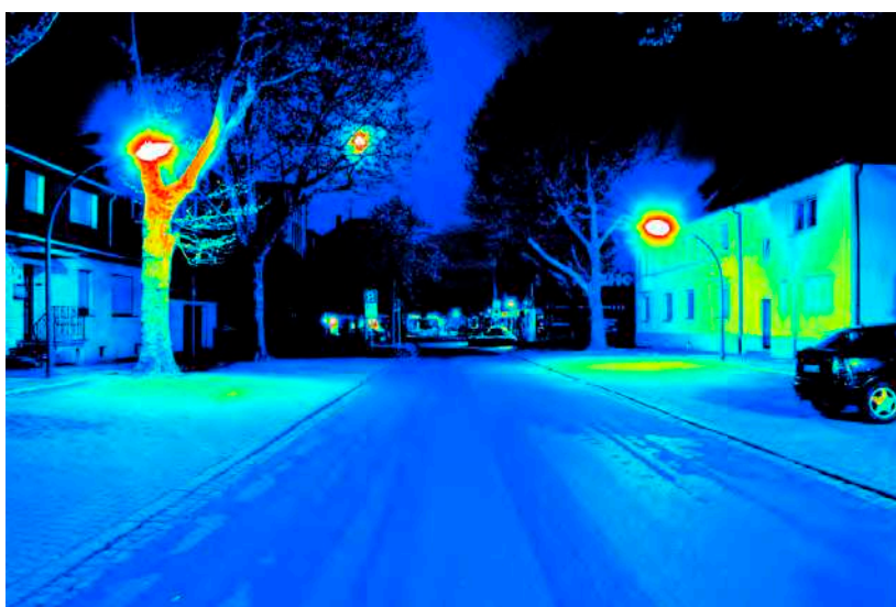
Leuchtdichteauswertung ( \text{cd}/\text{m}^2 ). Logarithmisch skaliertes Falschfarbenbild.
