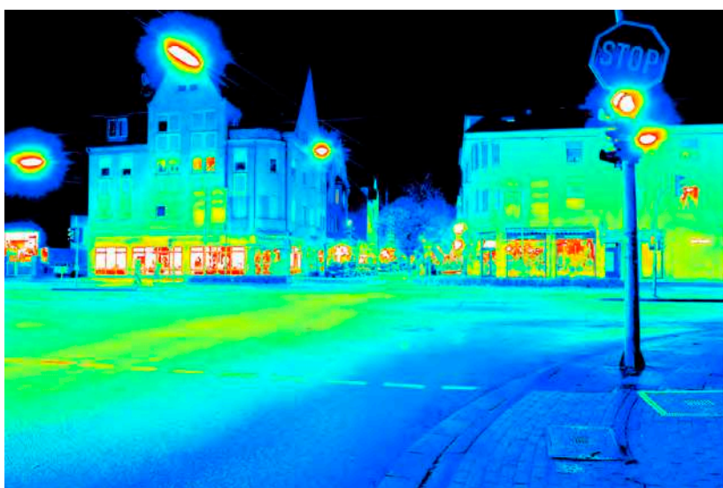
Leuchtdichteauswertung ( \text{cd/m}^2 ). Logarithmisch skaliertes Falschfarbenbild.
