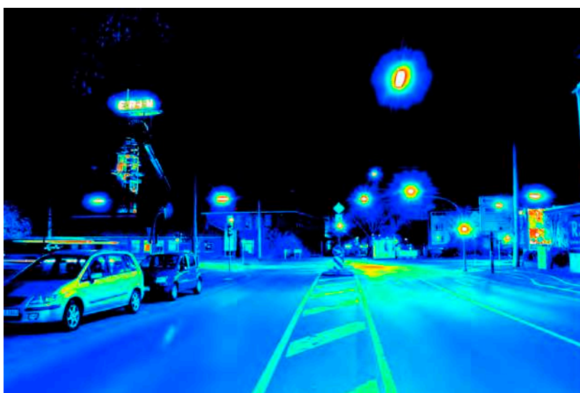
Leuchtdichteauswertung ( \text{cd}/\text{m}^2 ). Logarithmisch skaliertes Falschfarbenbild.
