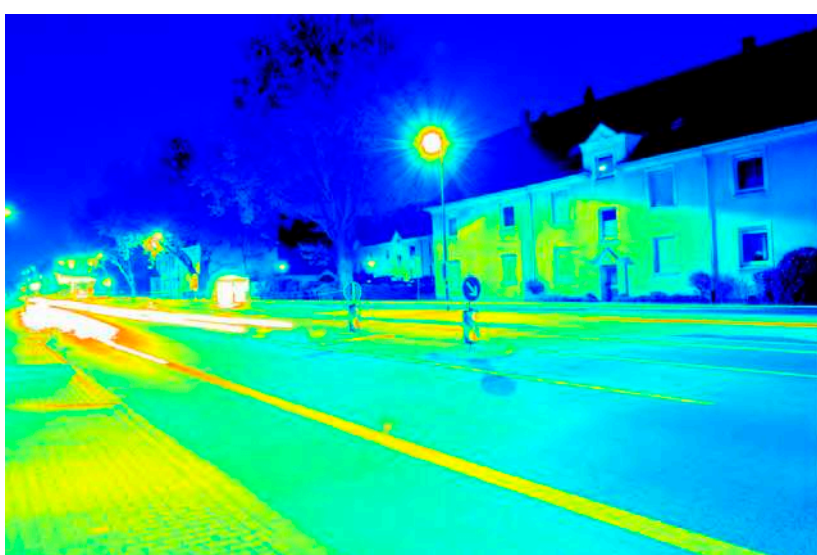
Leuchtdichteauswertung ( \text{cd}/\text{m}^2 ). Logarithmisch skaliertes Falschfarbenbild.
