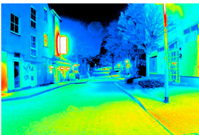
Leuchtdichteauswertung ( \text{cd}/\text{m}^2 ). Logarithmisch skaliertes Falschfarbenbild.
