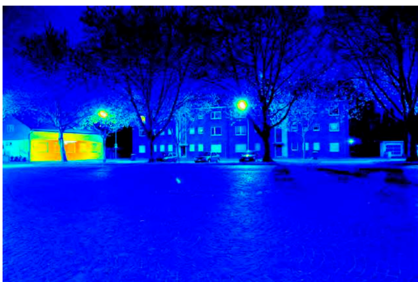
Leuchtdichteauswertung (cd/m 2 ). Logarithmisch skaliertes Falschfarbenbild.
