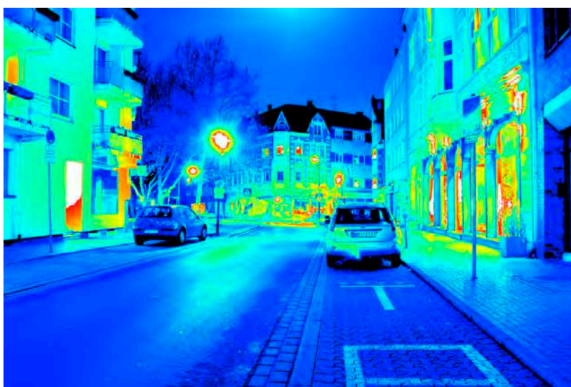
Leuchtdichteauswertung ( \text{cd/m}^2 ). Logarithmisch skaliertes Falschfarbenbild.
