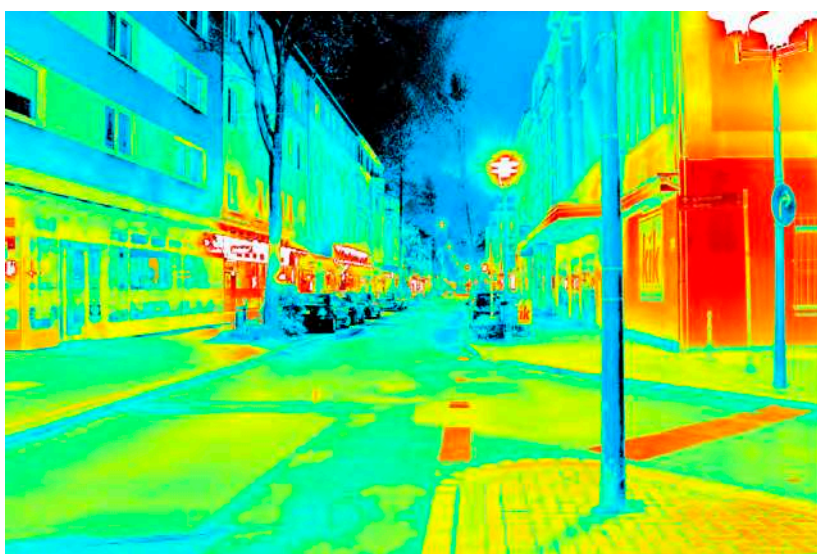
Leuchtdichteauswertung ( \text{cd}/\text{m}^2 ). Logarithmisch skaliertes Falschfarbenbild.
