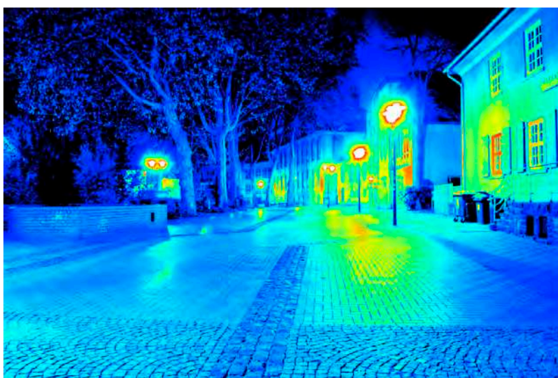
Leuchtdichteauswertung ( \text{cd}/\text{m}^2 ). Logarithmisch skaliertes Falschfarbenbild.
