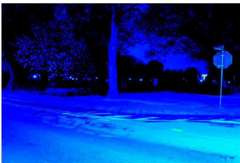
Leuchtdichteauswertung (cd/m 2 ). Logarithmisch skaliertes Falschfarbenbild.
