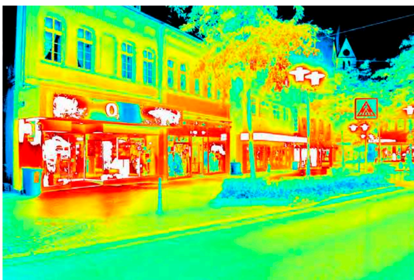
Leuchtdichteauswertung (cd/m 2 ). Logarithmisch skaliertes Falschfarbenbild.
