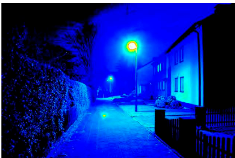
Leuchtdichteauswertung ( \text{cd}/\text{m}^2 ). Logarithmisch skaliertes Falschfarbenbild.
