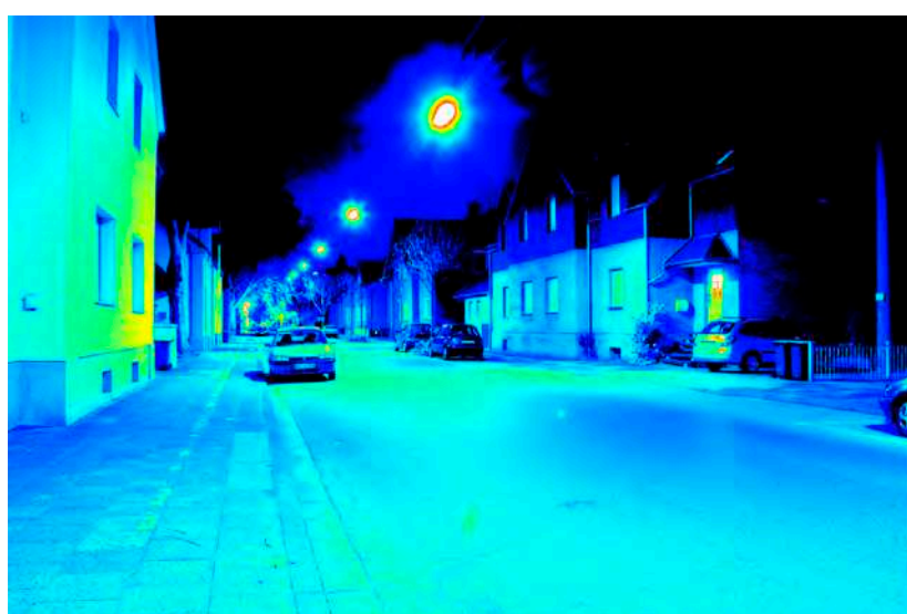
Leuchtdichteauswertung ( \text{cd}/\text{m}^2 ). Logarithmisch skaliertes Falschfarbenbild.
