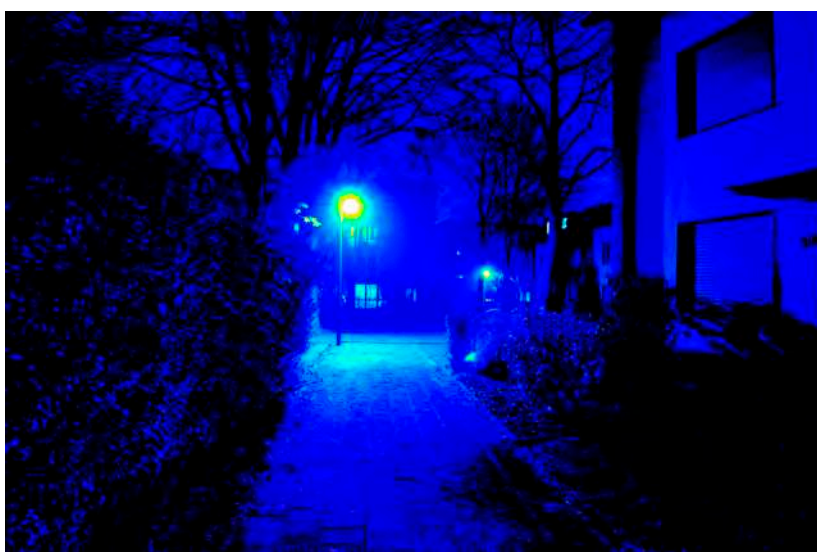
Leuchtdichteauswertung ( \text{cd}/\text{m}^2 ). Logarithmisch skaliertes Falschfarbenbild.
