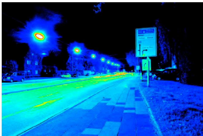
Leuchtdichteauswertung (cd/m 2 ). Logarithmisch skaliertes Falschfarbenbild.
