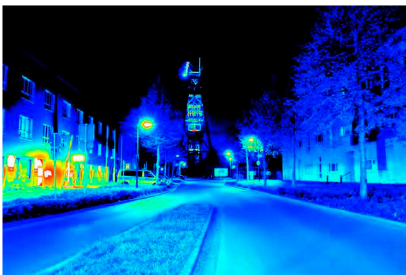
Leuchtdichteauswertung ( \text{cd/m}^2 ). Logarithmisch skaliertes Falschfarbenbild.
