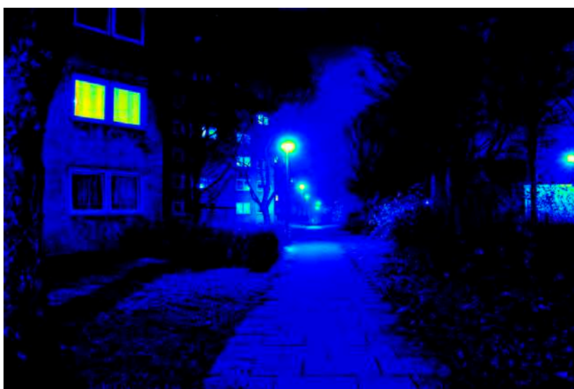
Leuchtdichteauswertung ( \text{cd}/\text{m}^2 ). Logarithmisch skaliertes Falschfarbenbild.
