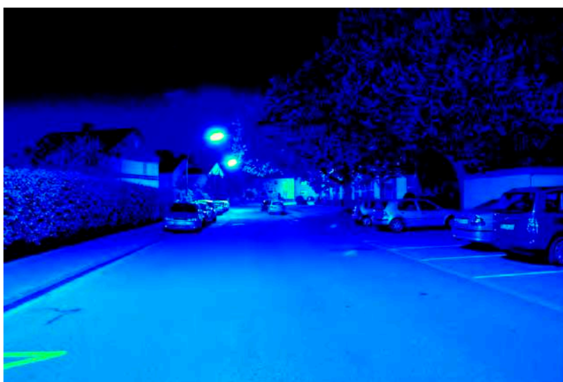
Leuchtdichteauswertung ( \text{cd/m}^2 ). Logarithmisch skaliertes Falschfarbenbild.
