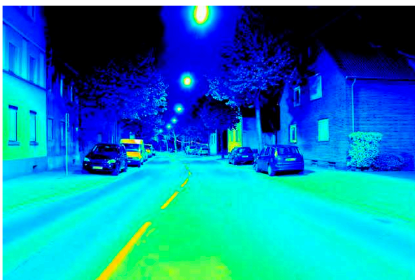
Leuchtdichteauswertung ( \text{cd}/\text{m}^2 ). Logarithmisch skaliertes Falschfarbenbild.
