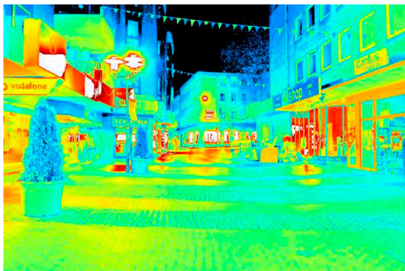
Leuchtdichteauswertung ( \text{cd}/\text{m}^2 ). Logarithmisch skaliertes Falschfarbenbild.
