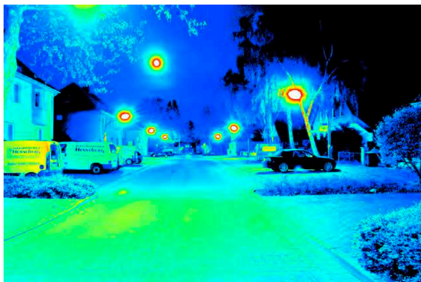
Leuchtdichteauswertung ( \text{cd}/\text{m}^2 ). Logarithmisch skaliertes Falschfarbenbild.
