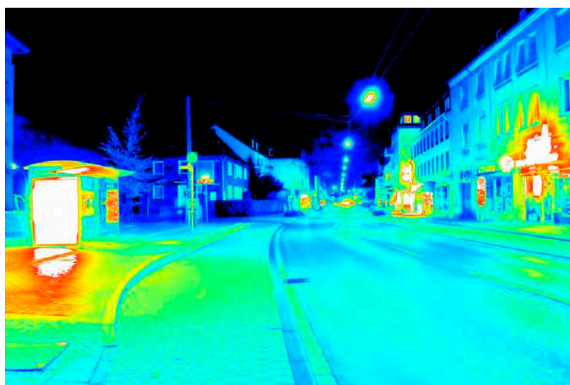
Leuchtdichteauswertung ( \text{cd/m}^2 ). Logarithmisch skaliertes Falschfarbenbild.
