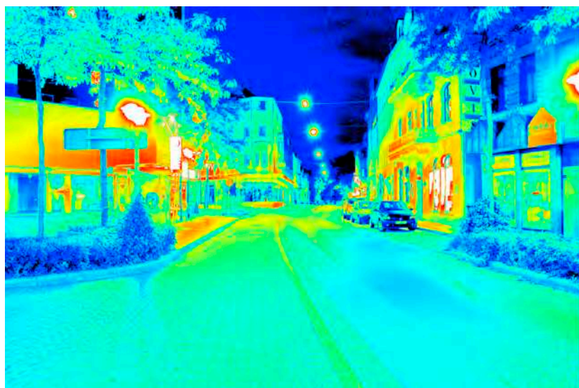
Leuchtdichteauswertung ( \text{cd}/\text{m}^2 ). Logarithmisch skaliertes Falschfarbenbild.
