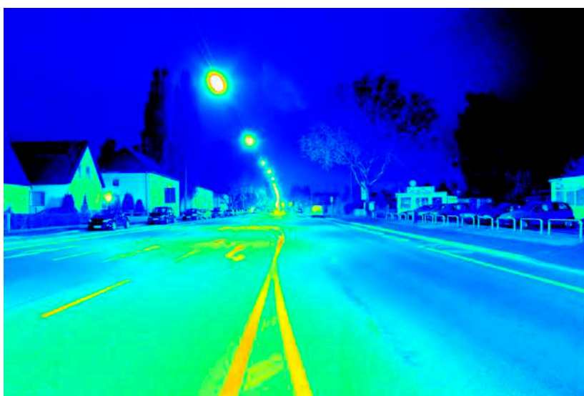
Leuchtdichteauswertung ( \text{cd/m}^2 ). Logarithmisch skaliertes Falschfarbenbild.
