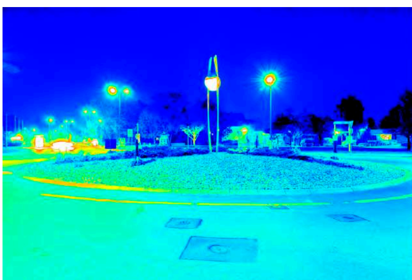
Leuchtdichteauswertung (cd/m 2 ). Logarithmisch skaliertes Falschfarbenbild.
