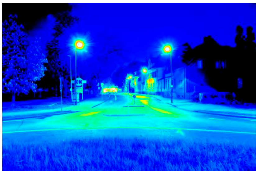
Leuchtdichteauswertung ( \text{cd}/\text{m}^2 ). Logarithmisch skaliertes Falschfarbenbild.
