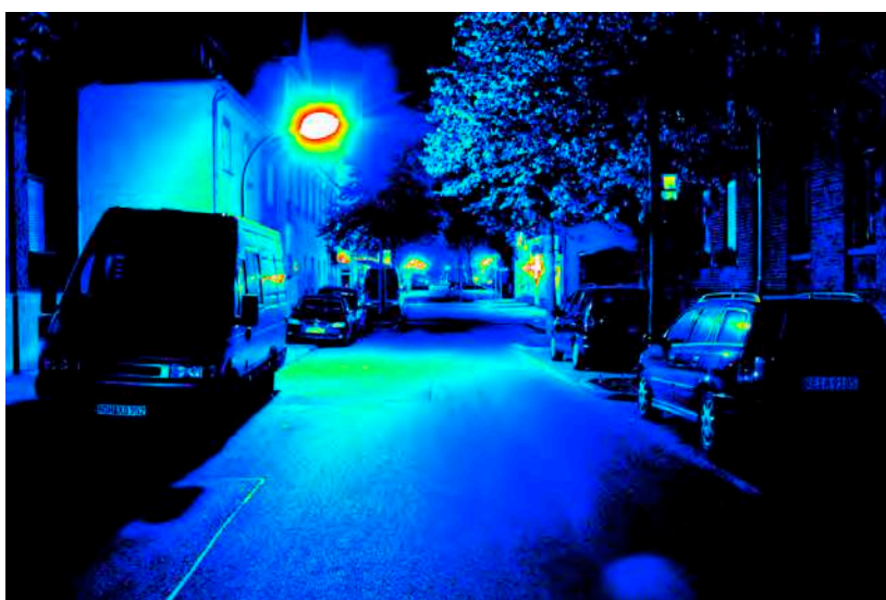
Leuchtdichteauswertung ( \text{cd/m}^2 ). Logarithmisch skaliertes Falschfarbenbild.
