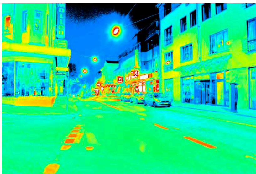
Leuchtdichteauswertung ( \text{cd}/\text{m}^2 ). Logarithmisch skaliertes Falschfarbenbild.
