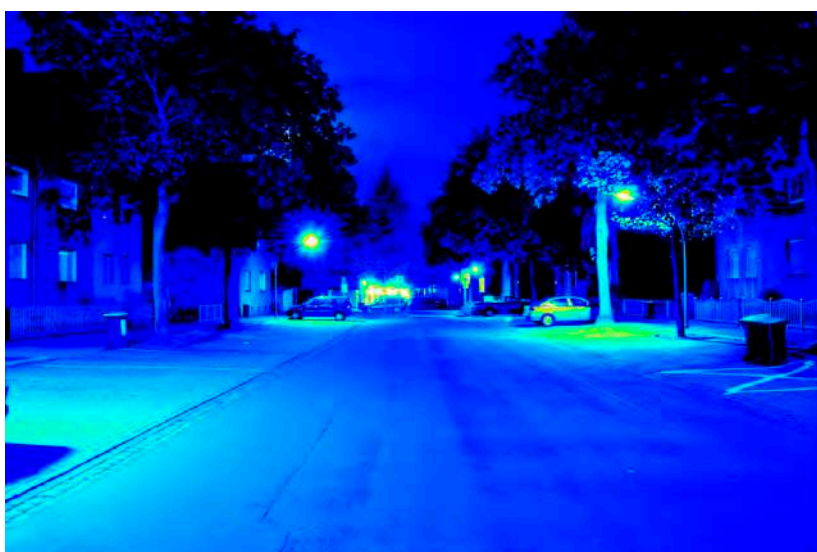
Leuchtdichteauswertung ( \text{cd}/\text{m}^2 ). Logarithmisch skaliertes Falschfarbenbild.
