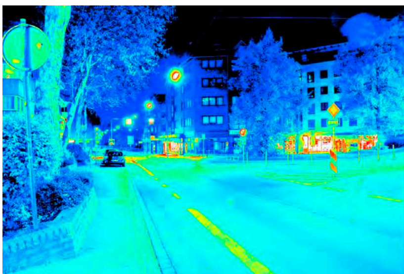
Leuchtdichteauswertung ( \text{cd}/\text{m}^2 ). Logarithmisch skaliertes Falschfarbenbild.
