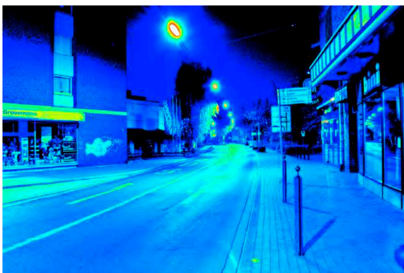
Leuchtdichteauswertung ( \text{cd}/\text{m}^2 ). Logarithmisch skaliertes Falschfarbenbild.
