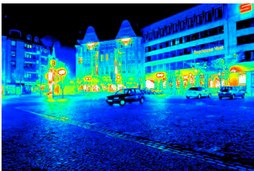
Leuchtdichteauswertung ( \text{cd}/\text{m}^2 ). Logarithmisch skaliertes Falschfarbenbild.
