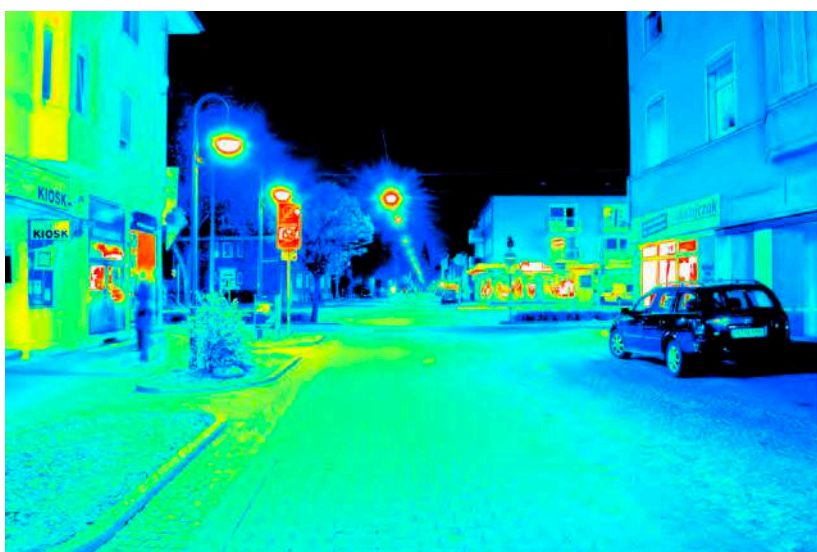
Leuchtdichteauswertung ( \text{cd}/\text{m}^2 ). Logarithmisch skaliertes Falschfarbenbild.
