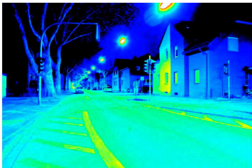
Leuchtdichteauswertung ( \text{cd/m}^2 ). Logarithmisch skaliertes Falschfarbenbild.
