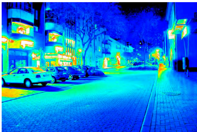
Leuchtdichteauswertung ( \text{cd}/\text{m}^2 ). Logarithmisch skaliertes Falschfarbenbild.
