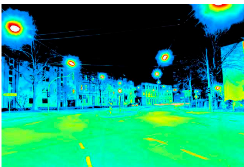
Leuchtdichteauswertung ( \text{cd}/\text{m}^2 ). Logarithmisch skaliertes Falschfarbenbild.
