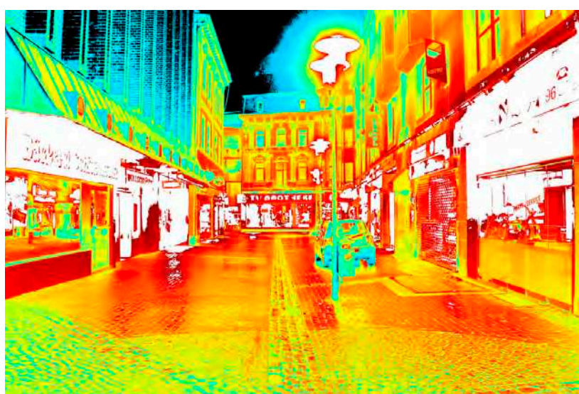
Leuchtdichteauswertung ( \text{cd}/\text{m}^2 ). Logarithmisch skaliertes Falschfarbenbild.
