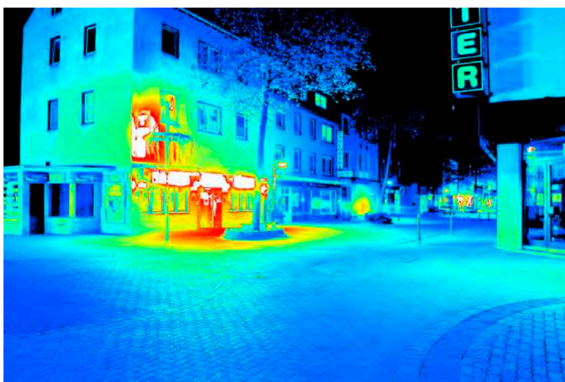
Leuchtdichteauswertung (cd/m 2 ). Logarithmisch skaliertes Falschfarbenbild.
