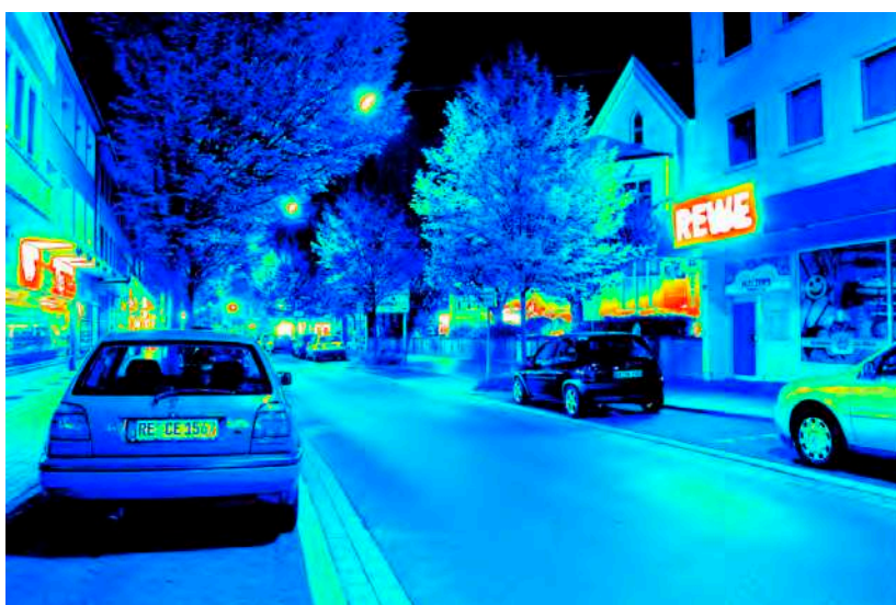
Leuchtdichteauswertung ( \text{cd}/\text{m}^2 ). Logarithmisch skaliertes Falschfarbenbild.
