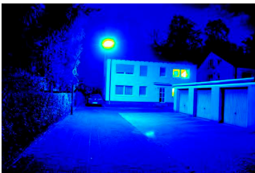
Leuchtdichteauswertung ( \text{cd}/\text{m}^2 ). Logarithmisch skaliertes Falschfarbenbild.
