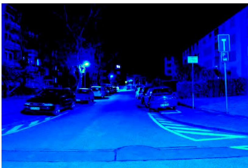
Leuchtdichteauswertung ( \text{cd}/\text{m}^2 ). Logarithmisch skaliertes Falschfarbenbild.
