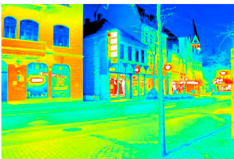
Leuchtdichteauswertung ( \text{cd}/\text{m}^2 ). Logarithmisch skaliertes Falschfarbenbild.
