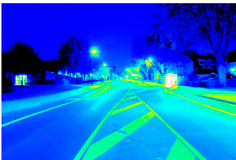
Leuchtdichteauswertung (cd/m 2 ). Logarithmisch skaliertes Falschfarbenbild.
