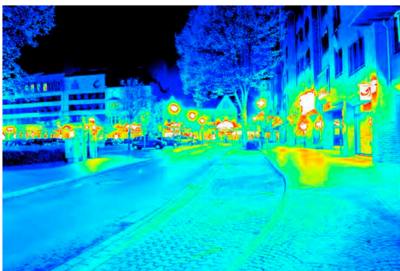
Leuchtdichteauswertung ( \text{cd/m}^2 ). Logarithmisch skaliertes Falschfarbenbild.
