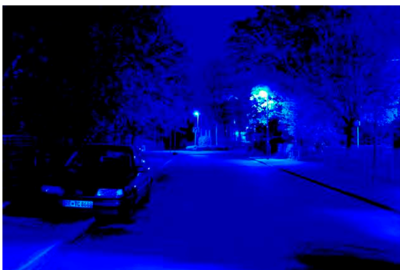
Leuchtdichteauswertung ( \text{cd}/\text{m}^2 ). Logarithmisch skaliertes Falschfarbenbild.
