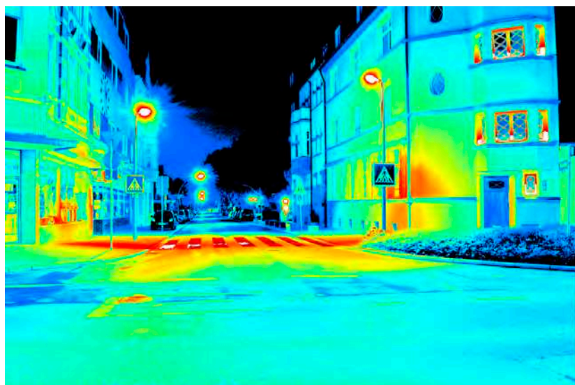
Leuchtdichteauswertung ( \text{cd/m}^2 ). Logarithmisch skaliertes Falschfarbenbild.
