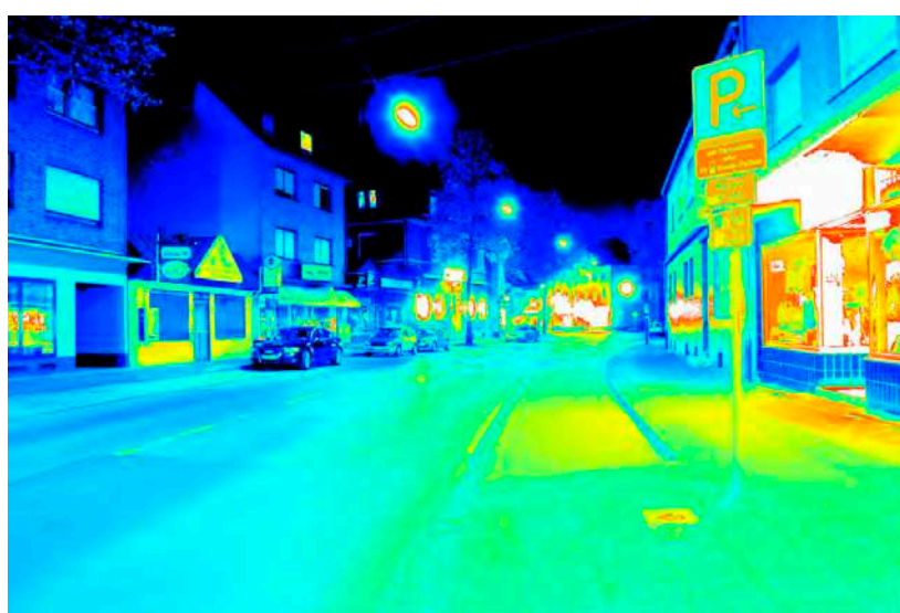
Leuchtdichteauswertung ( \text{cd}/\text{m}^2 ). Logarithmisch skaliertes Falschfarbenbild.
