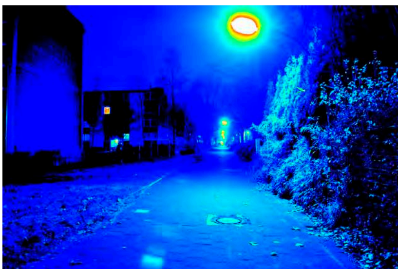
Leuchtdichteauswertung ( \text{cd}/\text{m}^2 ). Logarithmisch skaliertes Falschfarbenbild.
