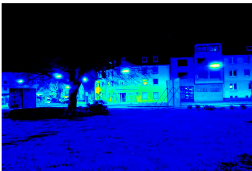
Leuchtdichteauswertung ( \text{cd}/\text{m}^2 ). Logarithmisch skaliertes Falschfarbenbild.
