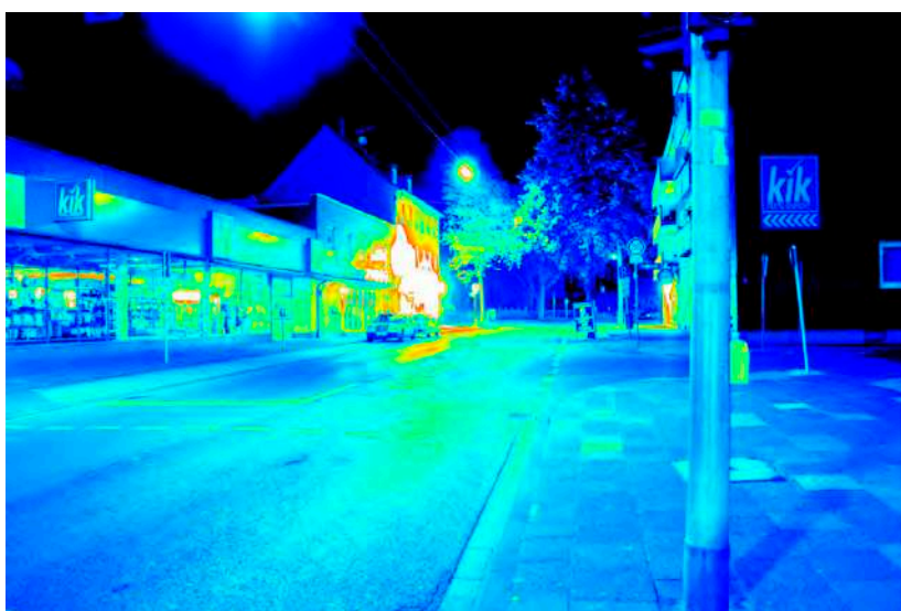
Leuchtdichteauswertung (cd/m 2 ). Logarithmisch skaliertes Falschfarbenbild.
