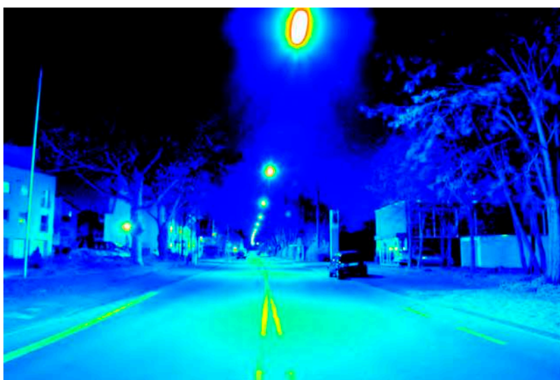
Leuchtdichteauswertung (cd/m 2 ). Logarithmisch skaliertes Falschfarbenbild.
