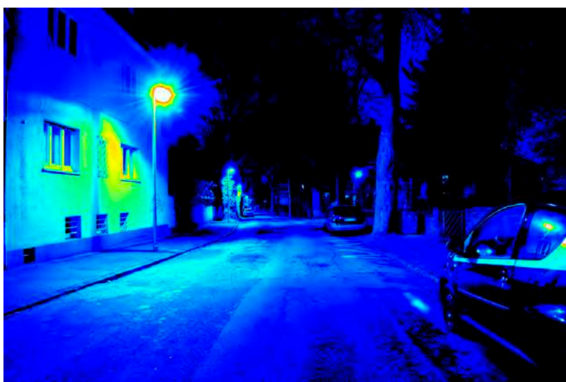
Leuchtdichteauswertung ( \text{cd}/\text{m}^2 ). Logarithmisch skaliertes Falschfarbenbild.
