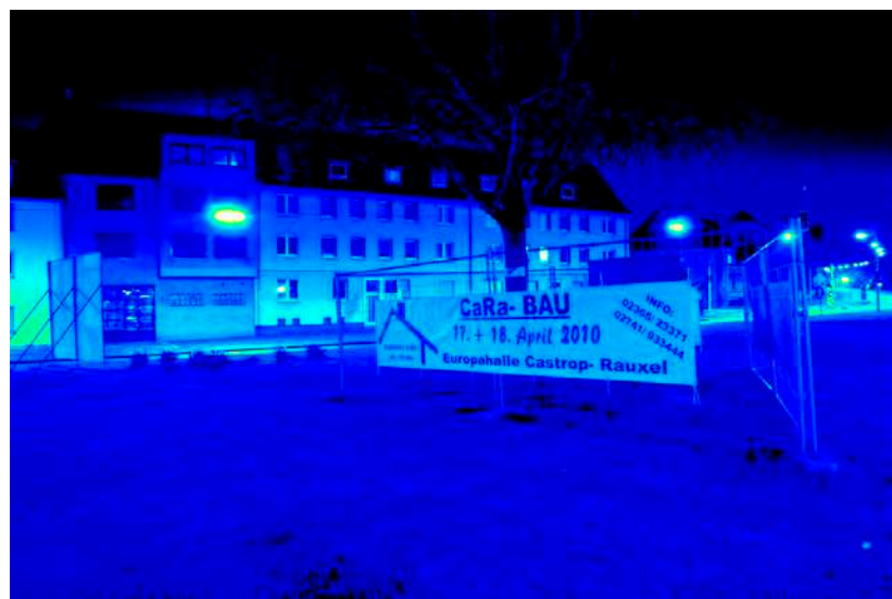
Leuchtdichteauswertung ( \text{cd}/\text{m}^2 ). Logarithmisch skaliertes Falschfarbenbild.
