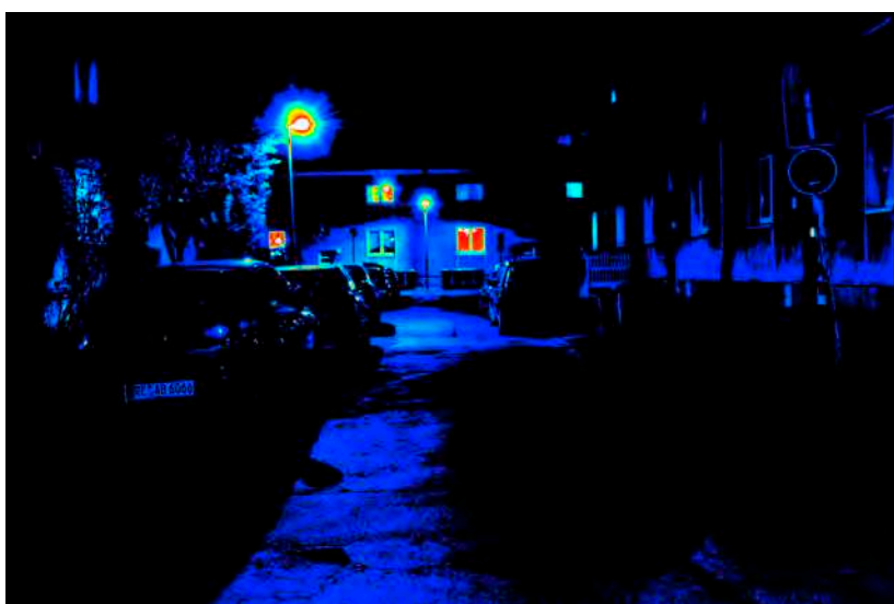
Leuchtdichteauswertung ( \text{cd}/\text{m}^2 ). Logarithmisch skaliertes Falschfarbenbild.
