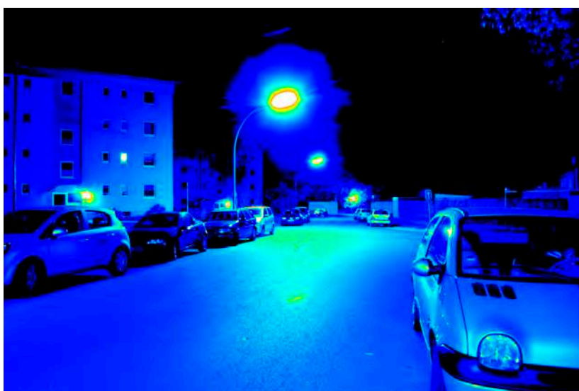
Leuchtdichteauswertung ( \text{cd}/\text{m}^2 ). Logarithmisch skaliertes Falschfarbenbild.
