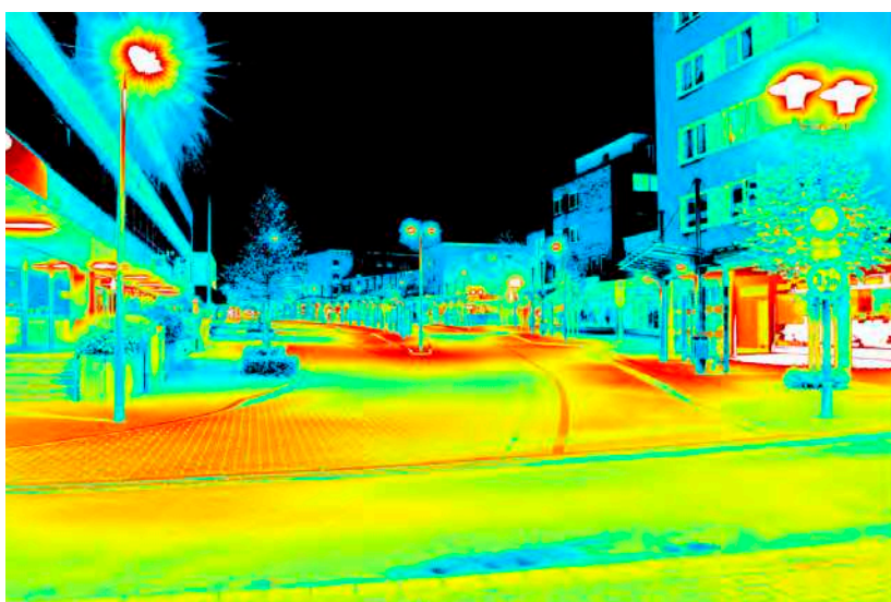
Leuchtdichteauswertung ( \text{cd}/\text{m}^2 ). Logarithmisch skaliertes Falschfarbenbild.
