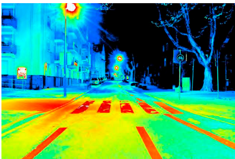
Leuchtdichteauswertung ( \text{cd}/\text{m}^2 ). Logarithmisch skaliertes Falschfarbenbild.
