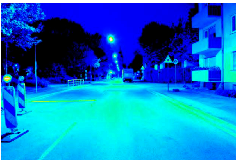
Leuchtdichteauswertung ( \text{cd}/\text{m}^2 ). Logarithmisch skaliertes Falschfarbenbild.
