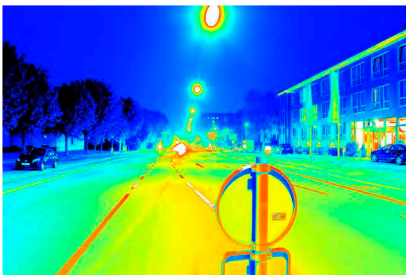
Leuchtdichteauswertung (cd/m 2 ). Logarithmisch skaliertes Falschfarbenbild.
