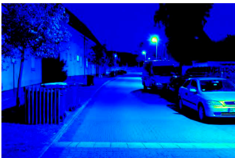
Leuchtdichteauswertung ( \text{cd}/\text{m}^2 ). Logarithmisch skaliertes Falschfarbenbild.
