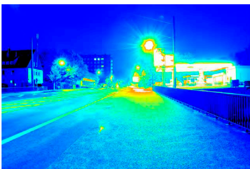
Leuchtdichteauswertung ( \text{cd}/\text{m}^2 ). Logarithmisch skaliertes Falschfarbenbild.
