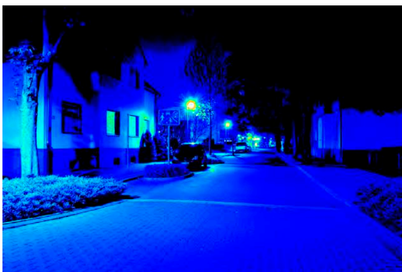
Leuchtdichteauswertung ( \text{cd}/\text{m}^2 ). Logarithmisch skaliertes Falschfarbenbild.
