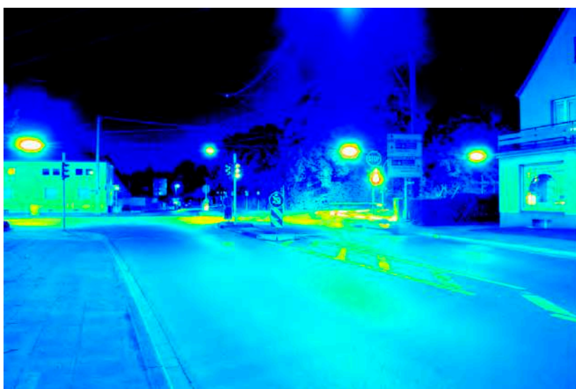
Leuchtdichteauswertung (cd/m 2 ). Logarithmisch skaliertes Falschfarbenbild.
