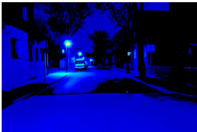
Leuchtdichteauswertung ( \text{cd}/\text{m}^2 ). Logarithmisch skaliertes Falschfarbenbild.
