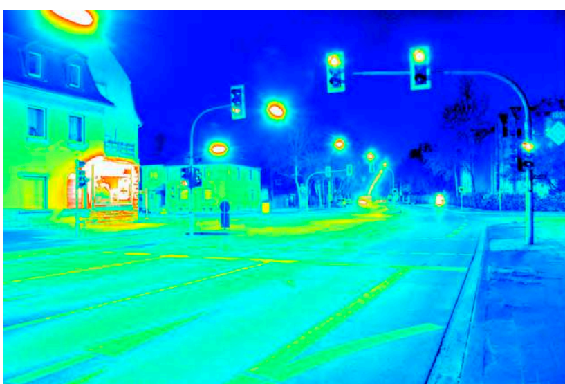
Leuchtdichteauswertung ( \text{cd/m}^2 ). Logarithmisch skaliertes Falschfarbenbild.
