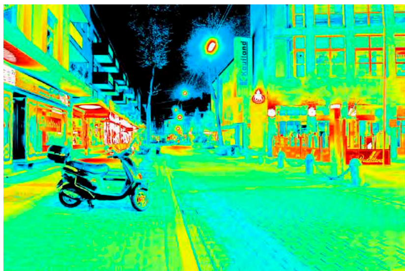
Leuchtdichteauswertung (cd/m 2 ). Logarithmisch skaliertes Falschfarbenbild.
