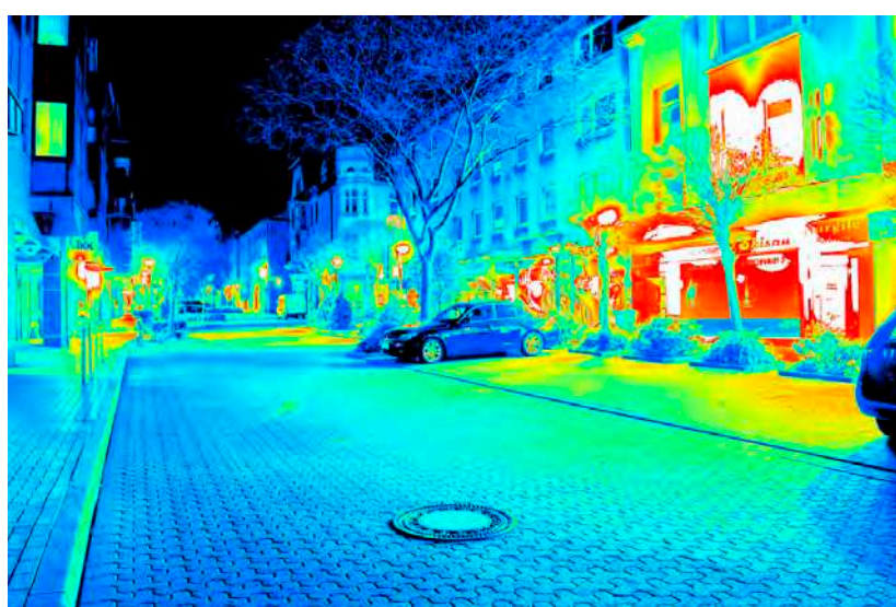
Leuchtdichteauswertung ( \text{cd}/\text{m}^2 ). Logarithmisch skaliertes Falschfarbenbild.
