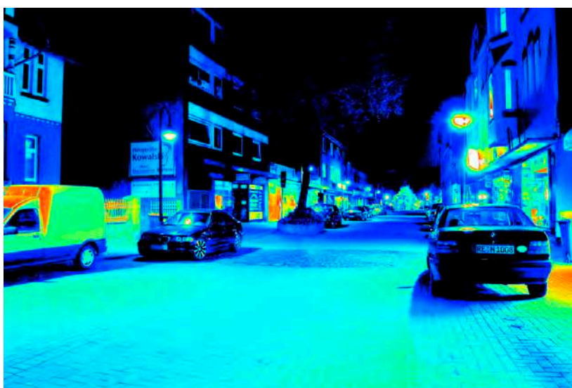
Leuchtdichteauswertung ( \text{cd}/\text{m}^2 ). Logarithmisch skaliertes Falschfarbenbild.
