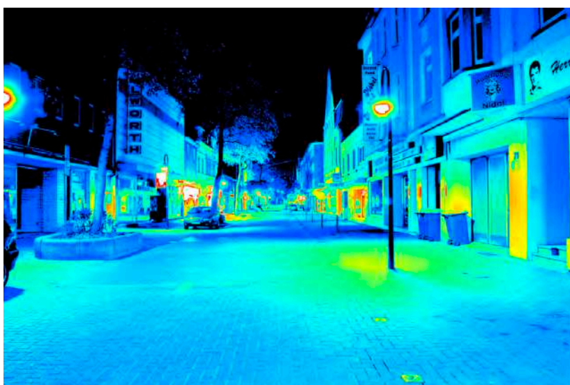
Leuchtdichteauswertung ( \text{cd}/\text{m}^2 ). Logarithmisch skaliertes Falschfarbenbild.
