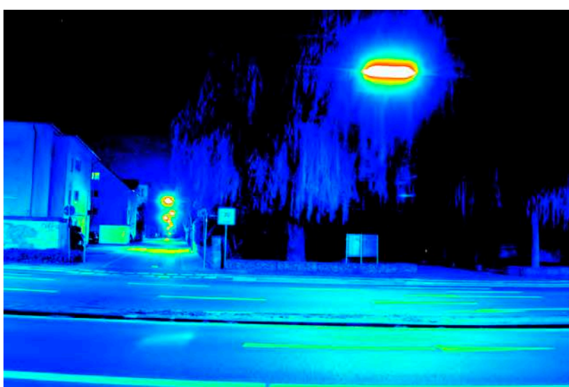
Leuchtdichteauswertung ( \text{cd}/\text{m}^2 ). Logarithmisch skaliertes Falschfarbenbild.
