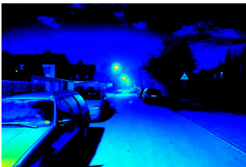
Leuchtdichteauswertung ( \text{cd}/\text{m}^2 ). Logarithmisch skaliertes Falschfarbenbild.
