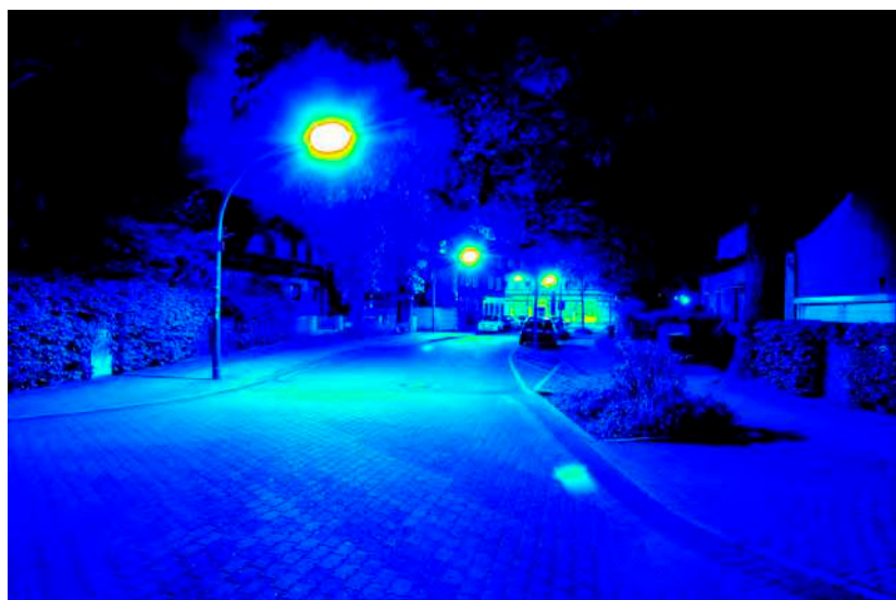
Leuchtdichteauswertung (cd/m 2 ). Logarithmisch skaliertes Falschfarbenbild.
