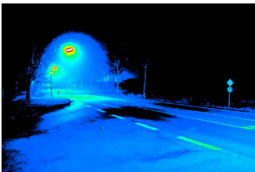
Leuchtdichteauswertung ( \text{cd}/\text{m}^2 ). Logarithmisch skaliertes Falschfarbenbild.
