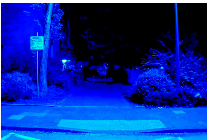
Leuchtdichteauswertung ( \text{cd}/\text{m}^2 ). Logarithmisch skaliertes Falschfarbenbild.
