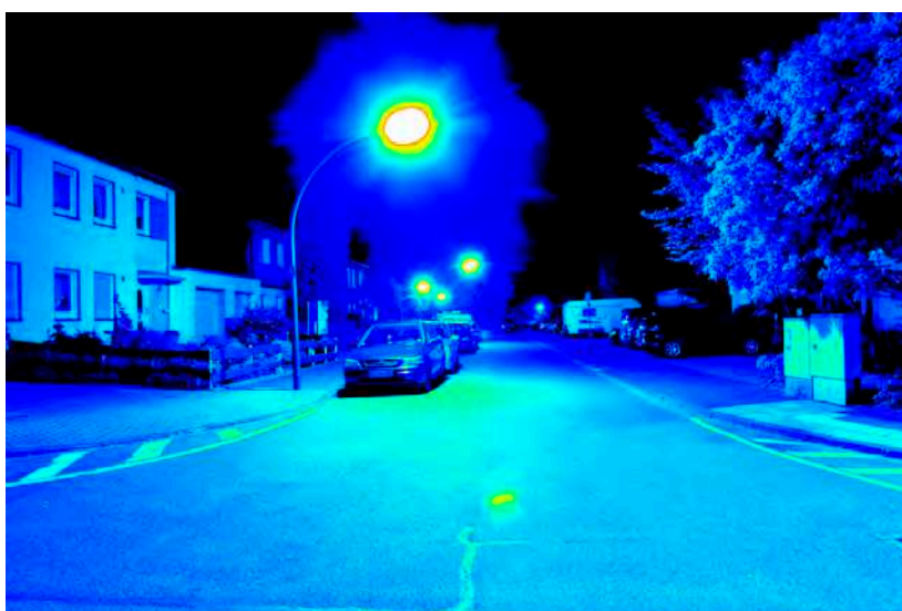
Leuchtdichteauswertung ( \text{cd}/\text{m}^2 ). Logarithmisch skaliertes Falschfarbenbild.
