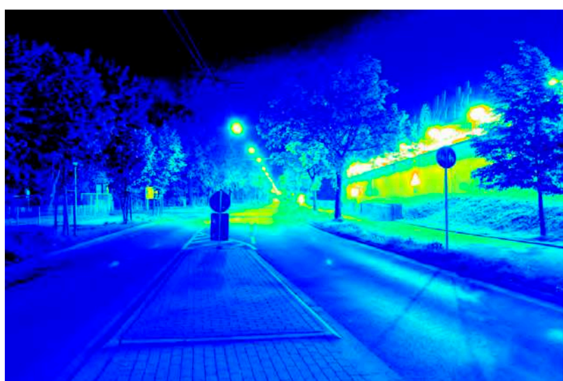
Leuchtdichteauswertung (cd/m 2 ). Logarithmisch skaliertes Falschfarbenbild.
