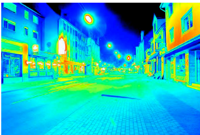
Leuchtdichteauswertung ( \text{cd}/\text{m}^2 ). Logarithmisch skaliertes Falschfarbenbild.
