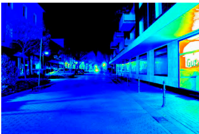
Leuchtdichteauswertung ( \text{cd/m}^2 ). Logarithmisch skaliertes Falschfarbenbild.
