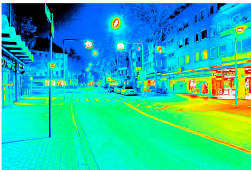
Leuchtdichteauswertung (cd/m 2 ). Logarithmisch skaliertes Falschfarbenbild.
