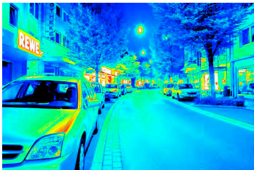
Leuchtdichteauswertung ( \text{cd}/\text{m}^2 ). Logarithmisch skaliertes Falschfarbenbild.
