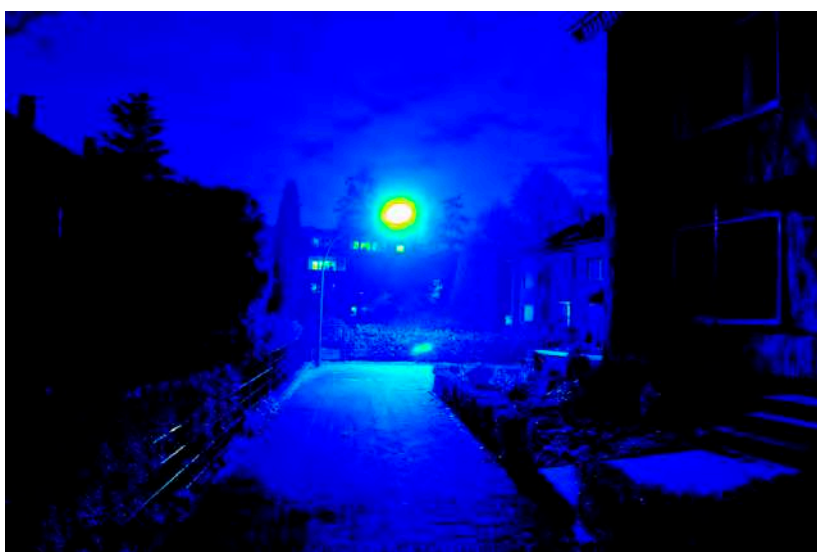
Leuchtdichteauswertung (cd/m 2 ). Logarithmisch skaliertes Falschfarbenbild.
