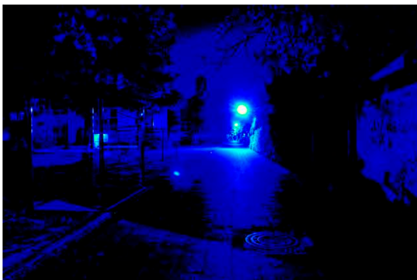
Leuchtdichteauswertung (cd/m 2 ). Logarithmisch skaliertes Falschfarbenbild.
