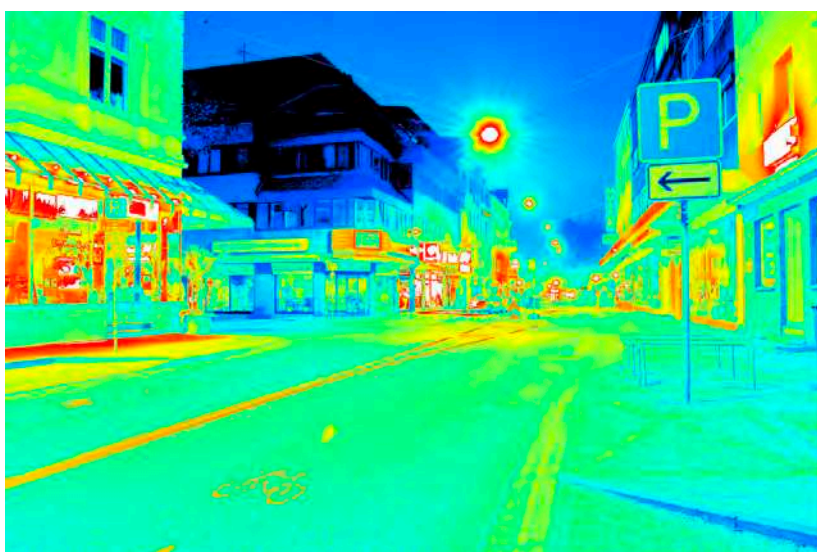
Leuchtdichteauswertung ( \text{cd}/\text{m}^2 ). Logarithmisch skaliertes Falschfarbenbild.
