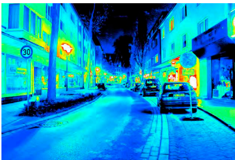
Leuchtdichteauswertung ( \text{cd}/\text{m}^2 ). Logarithmisch skaliertes Falschfarbenbild.
