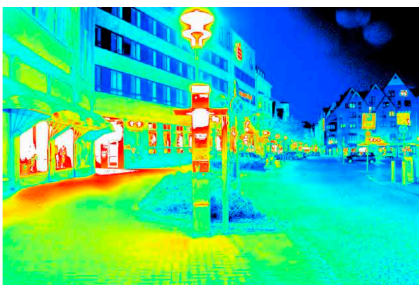
Leuchtdichteauswertung ( \text{cd}/\text{m}^2 ). Logarithmisch skaliertes Falschfarbenbild.
