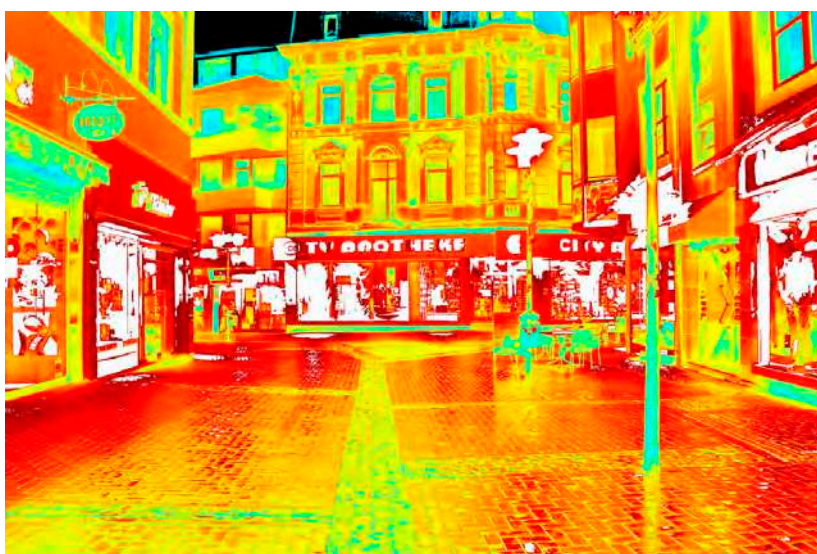
Leuchtdichteauswertung ( \text{cd}/\text{m}^2 ). Logarithmisch skaliertes Falschfarbenbild.
