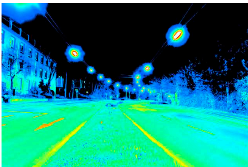
Leuchtdichteauswertung ( \text{cd}/\text{m}^2 ). Logarithmisch skaliertes Falschfarbenbild.
