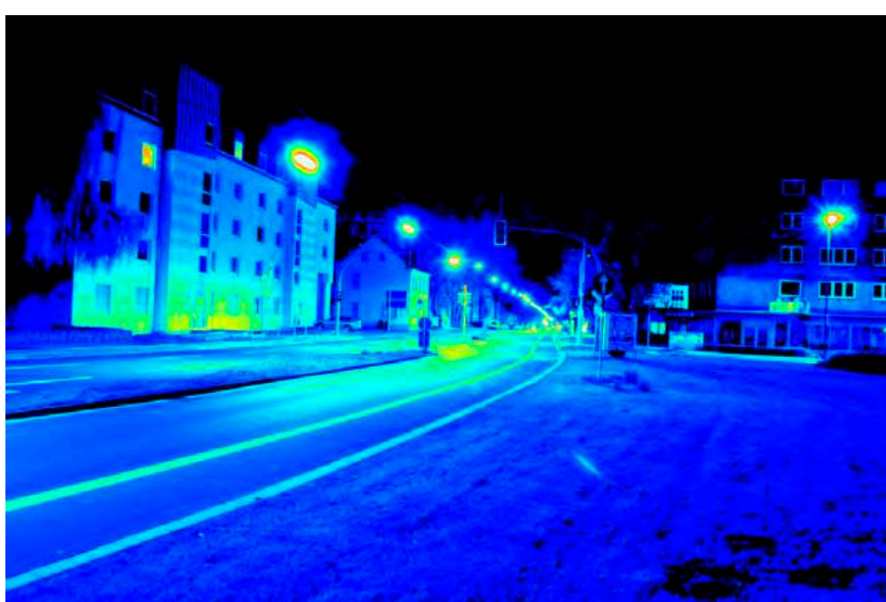
Leuchtdichteauswertung ( \text{cd}/\text{m}^2 ). Logarithmisch skaliertes Falschfarbenbild.
