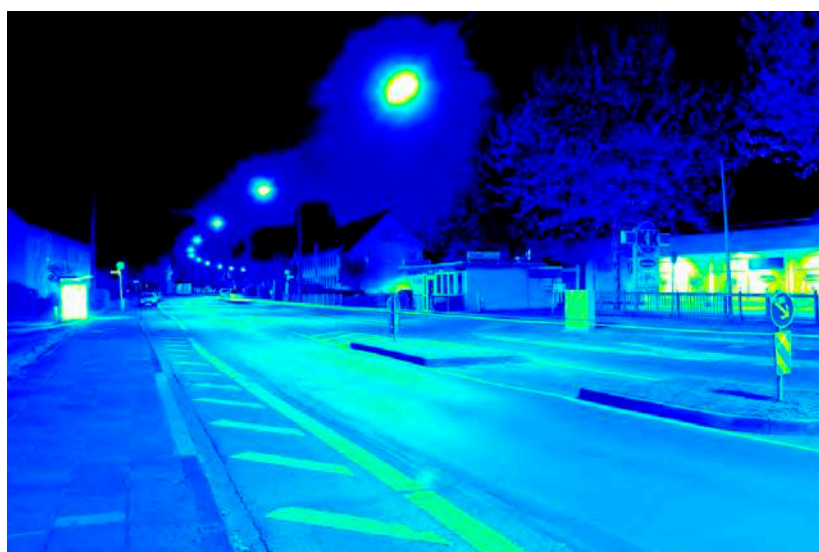
Leuchtdichteauswertung ( \text{cd}/\text{m}^2 ). Logarithmisch skaliertes Falschfarbenbild.
