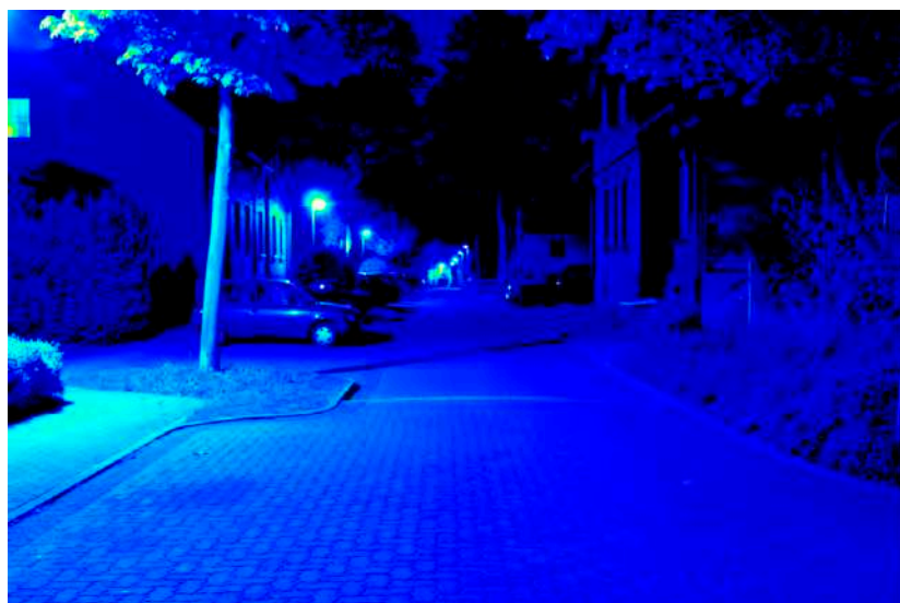
Leuchtdichteausswertung (cd/m 2 ). Logarithmisch skaliertes Falschfarbenbild.
