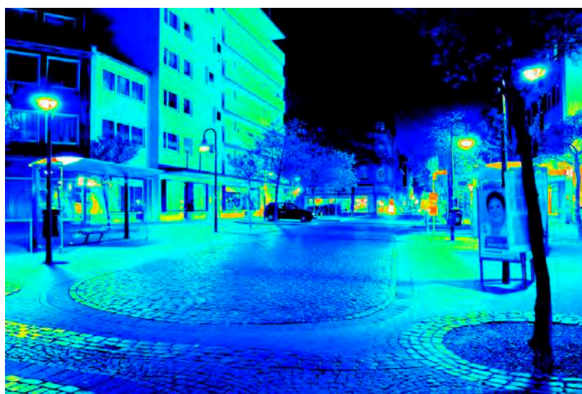
Leuchtdichteauswertung ( \text{cd}/\text{m}^2 ). Logarithmisch skaliertes Falschfarbenbild.
