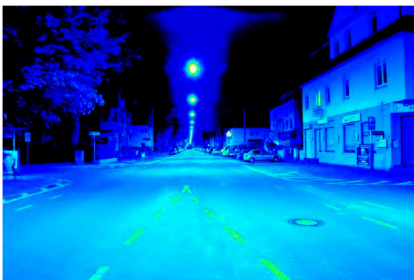
Leuchtdichteauswertung ( \text{cd}/\text{m}^2 ). Logarithmisch skaliertes Falschfarbenbild.
