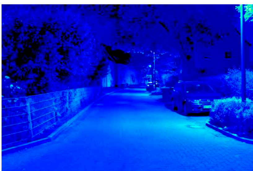
Leuchtdichteauswertung ( \text{cd}/\text{m}^2 ). Logarithmisch skaliertes Falschfarbenbild.
