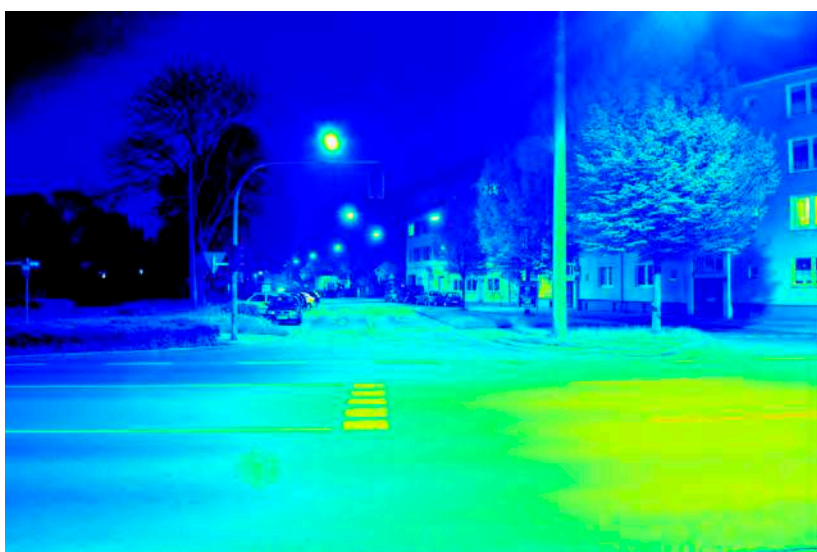
Leuchtdichteauswertung ( \text{cd}/\text{m}^2 ). Logarithmisch skaliertes Falschfarbenbild.
