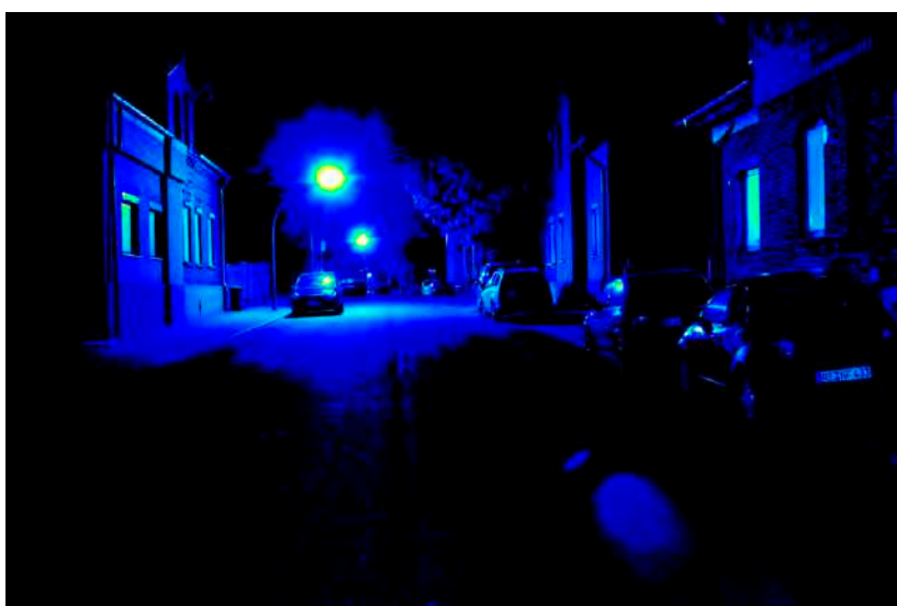
Leuchtdichteauswertung ( \text{cd}/\text{m}^2 ). Logarithmisch skaliertes Falschfarbenbild.
