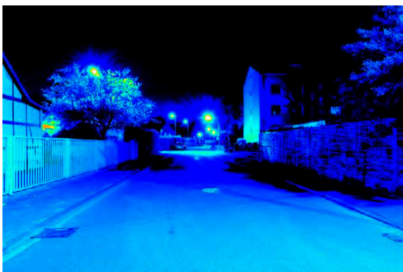
Leuchtdichteauswertung ( \text{cd}/\text{m}^2 ). Logarithmisch skaliertes Falschfarbenbild.
