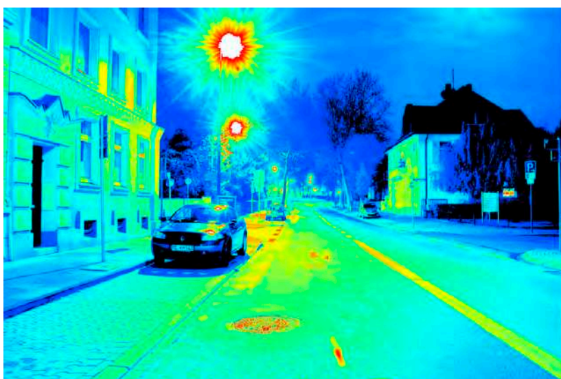
Leuchtdichteauswertung ( \text{cd}/\text{m}^2 ). Logarithmisch skaliertes Falschfarbenbild.
