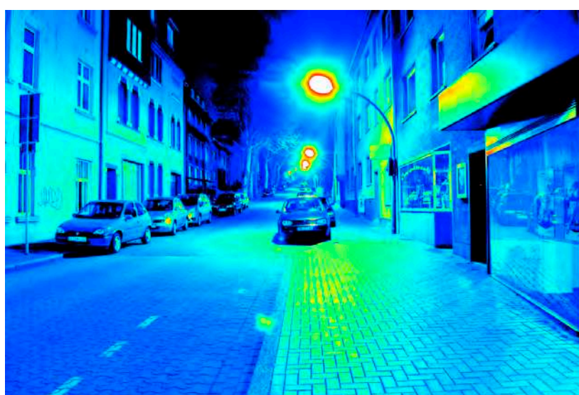
Leuchtdichteauswertung ( \text{cd}/\text{m}^2 ). Logarithmisch skaliertes Falschfarbenbild.
