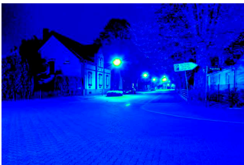
Leuchtdichteauswertung (cd/m 2 ). Logarithmisch skaliertes Falschfarbenbild.
