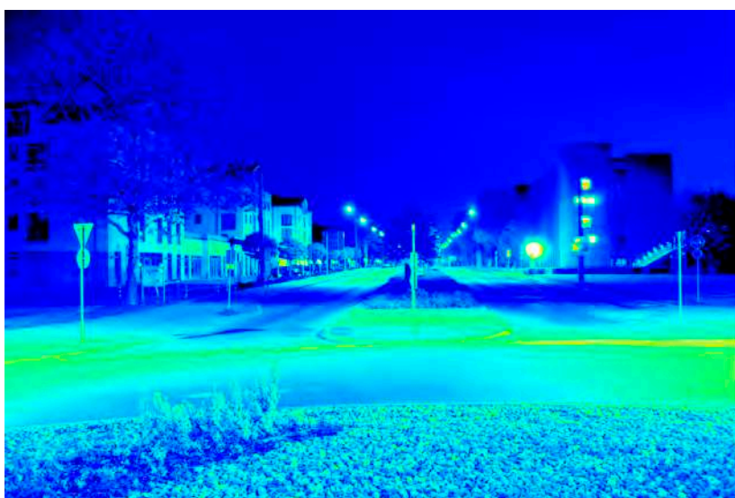
Leuchtdichteauswertung (cd/m 2 ). Logarithmisch skaliertes Falschfarbenbild.
