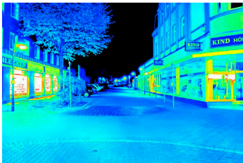
Leuchtdichteauswertung ( \text{cd}/\text{m}^2 ). Logarithmisch skaliertes Falschfarbenbild.
