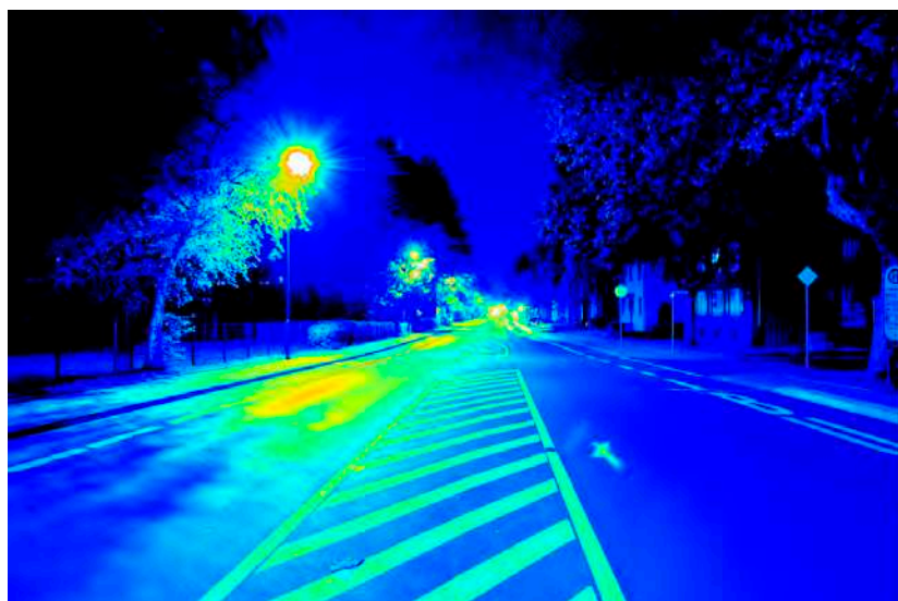
Leuchtdichteauswertung (cd/m 2 ). Logarithmisch skaliertes Falschfarbenbild.
