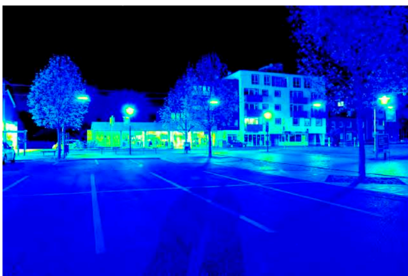
Leuchtdichteauswertung ( \text{cd}/\text{m}^2 ). Logarithmisch skaliertes Falschfarbenbild.
