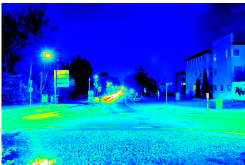
Leuchtdichteauswertung (cd/m 2 ). Logarithmisch skaliertes Falschfarbenbild.
