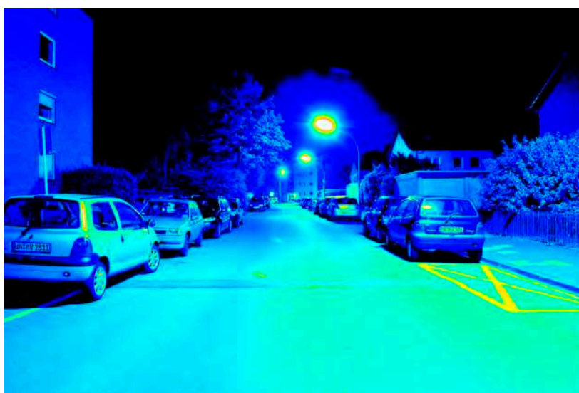
Leuchtdichteauswertung (cd/m 2 ). Logarithmisch skaliertes Falschfarbenbild.
