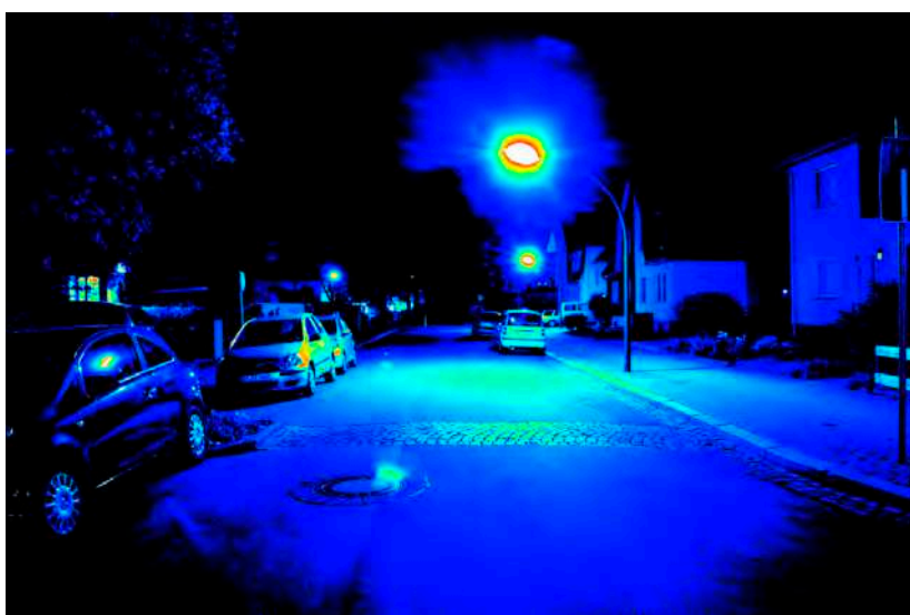
Leuchtdichteauswertung ( \text{cd/m}^2 ). Logarithmisch skaliertes Falschfarbenbild.
