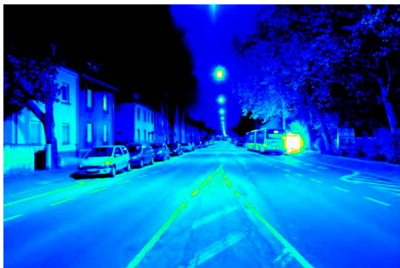
Leuchtdichteauswertung ( \text{cd}/\text{m}^2 ). Logarithmisch skaliertes Falschfarbenbild.
