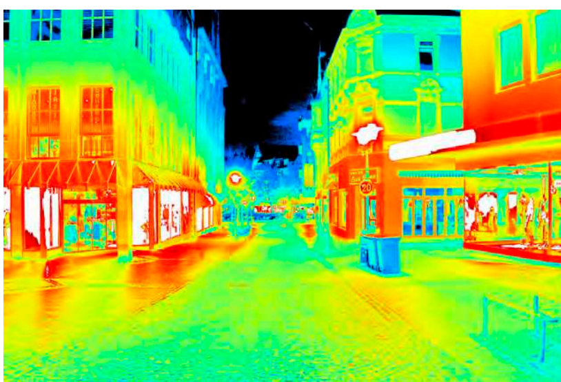
Leuchtdichteauswertung (cd/m 2 ). Logarithmisch skaliertes Falschfarbenbild.
