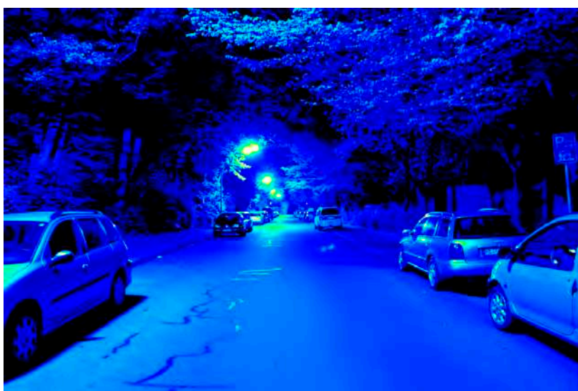
Leuchtdichteauswertung ( \text{cd}/\text{m}^2 ). Logarithmisch skaliertes Falschfarbenbild.
