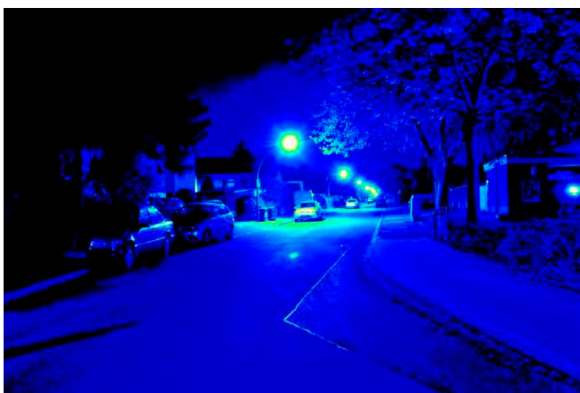
Leuchtdichteauswertung ( \text{cd}/\text{m}^2 ). Logarithmisch skaliertes Falschfarbenbild.
