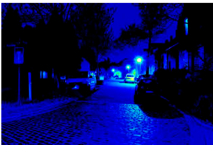
Leuchtdichteauswertung ( \text{cd}/\text{m}^2 ). Logarithmisch skaliertes Falschfarbenbild.
