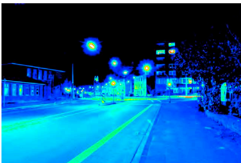
Leuchtdichteauswertung (cd/m 2 ). Logarithmisch skaliertes Falschfarbenbild.
