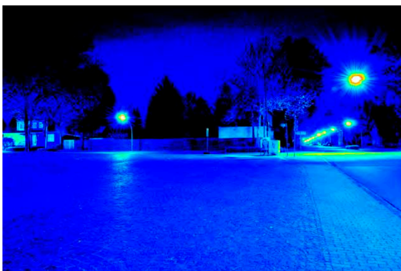
Leuchtdichteauswertung (cd/m 2 ). Logarithmisch skaliertes Falschfarbenbild.
