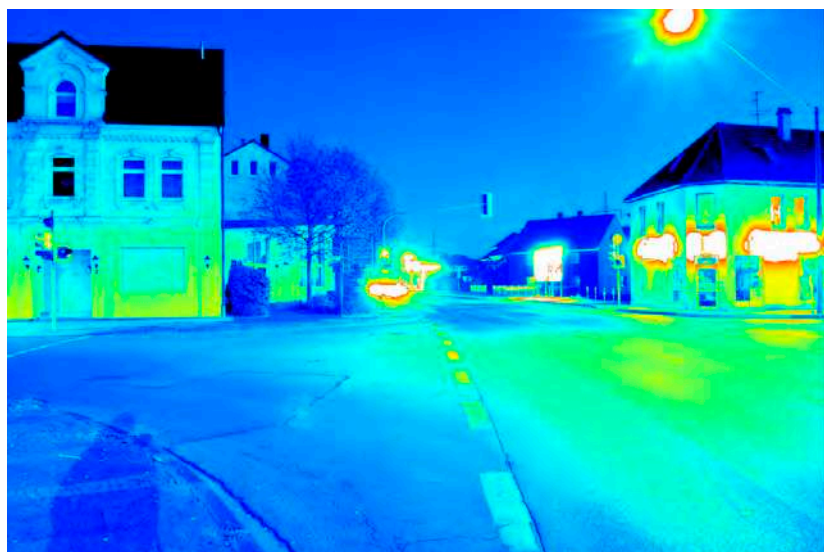
Leuchtdichteauswertung ( \text{cd}/\text{m}^2 ). Logarithmisch skaliertes Falschfarbenbild.
