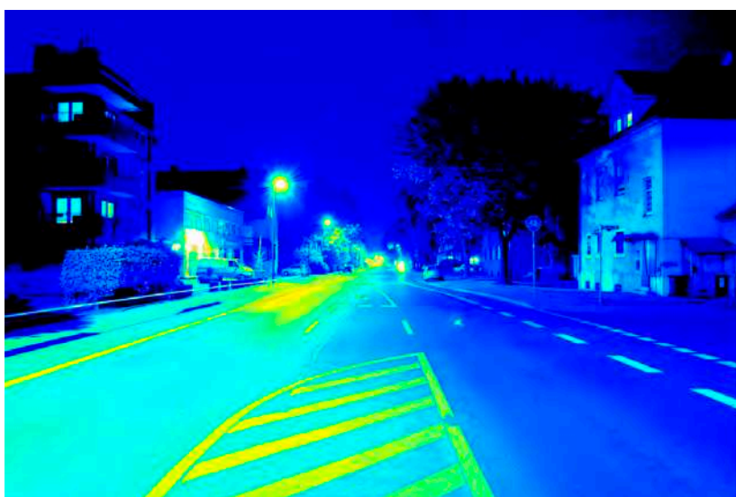
Leuchtdichteauswertung ( \text{cd}/\text{m}^2 ). Logarithmisch skaliertes Falschfarbenbild.
