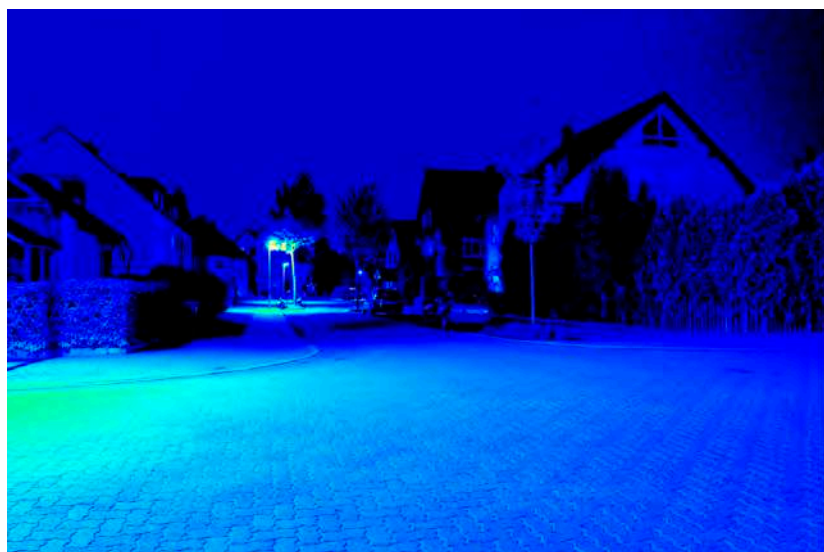
Leuchtdichteauswertung ( \text{cd}/\text{m}^2 ). Logarithmisch skaliertes Falschfarbenbild.
