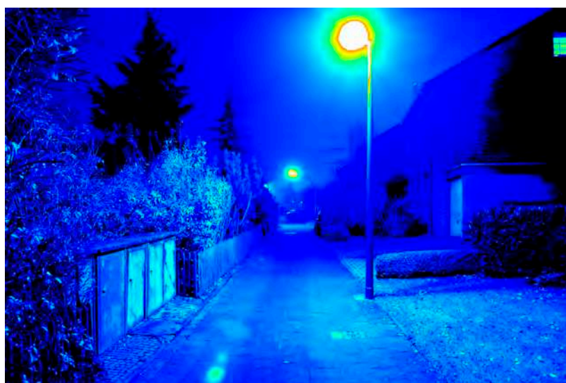
Leuchtdichteauswertung (cd/m 2 ). Logarithmisch skaliertes Falschfarbenbild.
