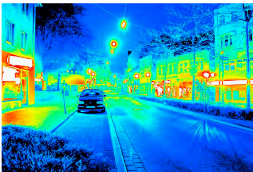
Leuchtdichteauswertung ( \text{cd/m}^2 ). Logarithmisch skaliertes Falschfarbenbild.
