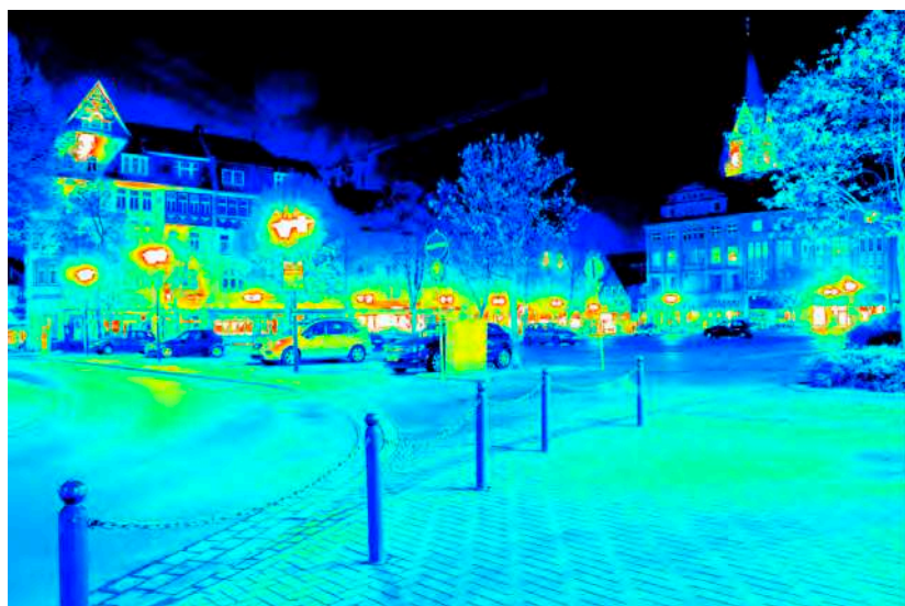
Leuchtdichteauswertung ( \text{cd}/\text{m}^2 ). Logarithmisch skaliertes Falschfarbenbild.
