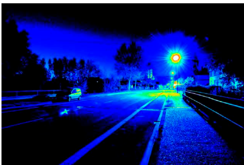
Leuchtdichteauswertung ( \text{cd}/\text{m}^2 ). Logarithmisch skaliertes Falschfarbenbild.
