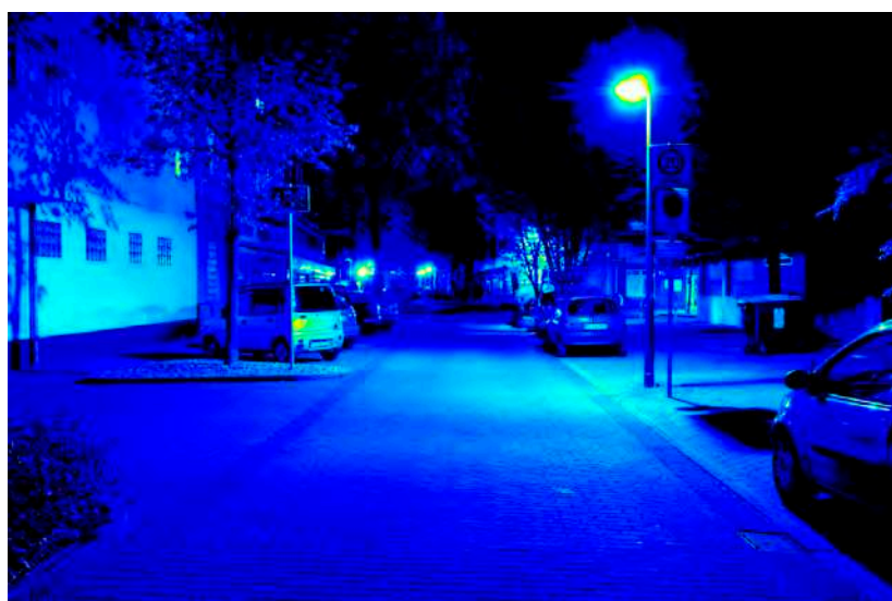
Leuchtdichteauswertung ( \text{cd}/\text{m}^2 ). Logarithmisch skaliertes Falschfarbenbild.
