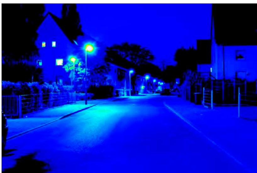
Leuchtdichteauswertung (cd/m 2 ). Logarithmisch skaliertes Falschfarbenbild.
