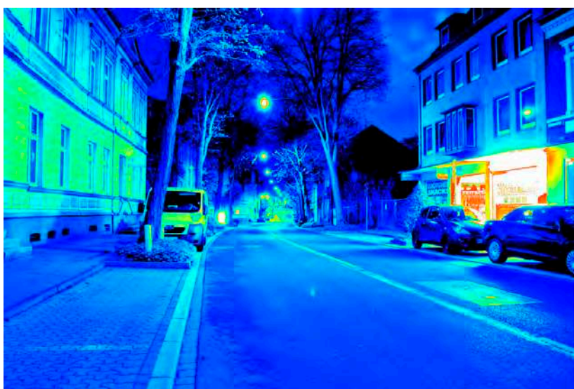
Leuchtdichteauswertung ( \text{cd}/\text{m}^2 ). Logarithmisch skaliertes Falschfarbenbild.
