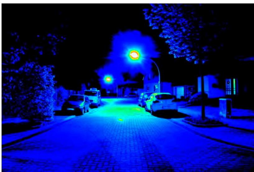
Leuchtdichteauswertung ( \text{cd}/\text{m}^2 ). Logarithmisch skaliertes Falschfarbenbild.
