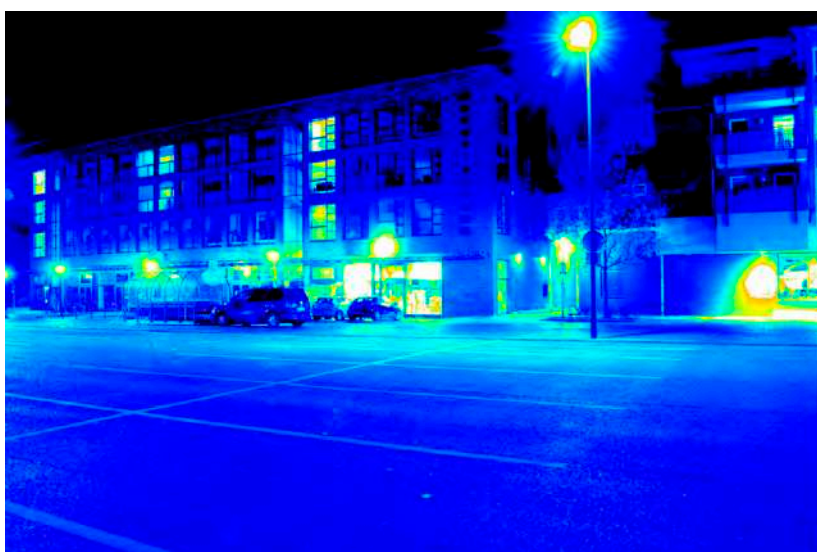
Leuchtdichteauswertung (cd/m 2 ). Logarithmisch skaliertes Falschfarbenbild.
