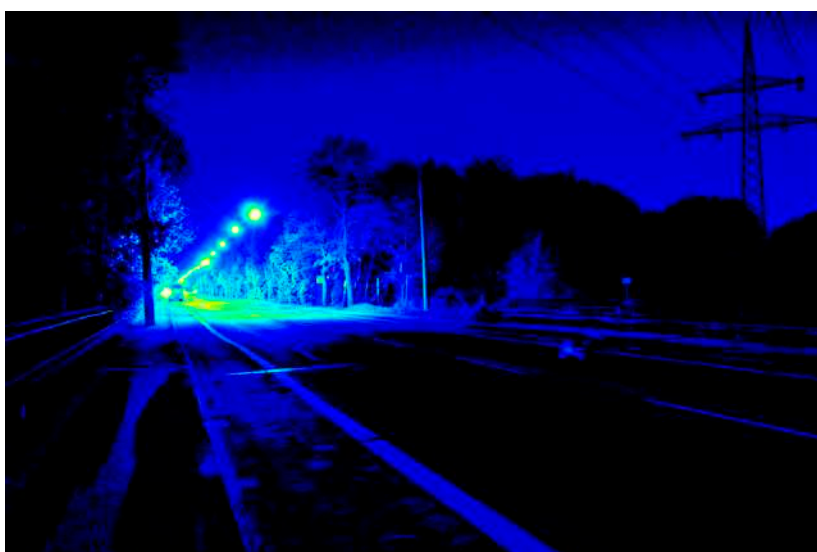
Leuchtdichteauswertung ( \text{cd}/\text{m}^2 ). Logarithmisch skaliertes Falschfarbenbild.
