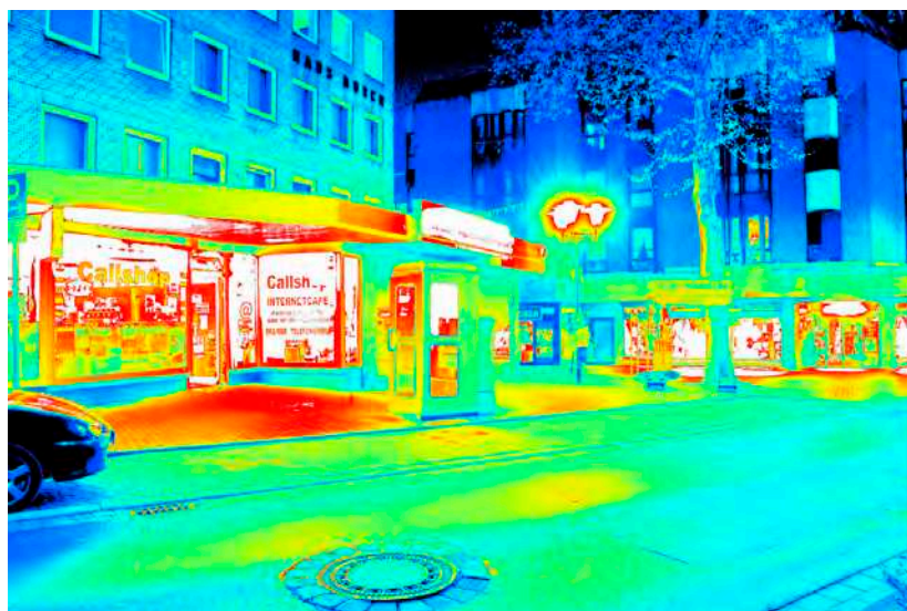
Leuchtdichteauswertung ( \text{cd}/\text{m}^2 ). Logarithmisch skaliertes Falschfarbenbild.
