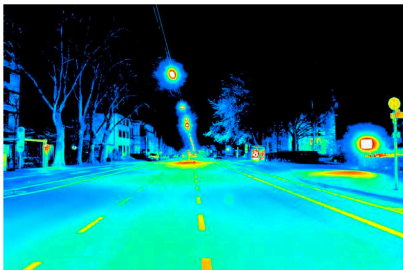
Leuchtdichteauswertung ( \text{cd}/\text{m}^2 ). Logarithmisch skaliertes Falschfarbenbild.
