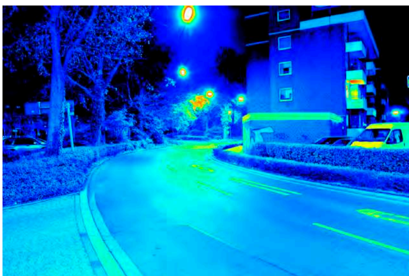
Leuchtdichteauswertung ( \text{cd}/\text{m}^2 ). Logarithmisch skaliertes Falschfarbenbild.
