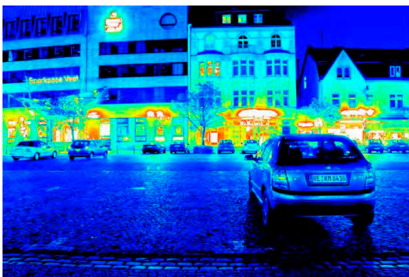
Leuchtdichteauswertung ( \text{cd}/\text{m}^2 ). Logarithmisch skaliertes Falschfarbenbild.
