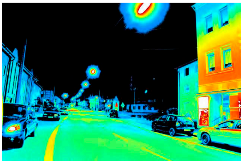
Leuchtdichteauswertung ( \text{cd}/\text{m}^2 ). Logarithmisch skaliertes Falschfarbenbild.
