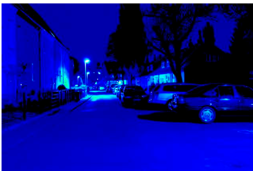
Leuchtdichteauswertung ( \text{cd/m}^2 ). Logarithmisch skaliertes Falschfarbenbild.
