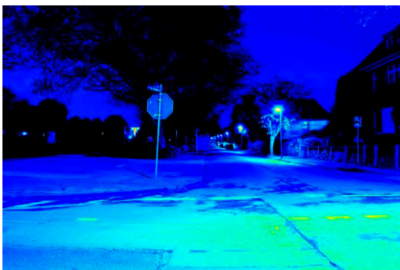
Leuchtdichteauswertung ( \text{cd}/\text{m}^2 ). Logarithmisch skaliertes Falschfarbenbild.
