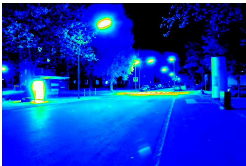
Leuchtdichteauswertung ( \text{cd}/\text{m}^2 ). Logarithmisch skaliertes Falschfarbenbild.
