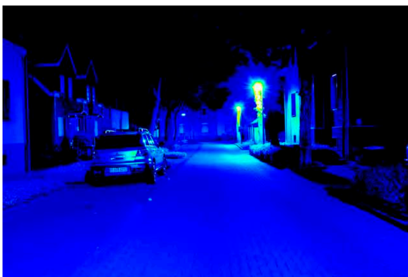
Leuchtdichteauswertung ( \text{cd}/\text{m}^2 ). Logarithmisch skaliertes Falschfarbenbild.
