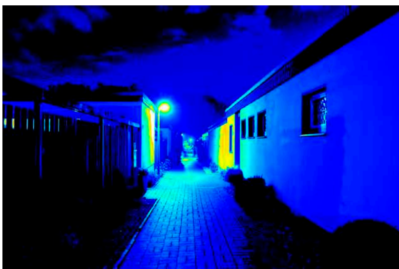
Leuchtdichteauswertung ( \text{cd/m}^2 ). Logarithmisch skaliertes Falschfarbenbild.
