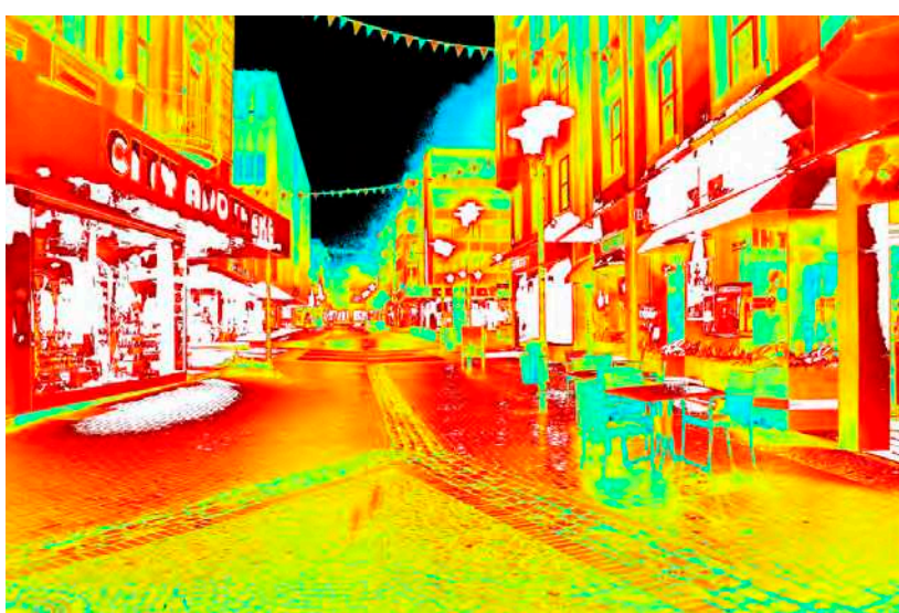
Leuchtdichteauswertung ( \text{cd}/\text{m}^2 ). Logarithmisch skaliertes Falschfarbenbild.
