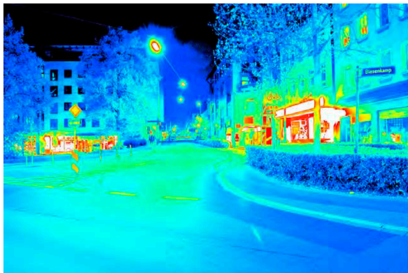
Leuchtdichteauswertung ( \text{cd}/\text{m}^2 ). Logarithmisch skaliertes Falschfarbenbild.
