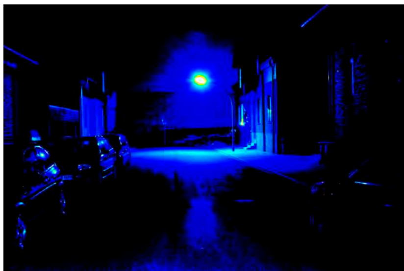
Leuchtdichteauswertung ( \text{cd}/\text{m}^2 ). Logarithmisch skaliertes Falschfarbenbild.
