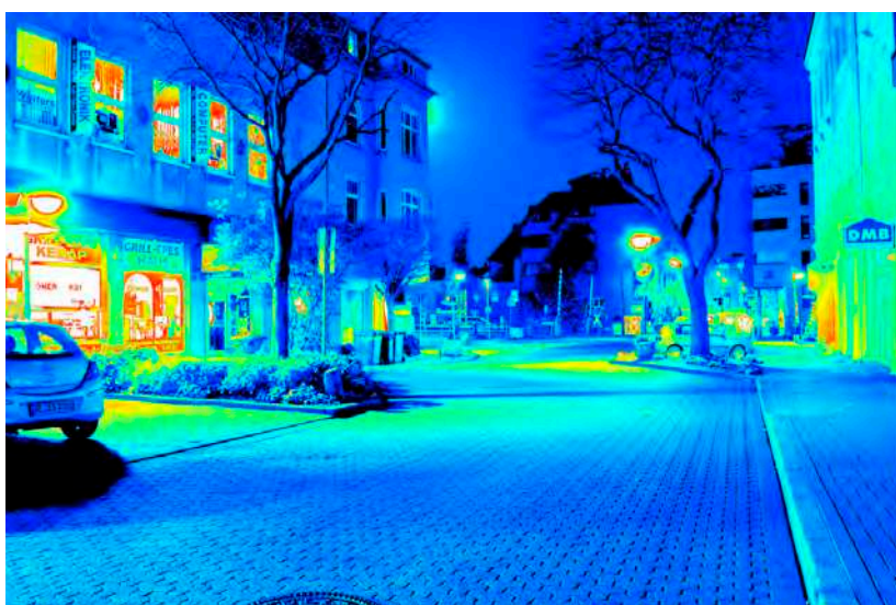
Leuchtdichteauswertung ( \text{cd}/\text{m}^2 ). Logarithmisch skaliertes Falschfarbenbild.
