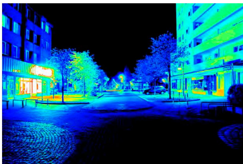
Leuchtdichteauswertung ( \text{cd}/\text{m}^2 ). Logarithmisch skaliertes Falschfarbenbild.
