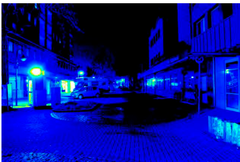
Leuchtdichteauswertung (cd/m 2 ). Logarithmisch skaliertes Falschfarbenbild.
