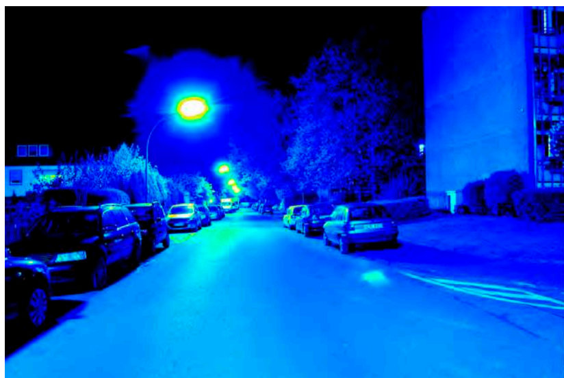
Leuchtdichteauswertung (cd/m 2 ). Logarithmisch skaliertes Falschfarbenbild.
