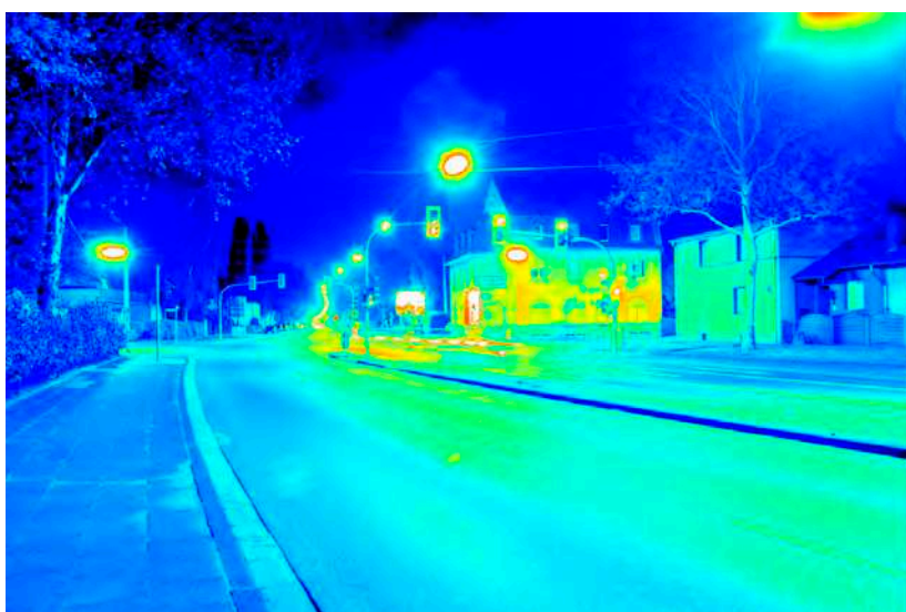
Leuchtdichteauswertung ( \text{cd/m}^2 ). Logarithmisch skaliertes Falschfarbenbild.
