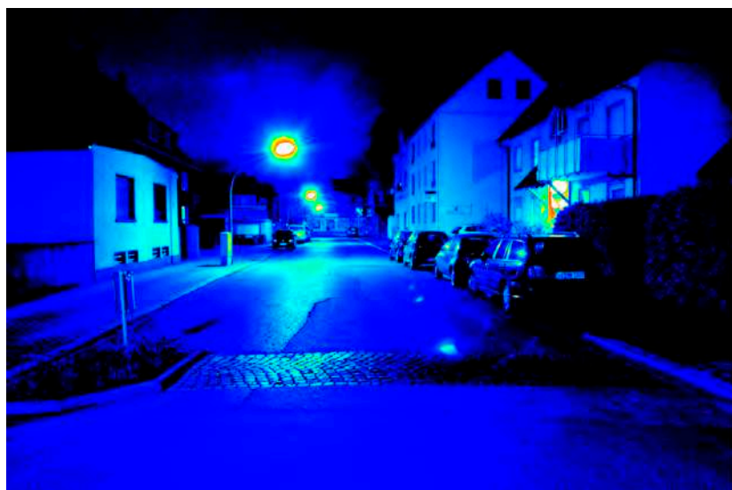
Leuchtdichteauswertung ( \text{cd}/\text{m}^2 ). Logarithmisch skaliertes Falschfarbenbild.
