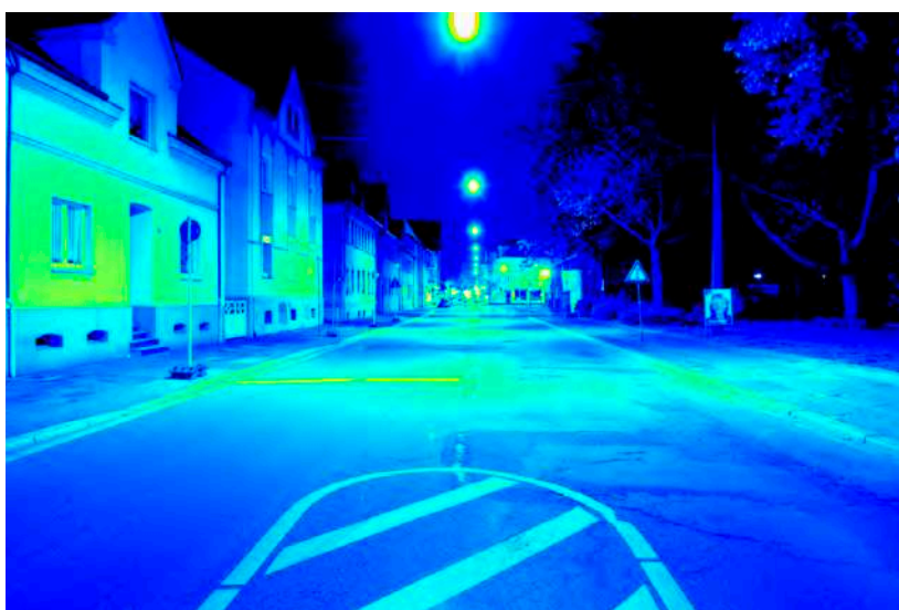
Leuchtdichteauswertung ( \text{cd/m}^2 ). Logarithmisch skaliertes Falschfarbenbild.
