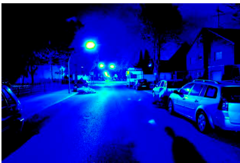
Leuchtdichteauswertung ( \text{cd}/\text{m}^2 ). Logarithmisch skaliertes Falschfarbenbild.
