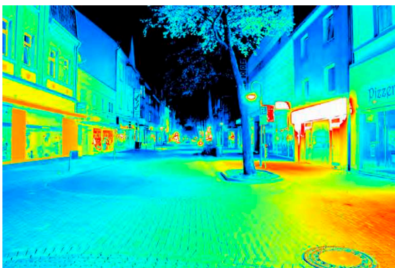
Leuchtdichteauswertung ( \text{cd}/\text{m}^2 ). Logarithmisch skaliertes Falschfarbenbild.
