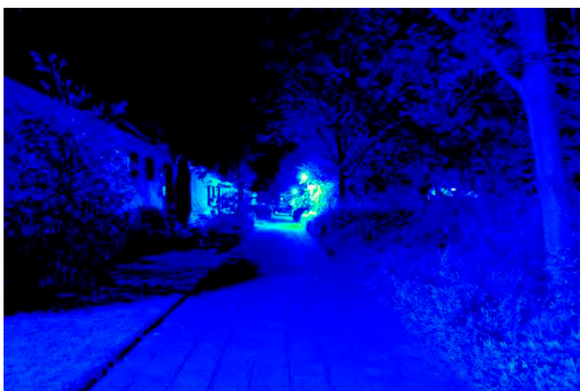
Leuchtdichteauswertung ( \text{cd}/\text{m}^2 ). Logarithmisch skaliertes Falschfarbenbild.
