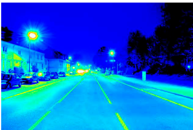
Leuchtdichteauswertung ( \text{cd}/\text{m}^2 ). Logarithmisch skaliertes Falschfarbenbild.
