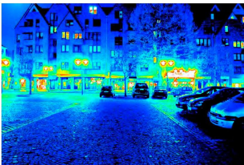
Leuchtdichteauswertung ( \text{cd}/\text{m}^2 ). Logarithmisch skaliertes Falschfarbenbild.
