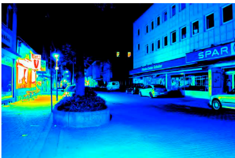
Leuchtdichteauswertung ( \text{cd}/\text{m}^2 ). Logarithmisch skaliertes Falschfarbenbild.
