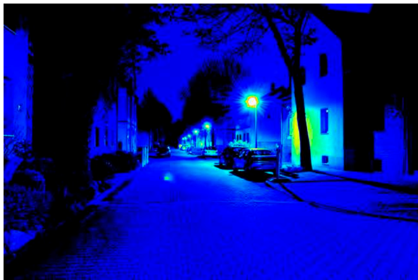
Leuchtdichteauswertung ( \text{cd}/\text{m}^2 ). Logarithmisch skaliertes Falschfarbenbild.
