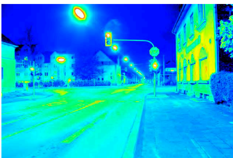
Leuchtdichteauswertung ( \text{cd}/\text{m}^2 ). Logarithmisch skaliertes Falschfarbenbild.
