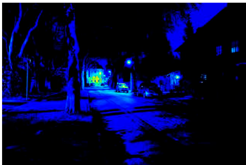
Leuchtdichteauswertung ( \text{cd}/\text{m}^2 ). Logarithmisch skaliertes Falschfarbenbild.
