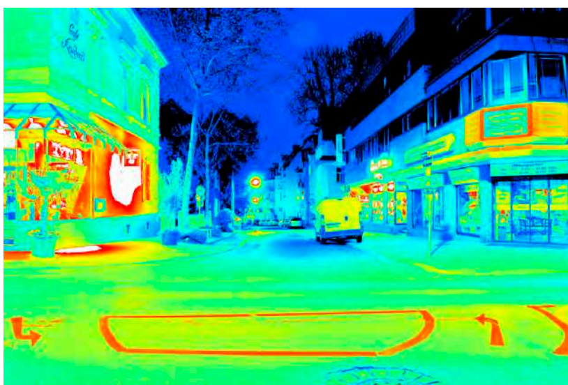
Leuchtdichteauswertung ( \text{cd}/\text{m}^2 ). Logarithmisch skaliertes Falschfarbenbild.
