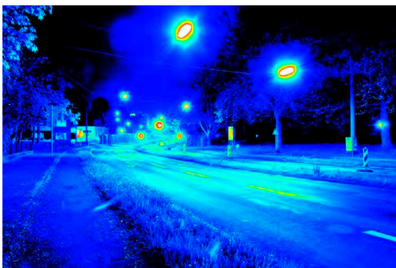
Leuchtdichteauswertung ( \text{cd}/\text{m}^2 ). Logarithmisch skaliertes Falschfarbenbild.
