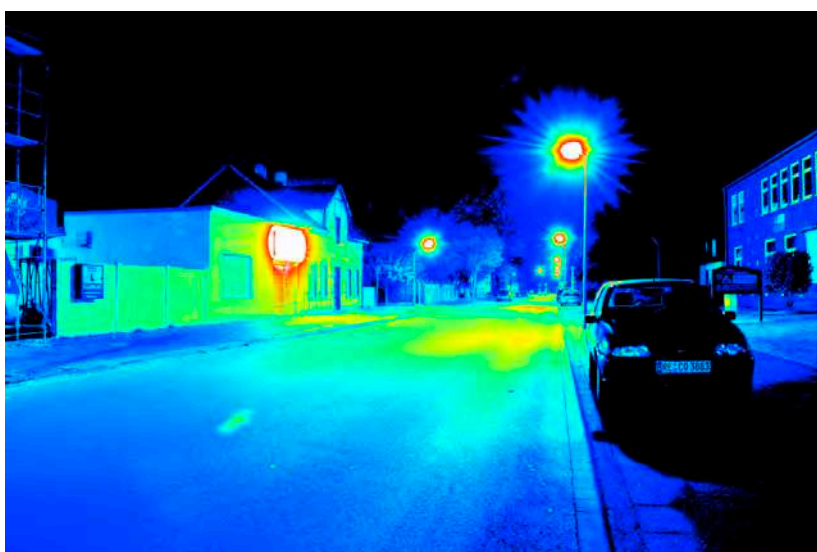
Leuchtdichteauswertung ( \text{cd/m}^2 ). Logarithmisch skaliertes Falschfarbenbild.
