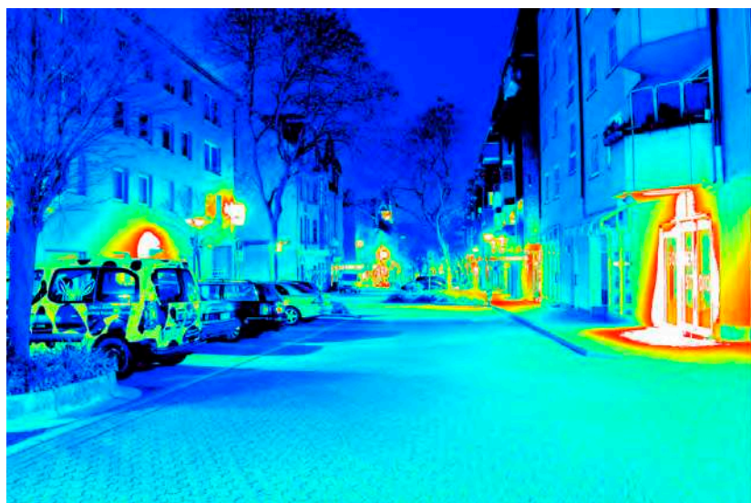
Leuchtdichteauswertung ( \text{cd}/\text{m}^2 ). Logarithmisch skaliertes Falschfarbenbild.
