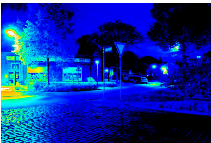
Leuchtdichteauswertung (cd/m 2 ). Logarithmisch skaliertes Falschfarbenbild.
