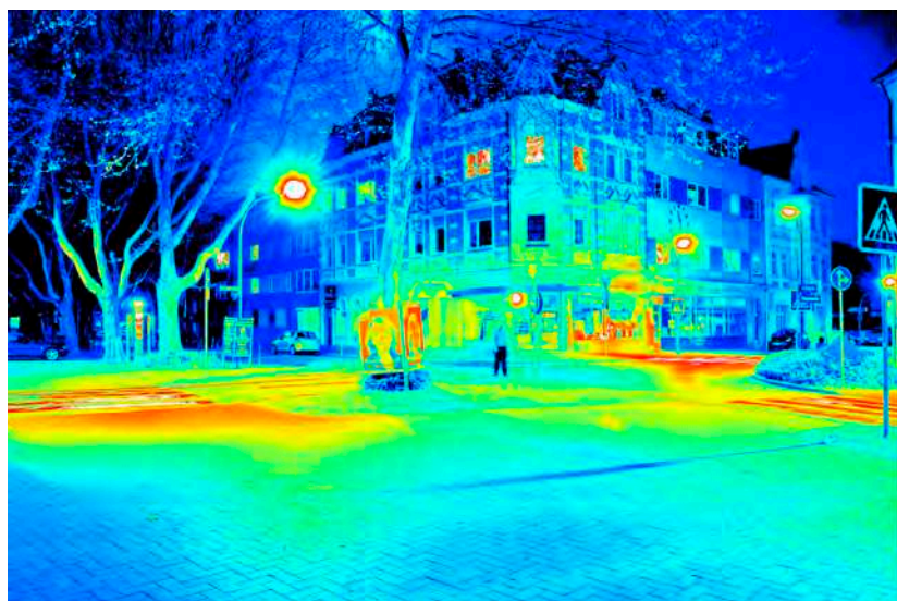
Leuchtdichteauswertung ( \text{cd}/\text{m}^2 ). Logarithmisch skaliertes Falschfarbenbild.
