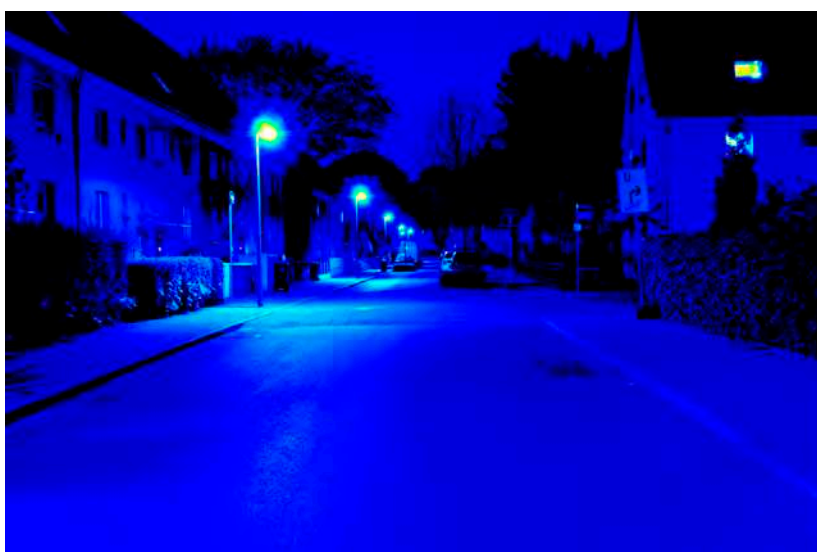
Leuchtdichteauswertung ( \text{cd}/\text{m}^2 ). Logarithmisch skaliertes Falschfarbenbild.
