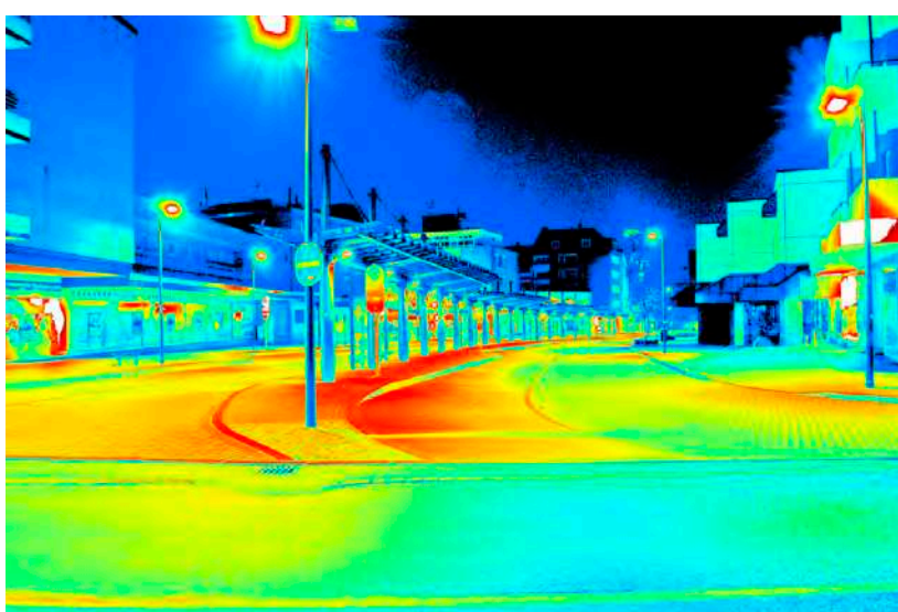
Leuchtdichteauswertung ( \text{cd}/\text{m}^2 ). Logarithmisch skaliertes Falschfarbenbild.
