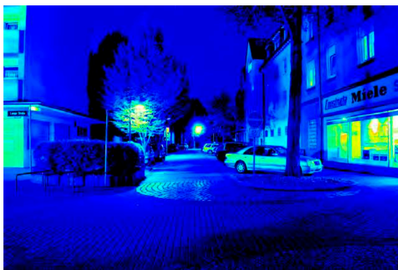
Leuchtdichteauswertung ( \text{cd}/\text{m}^2 ). Logarithmisch skaliertes Falschfarbenbild.
