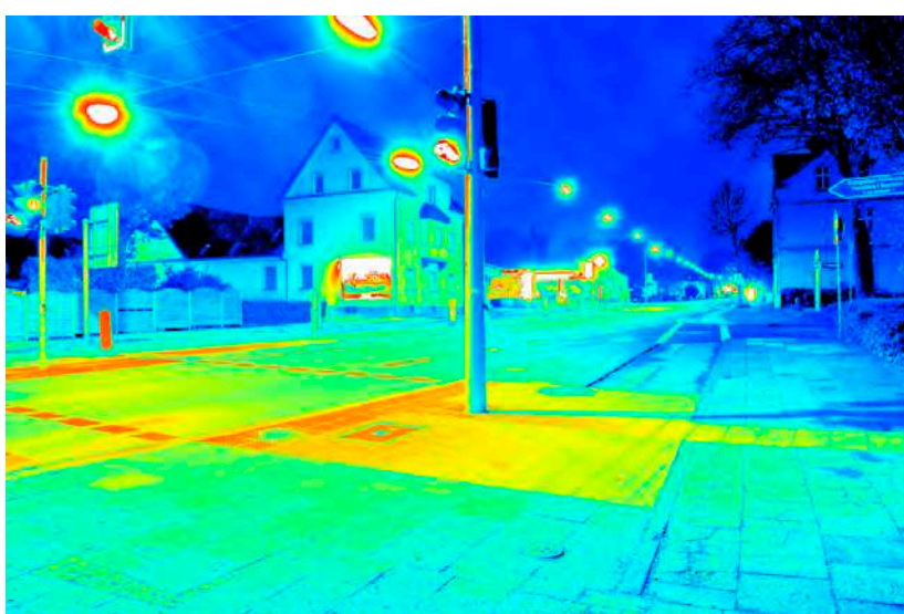
Leuchtdichteauswertung ( \text{cd}/\text{m}^2 ). Logarithmisch skaliertes Falschfarbenbild.
