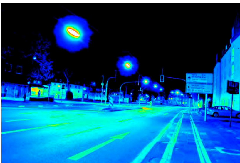
Leuchtdichteauswertung ( \text{cd}/\text{m}^2 ). Logarithmisch skaliertes Falschfarbenbild.
