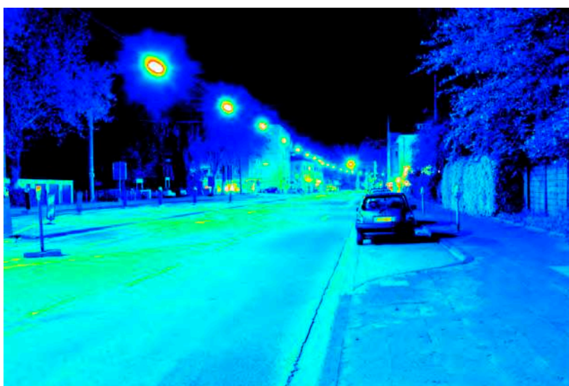
Leuchtdichteauswertung (cd/m 2 ). Logarithmisch skaliertes Falschfarbenbild.
