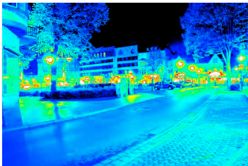
Leuchtdichteauswertung ( \text{cd}/\text{m}^2 ). Logarithmisch skaliertes Falschfarbenbild.
