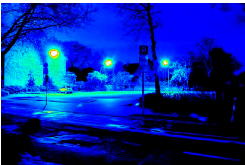
Leuchtdichteauswertung (cd/m 2 ). Logarithmisch skaliertes Falschfarbenbild.
