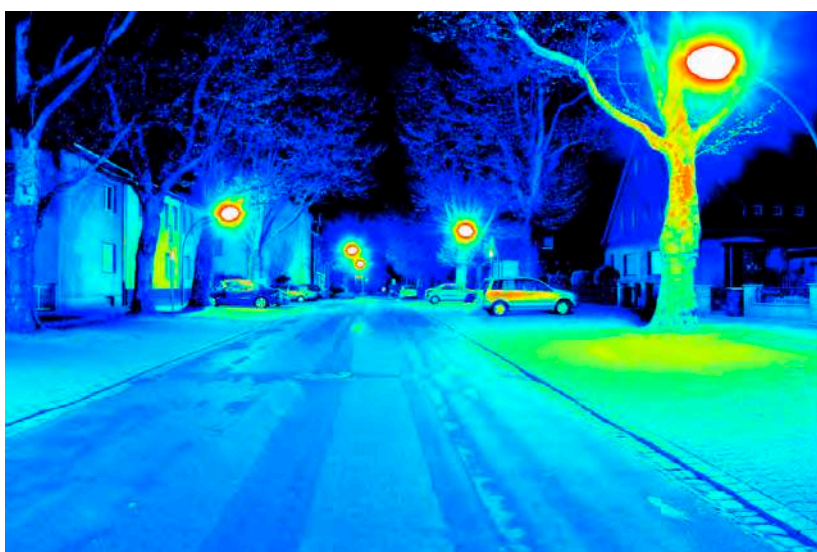
Leuchtdichteauswertung ( \text{cd}/\text{m}^2 ). Logarithmisch skaliertes Falschfarbenbild.
