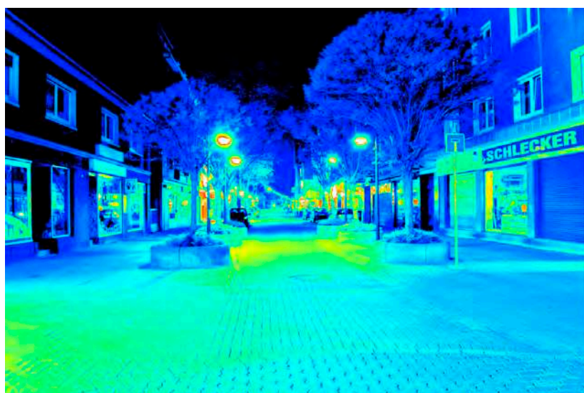
Leuchtdichteauswertung ( \text{cd}/\text{m}^2 ). Logarithmisch skaliertes Falschfarbenbild.
