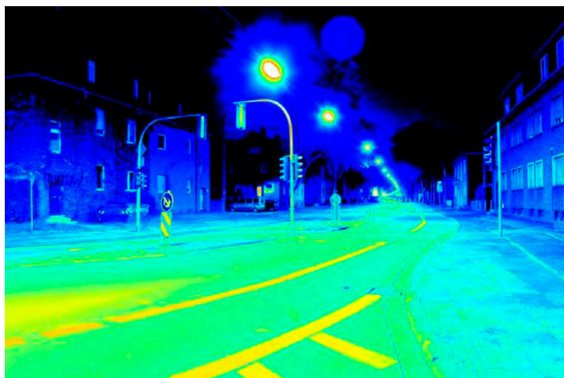
Leuchtdichteauswertung ( \text{cd}/\text{m}^2 ). Logarithmisch skaliertes Falschfarbenbild.
