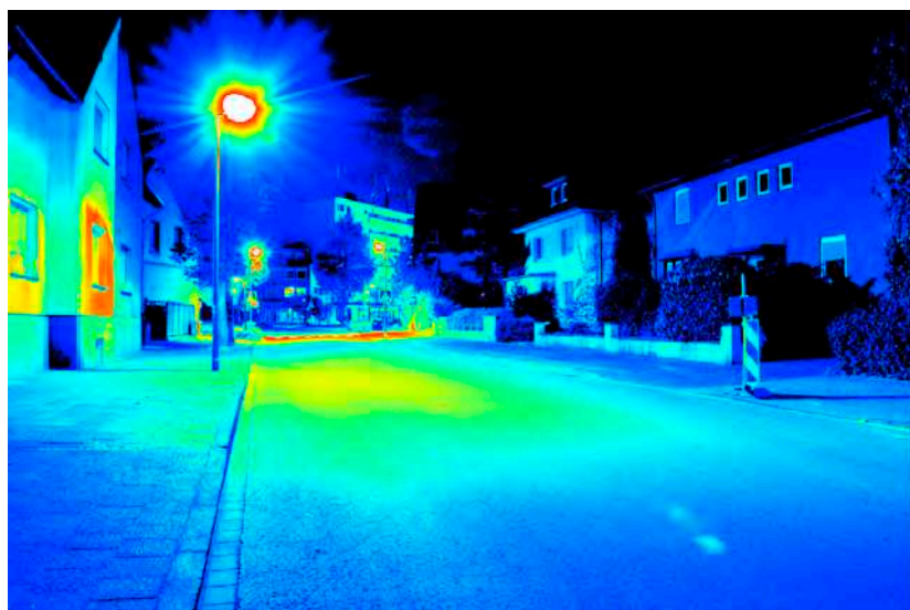
Leuchtdichteauswertung ( \text{cd}/\text{m}^2 ). Logarithmisch skaliertes Falschfarbenbild.
