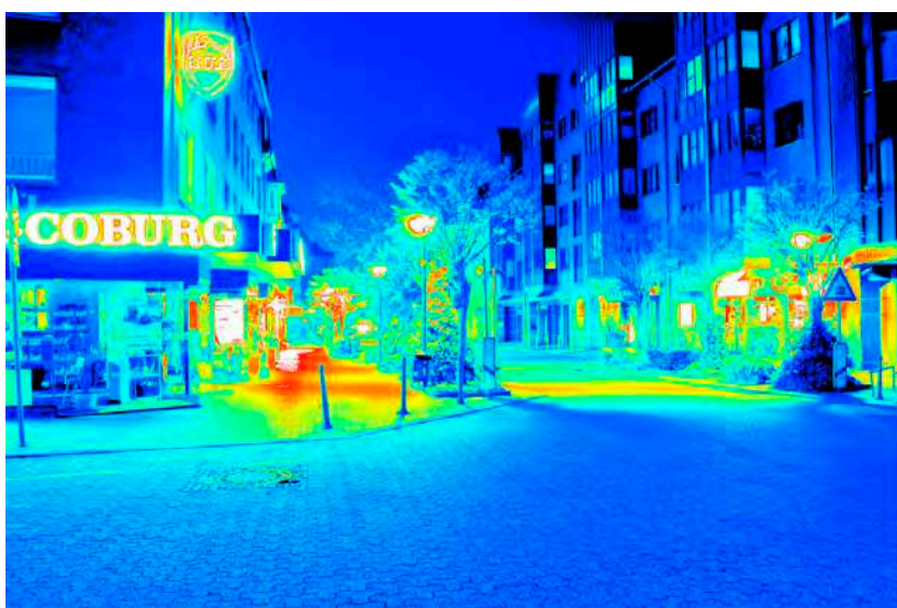
Leuchtdichteauswertung ( \text{cd}/\text{m}^2 ). Logarithmisch skaliertes Falschfarbenbild.
