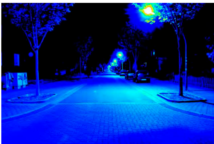
Leuchtdichteauswertung ( \text{cd}/\text{m}^2 ). Logarithmisch skaliertes Falschfarbenbild.
