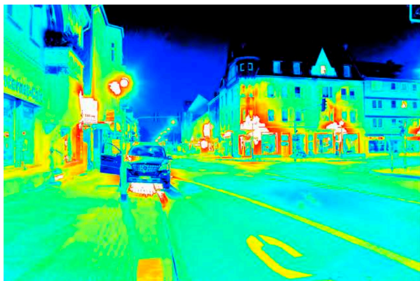
Leuchtdichteauswertung ( \text{cd}/\text{m}^2 ). Logarithmisch skaliertes Falschfarbenbild.
