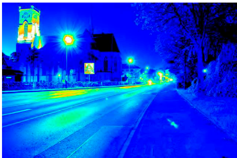
Leuchtdichteauswertung ( \text{cd}/\text{m}^2 ). Logarithmisch skaliertes Falschfarbenbild.
