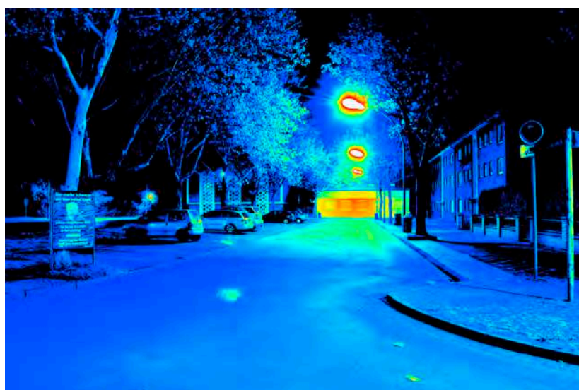
Leuchtdichteauswertung (cd/m 2 ). Logarithmisch skaliertes Falschfarbenbild.
