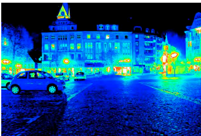
Leuchtdichteauswertung ( \text{cd}/\text{m}^2 ). Logarithmisch skaliertes Falschfarbenbild.
