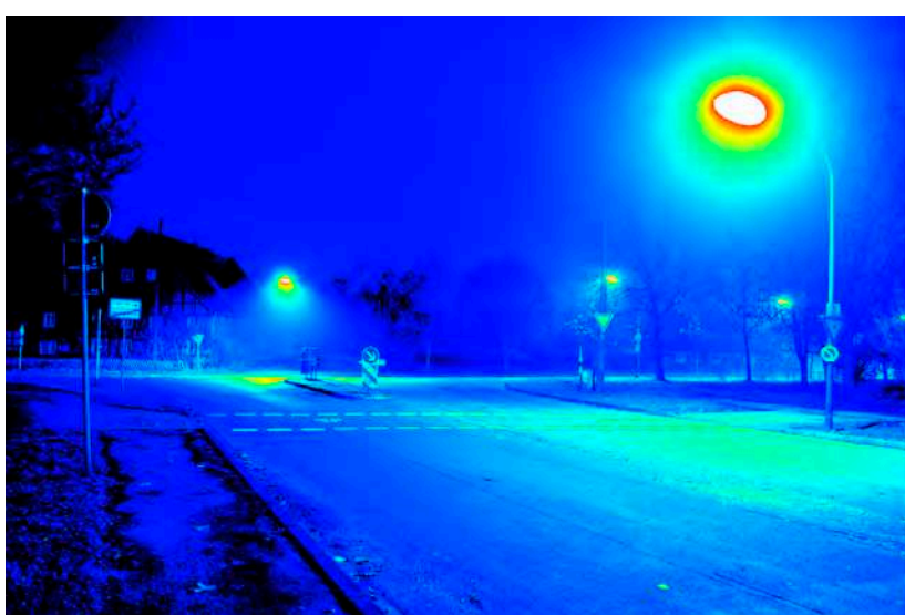
Leuchtdichteauswertung (cd/m 2 ). Logarithmisch skaliertes Falschfarbenbild.
