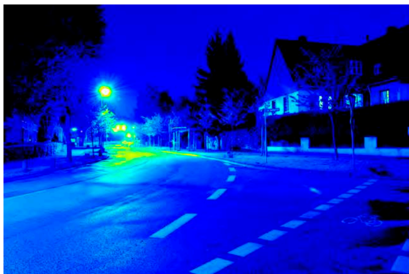
Leuchtdichteauswertung (cd/m 2 ). Logarithmisch skaliertes Falschfarbenbild.
