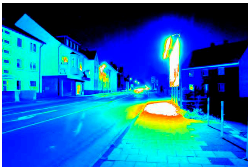
Leuchtdichteauswertung ( \text{cd}/\text{m}^2 ). Logarithmisch skaliertes Falschfarbenbild.
