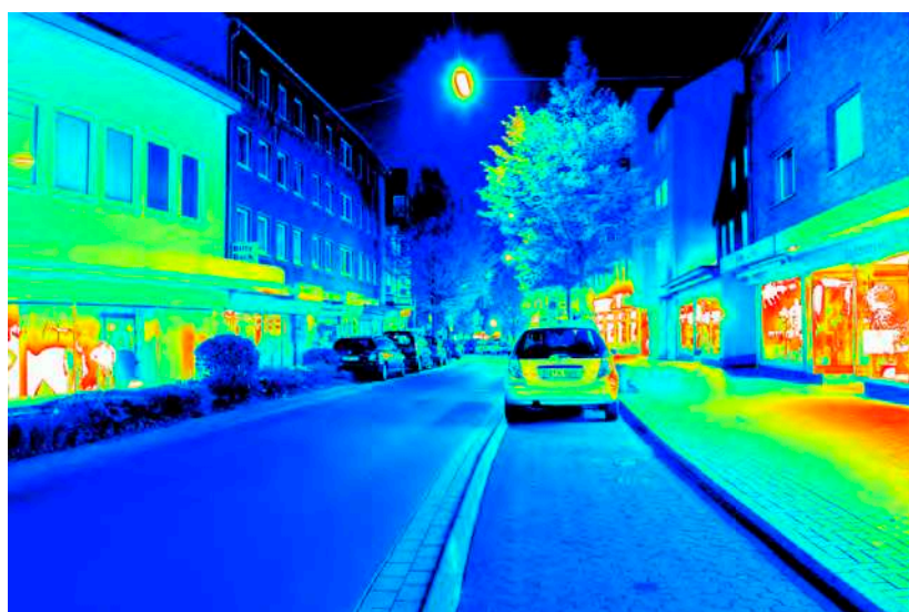
Leuchtdichteauswertung ( \text{cd}/\text{m}^2 ). Logarithmisch skaliertes Falschfarbenbild.
