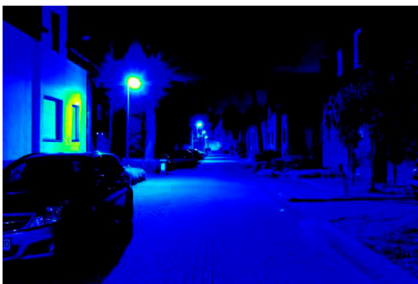
Leuchtdichteauswertung ( \text{cd}/\text{m}^2 ). Logarithmisch skaliertes Falschfarbenbild.
