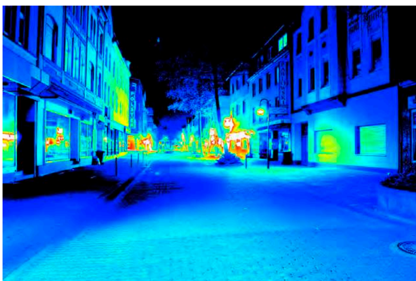
Leuchtdichteauswertung ( \text{cd/m}^2 ). Logarithmisch skaliertes Falschfarbenbild.
