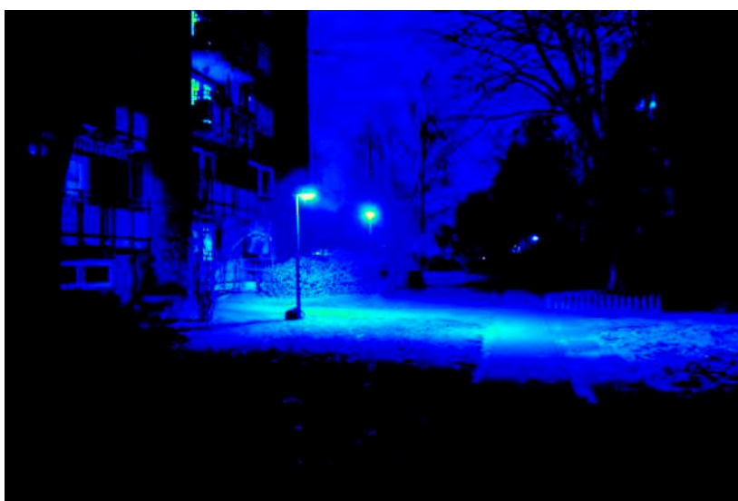
Leuchtdichteauswertung ( \text{cd}/\text{m}^2 ). Logarithmisch skaliertes Falschfarbenbild.
