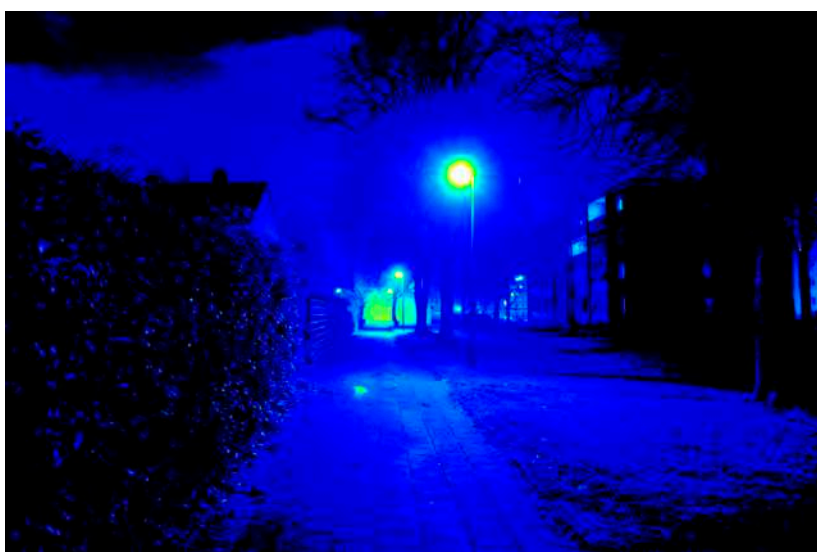
Leuchtdichteauswertung (cd/m 2 ). Logarithmisch skaliertes Falschfarbenbild.
