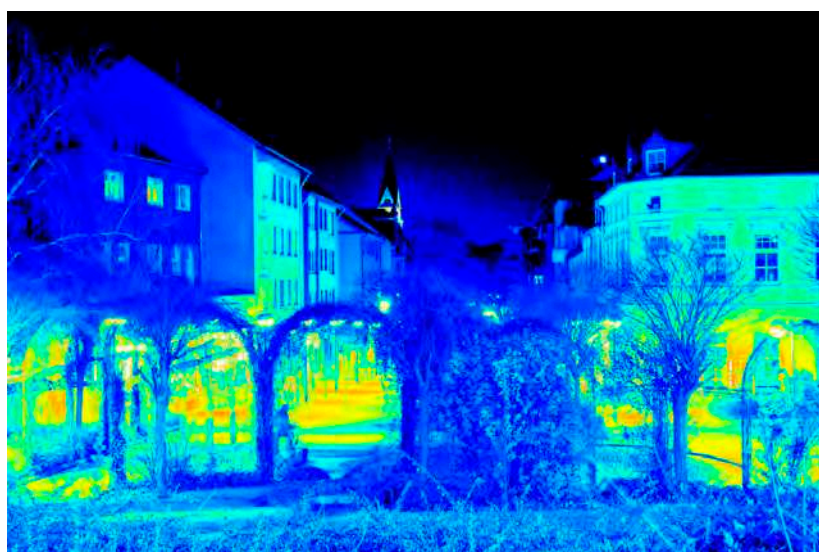
Leuchtdichteauswertung ( \text{cd}/\text{m}^2 ). Logarithmisch skaliertes Falschfarbenbild.
