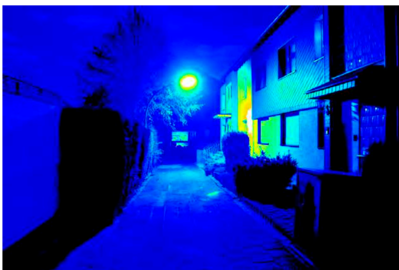
Leuchtdichteauswertung ( \text{cd}/\text{m}^2 ). Logarithmisch skaliertes Falschfarbenbild.
