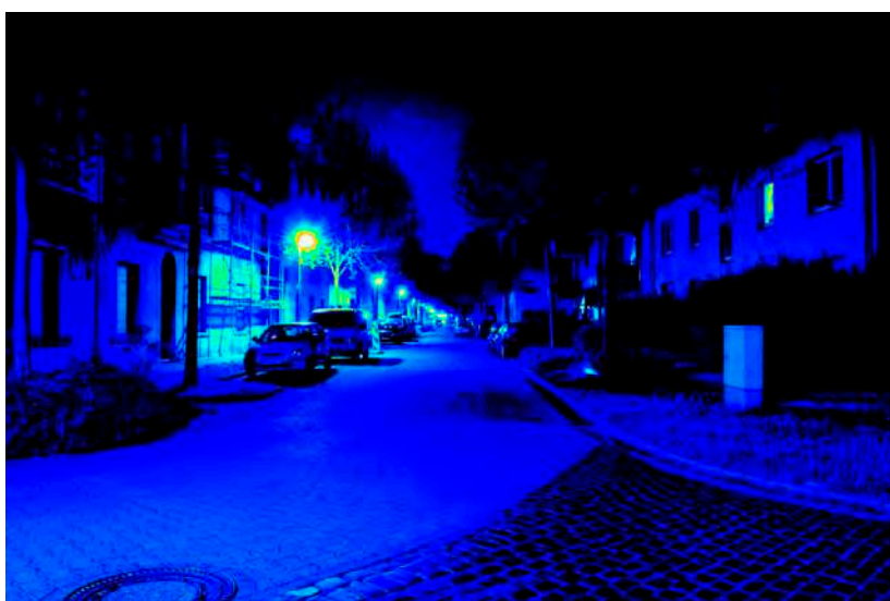
Leuchtdichteauswertung ( \text{cd/m}^2 ). Logarithmisch skaliertes Falschfarbenbild.
