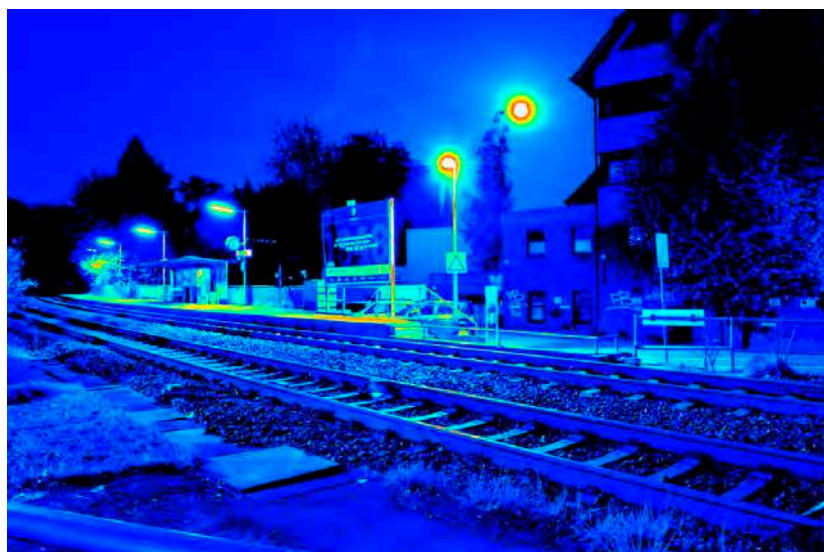
Leuchtdichteauswertung (cd/m 2 ). Logarithmisch skaliertes Falschfarbenbild.
