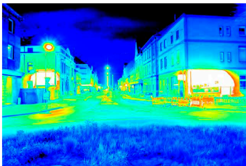
Leuchtdichteauswertung ( \text{cd}/\text{m}^2 ). Logarithmisch skaliertes Falschfarbenbild.
