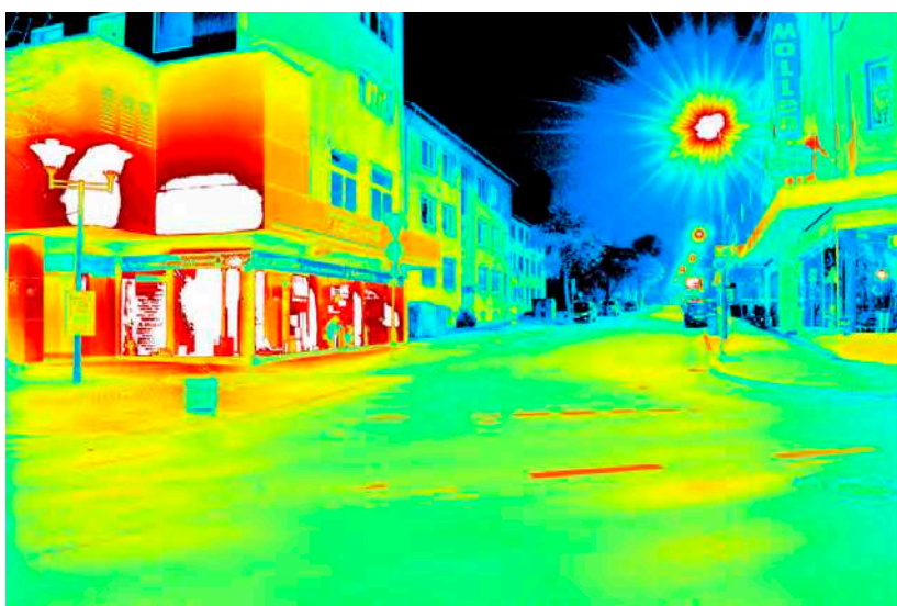
Leuchtdichteauswertung ( \text{cd}/\text{m}^2 ). Logarithmisch skaliertes Falschfarbenbild.
