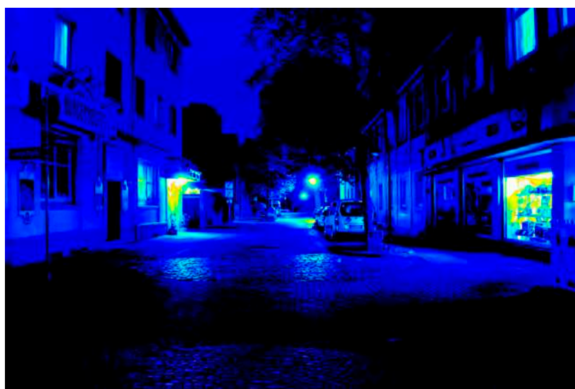
Leuchtdichteauswertung (cd/m 2 ). Logarithmisch skaliertes Falschfarbenbild.
