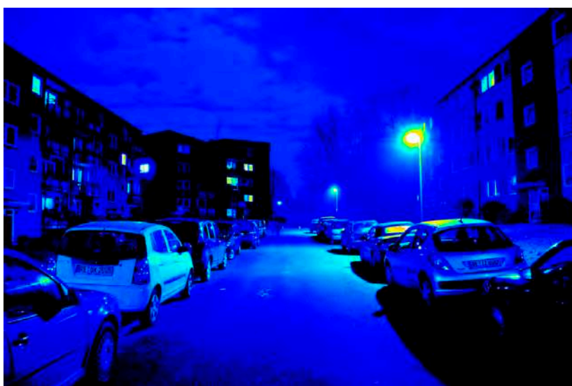
Leuchtdichteauswertung ( \text{cd}/\text{m}^2 ). Logarithmisch skaliertes Falschfarbenbild.
