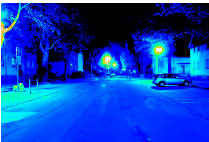
Leuchtdichteauswertung ( \text{cd}/\text{m}^2 ). Logarithmisch skaliertes Falschfarbenbild.
