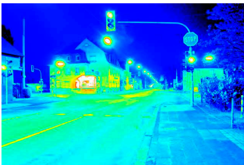
Leuchtdichteauswertung ( \text{cd/m}^2 ). Logarithmisch skaliertes Falschfarbenbild.
