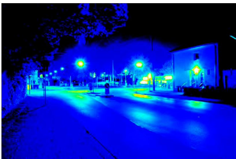
Leuchtdichteauswertung ( \text{cd}/\text{m}^2 ). Logarithmisch skaliertes Falschfarbenbild.
