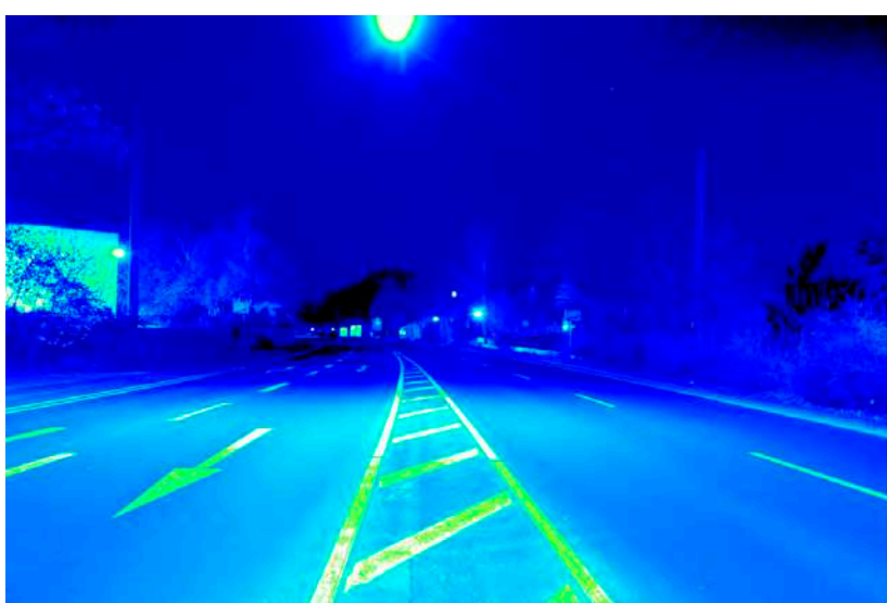
Leuchtdichteauswertung ( \text{cd}/\text{m}^2 ). Logarithmisch skaliertes Falschfarbenbild.
