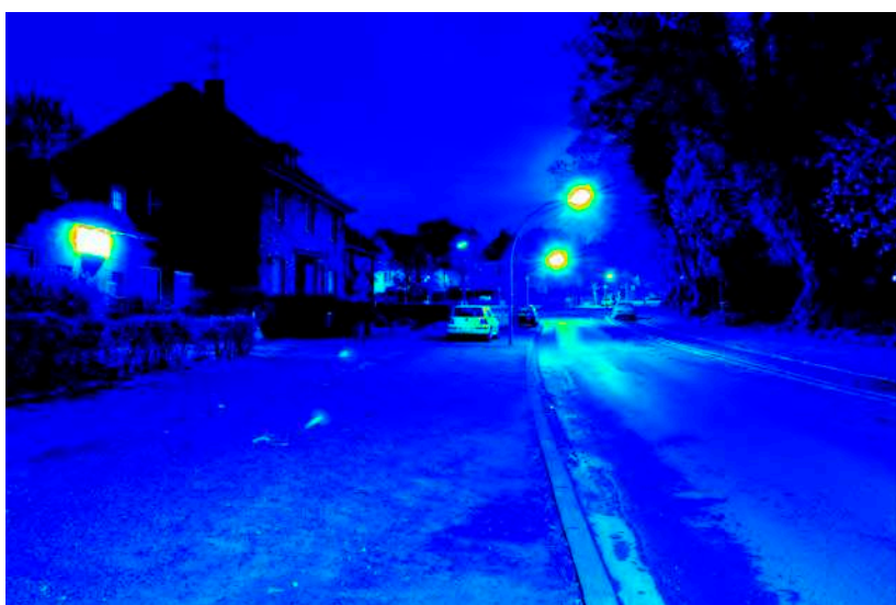
Leuchtdichteauswertung ( \text{cd}/\text{m}^2 ). Logarithmisch skaliertes Falschfarbenbild.
