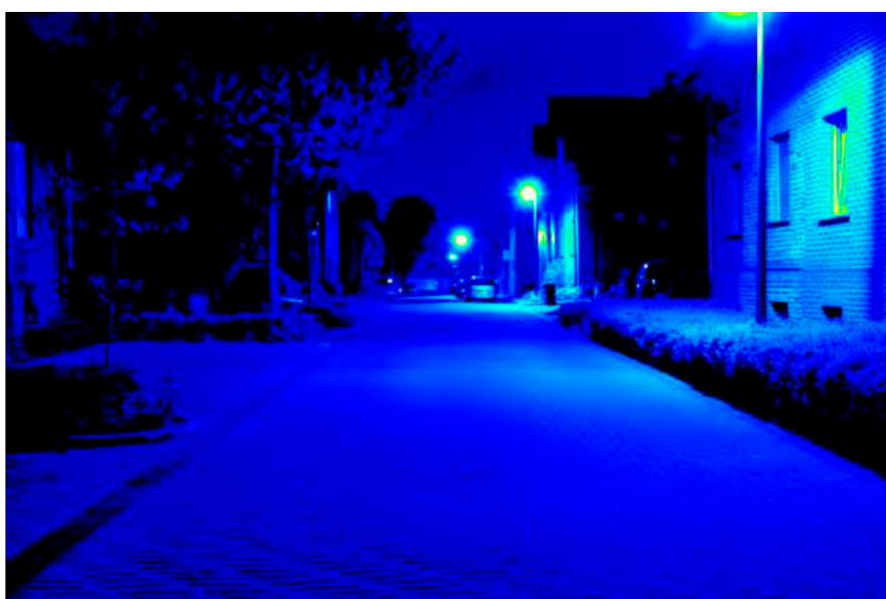
Leuchtdichteauswertung (cd/m 2 ). Logarithmisch skaliertes Falschfarbenbild.
