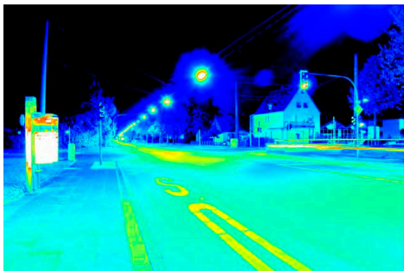
Leuchtdichteauswertung ( \text{cd}/\text{m}^2 ). Logarithmisch skaliertes Falschfarbenbild.
