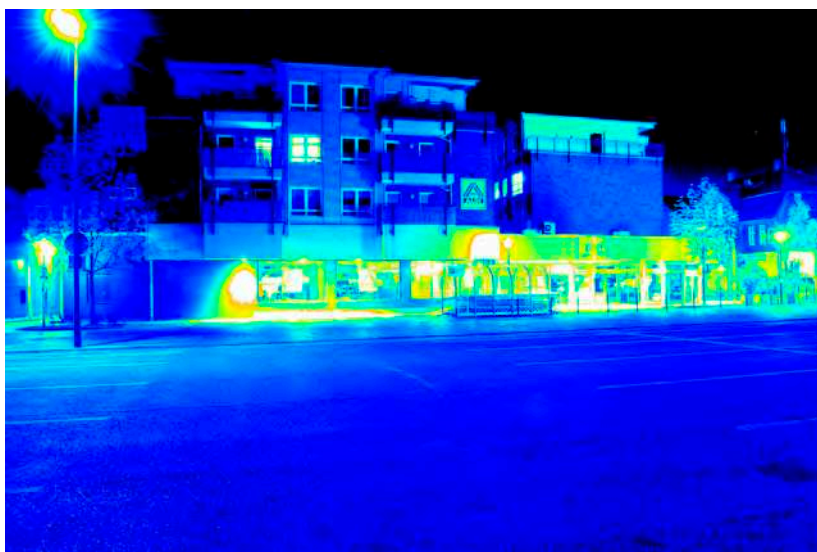
Leuchtdichteauswertung ( \text{cd/m}^2 ). Logarithmisch skaliertes Falschfarbenbild.
