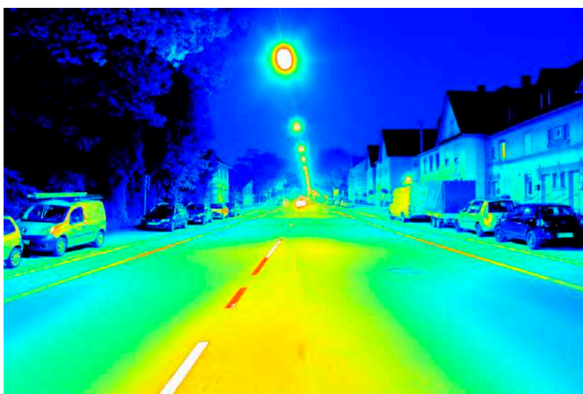
Leuchtdichteauswertung ( \text{cd/m}^2 ). Logarithmisch skaliertes Falschfarbenbild.
