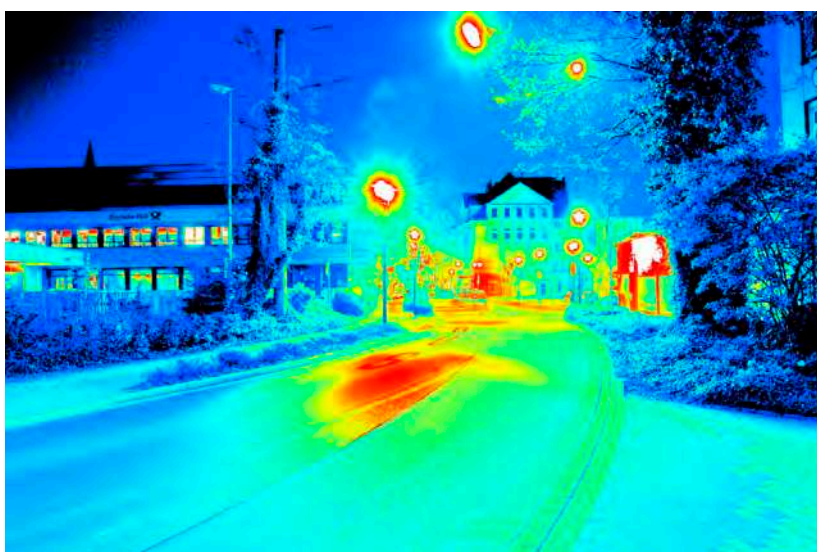
Leuchtdichteauswertung ( \text{cd}/\text{m}^2 ). Logarithmisch skaliertes Falschfarbenbild.
