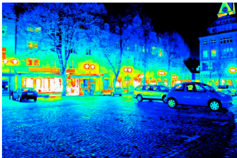
Leuchtdichteauswertung ( \text{cd}/\text{m}^2 ). Logarithmisch skaliertes Falschfarbenbild.
