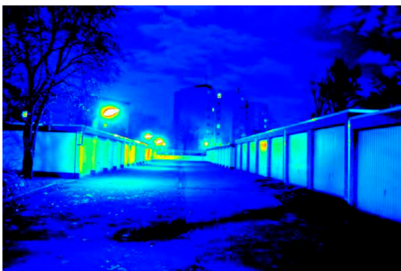
Leuchtdichteauswertung (cd/m 2 ). Logarithmisch skaliertes Falschfarbenbild.
