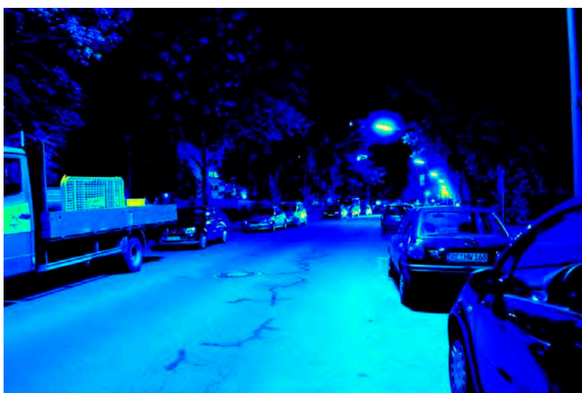
Leuchtdichteauswertung ( \text{cd}/\text{m}^2 ). Logarithmisch skaliertes Falschfarbenbild.
