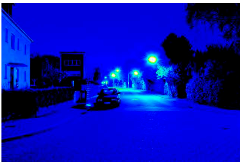
Leuchtdichteauswertung ( \text{cd}/\text{m}^2 ). Logarithmisch skaliertes Falschfarbenbild.
