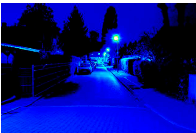
Leuchtdichteauswertung (cd/m 2 ). Logarithmisch skaliertes Falschfarbenbild.
