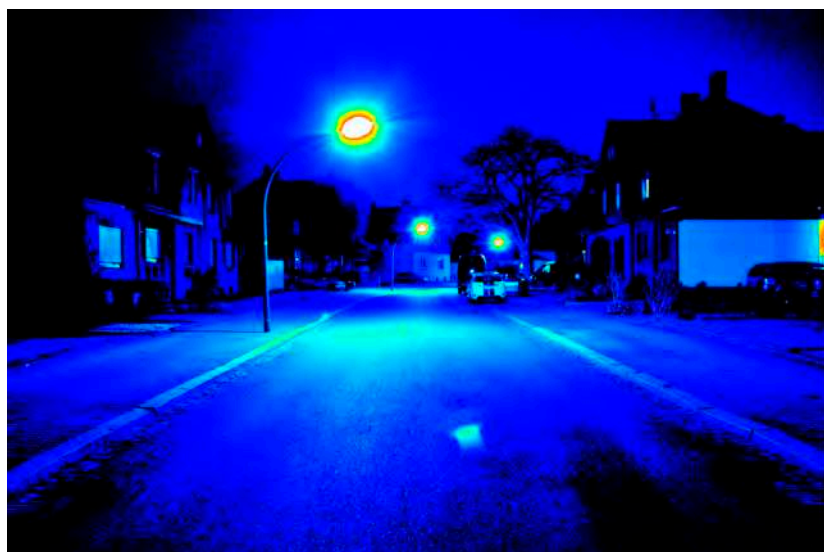
Leuchtdichteauswertung ( \text{cd}/\text{m}^2 ). Logarithmisch skaliertes Falschfarbenbild.
