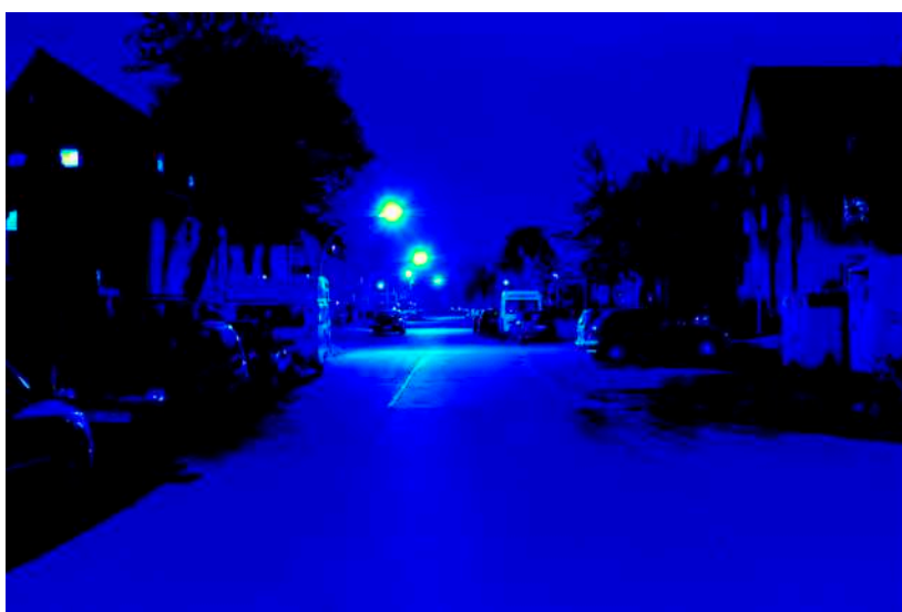
Leuchtdichteauswertung ( \text{cd}/\text{m}^2 ). Logarithmisch skaliertes Falschfarbenbild.
