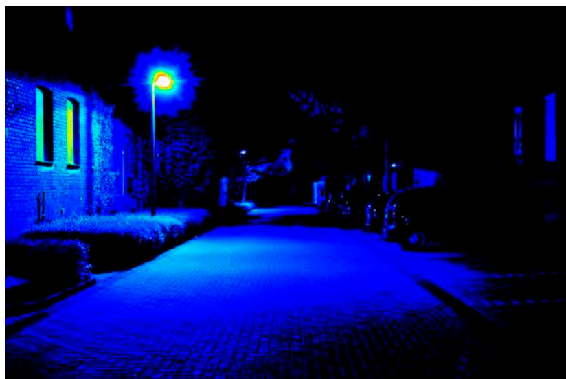
Leuchtdichteauswertung ( \text{cd}/\text{m}^2 ). Logarithmisch skaliertes Falschfarbenbild.
