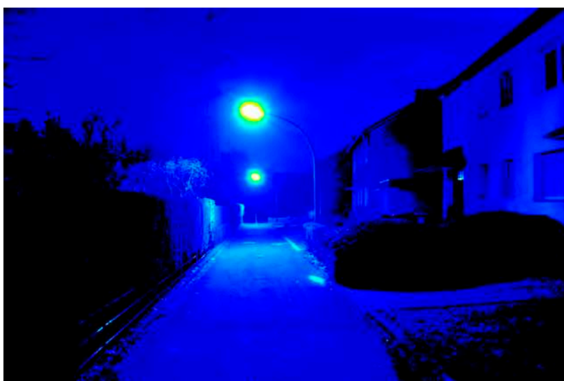
Leuchtdichteauswertung ( \text{cd}/\text{m}^2 ). Logarithmisch skaliertes Falschfarbenbild.
