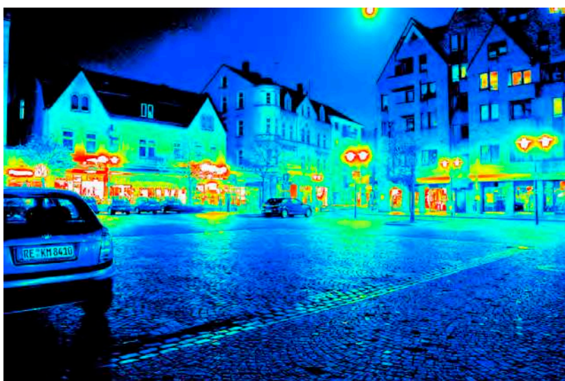
Leuchtdichteauswertung ( \text{cd}/\text{m}^2 ). Logarithmisch skaliertes Falschfarbenbild.
