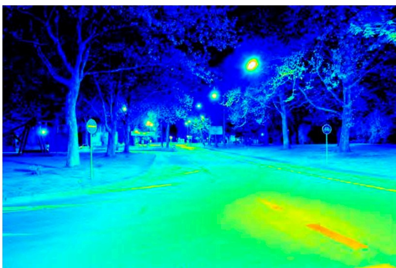
Leuchtdichteauswertung (cd/m 2 ). Logarithmisch skaliertes Falschfarbenbild.
