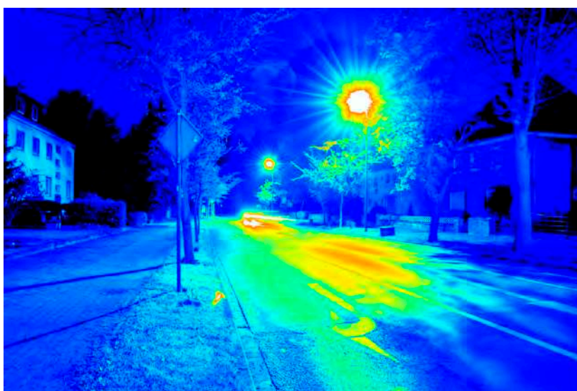
Leuchtdichteauswertung ( \text{cd}/\text{m}^2 ). Logarithmisch skaliertes Falschfarbenbild.
