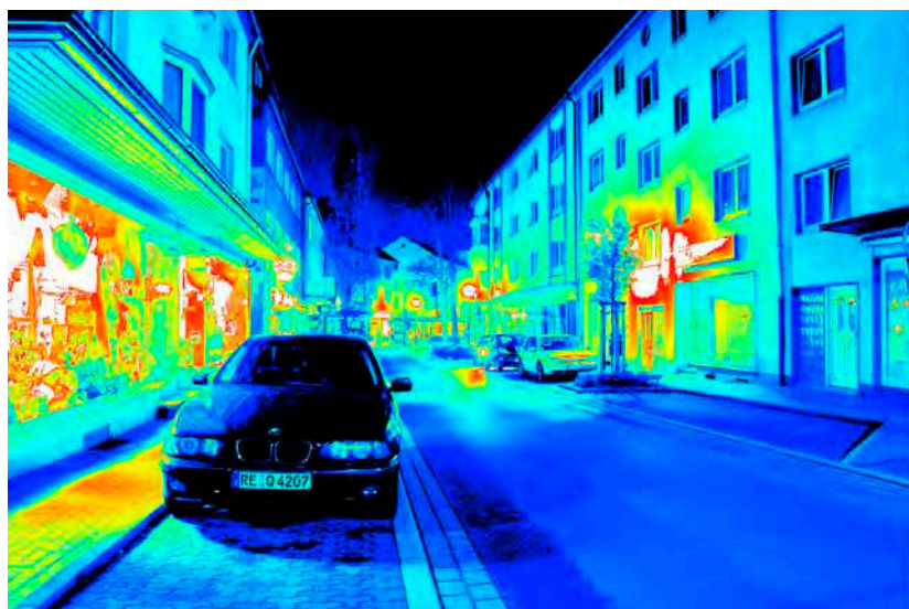
Leuchtdichteauswertung ( \text{cd}/\text{m}^2 ). Logarithmisch skaliertes Falschfarbenbild.
