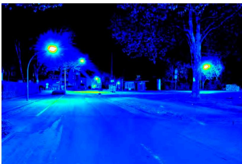
Leuchtdichteauswertung ( \text{cd}/\text{m}^2 ). Logarithmisch skaliertes Falschfarbenbild.
