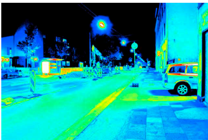
Leuchtdichteauswertung ( \text{cd}/\text{m}^2 ). Logarithmisch skaliertes Falschfarbenbild.
