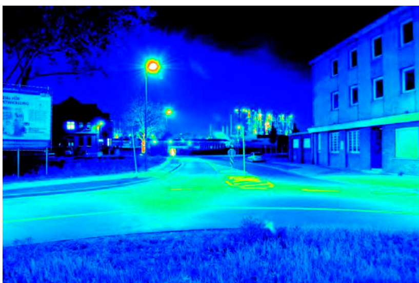
Leuchtdichteauswertung ( \text{cd}/\text{m}^2 ). Logarithmisch skaliertes Falschfarbenbild.
