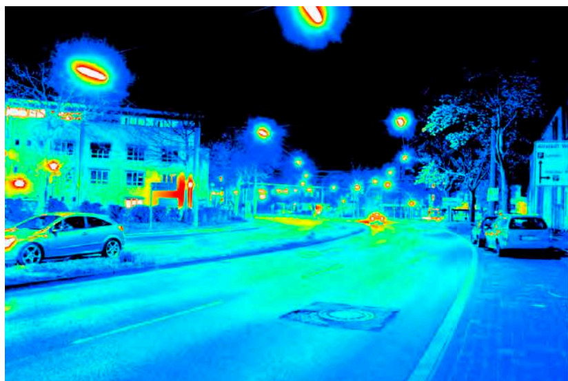
Leuchtdichteauswertung (cd/m 2 ). Logarithmisch skaliertes Falschfarbenbild.
