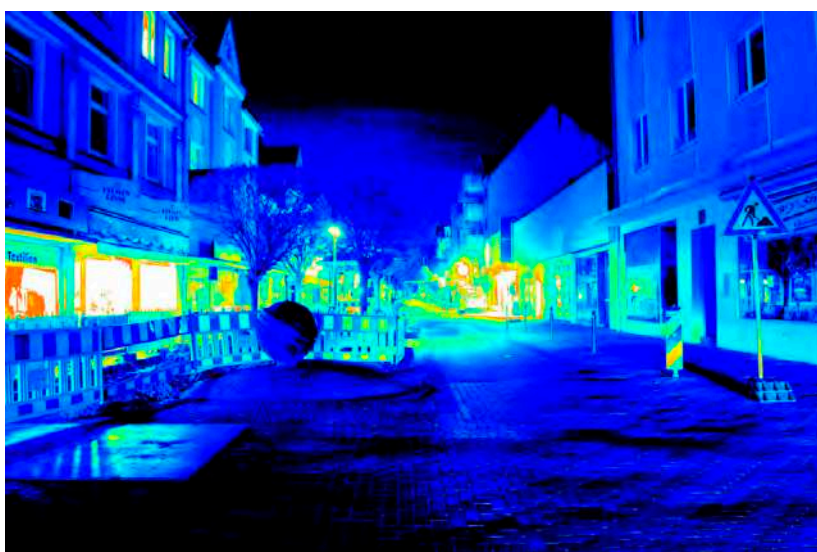
Leuchtdichteauswertung ( \text{cd}/\text{m}^2 ). Logarithmisch skaliertes Falschfarbenbild.
