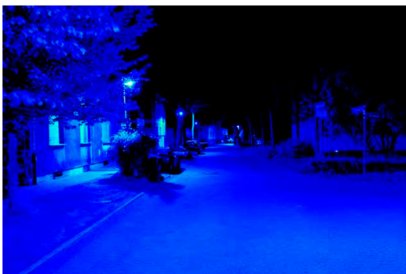
Leuchtdichteauswertung ( \text{cd}/\text{m}^2 ). Logarithmisch skaliertes Falschfarbenbild.
