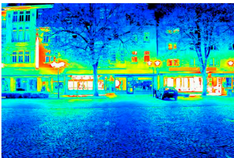
Leuchtdichteauswertung ( \text{cd/m}^2 ). Logarithmisch skaliertes Falschfarbenbild.
