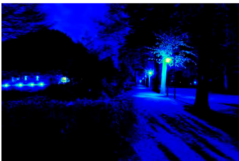
Leuchtdichteauswertung (cd/m 2 ). Logarithmisch skaliertes Falschfarbenbild.
