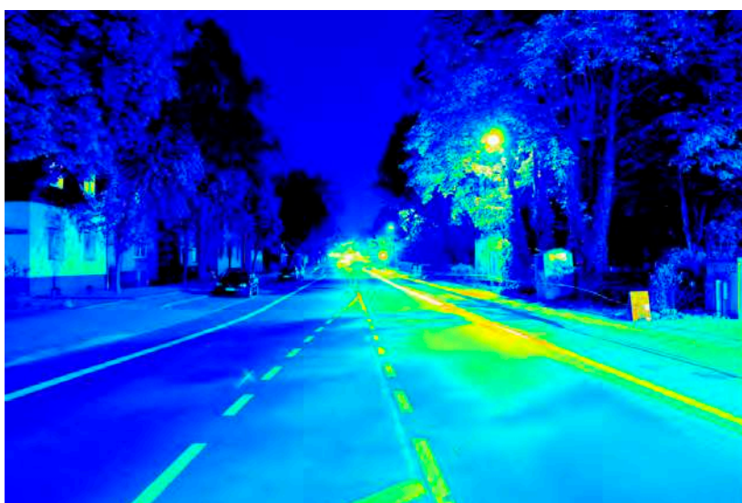
Leuchtdichteauswertung (cd/m 2 ). Logarithmisch skaliertes Falschfarbenbild.
