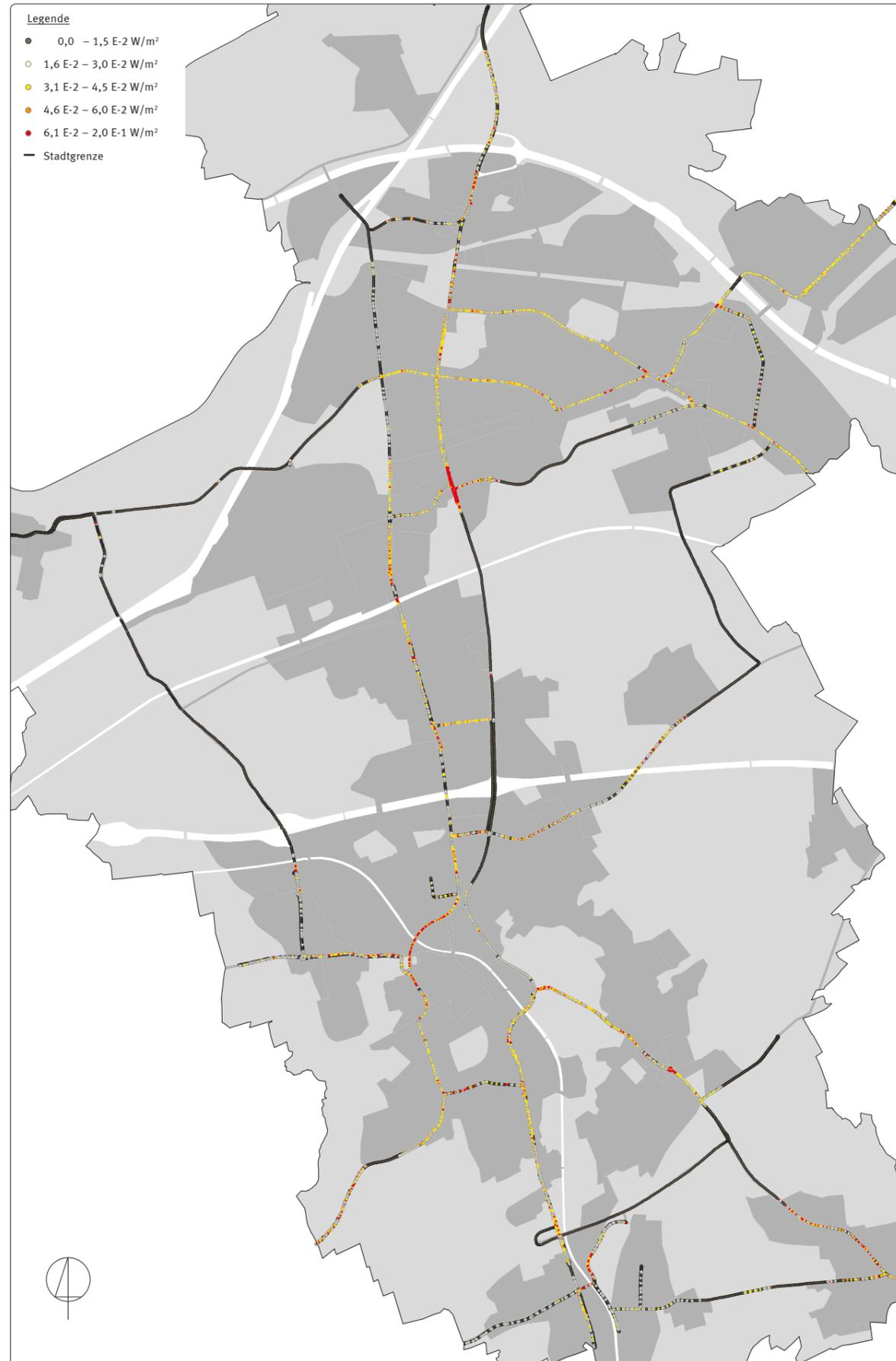
3.44 // Messung der Strahlungsleistung durch unterfahren der Leuchtstellen des Vorbehaltsnetzes: 22.00-23.30 Uhr; 29.09. + 06.10.2011
