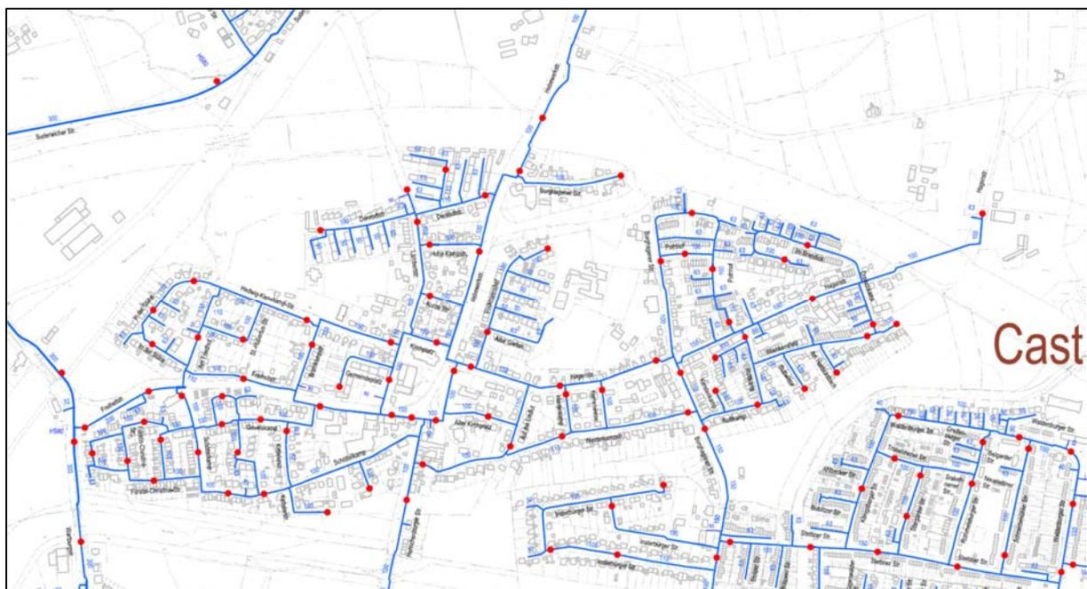
**Abbildung 37: Ausschnitt Hydranten-Plan in Castrop-Rauxel (rote Punkte: Hydranten)**
